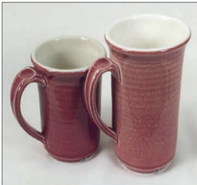
شکل ۲۵- لعاب با دمای پخت نامناسب
