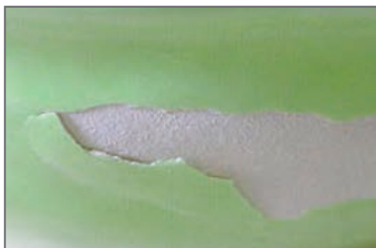
شکل ۲۷- عیب پوسته شدن لعاب
