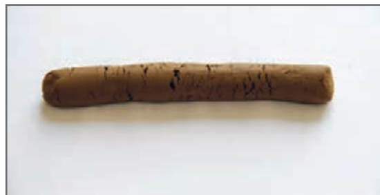
گل با شکل‌پذیری نامناسب - دارای ترک
