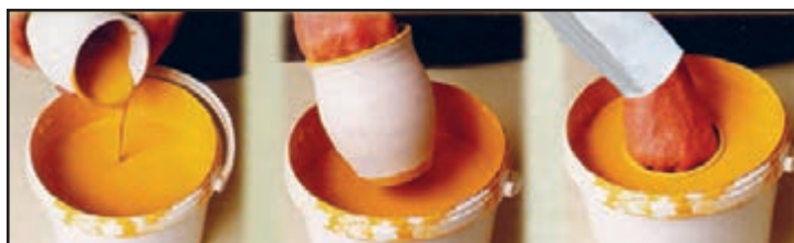
شکل ۱۹- لعاب‌زنی دستی و کارگاهی
