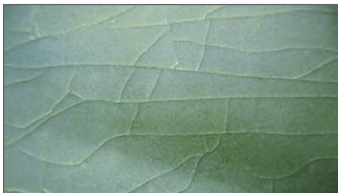
شکل ۲۶- عیب ترک برداشتن لعاب
