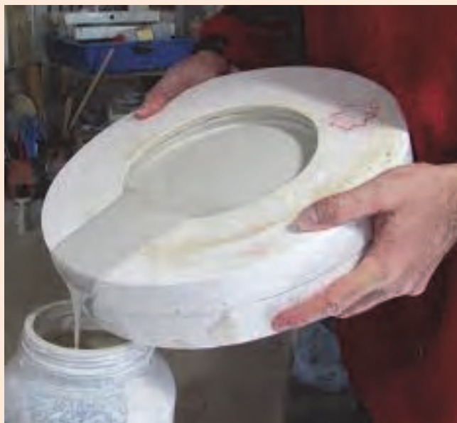
شکل ۱۵- تخلیه قالب
