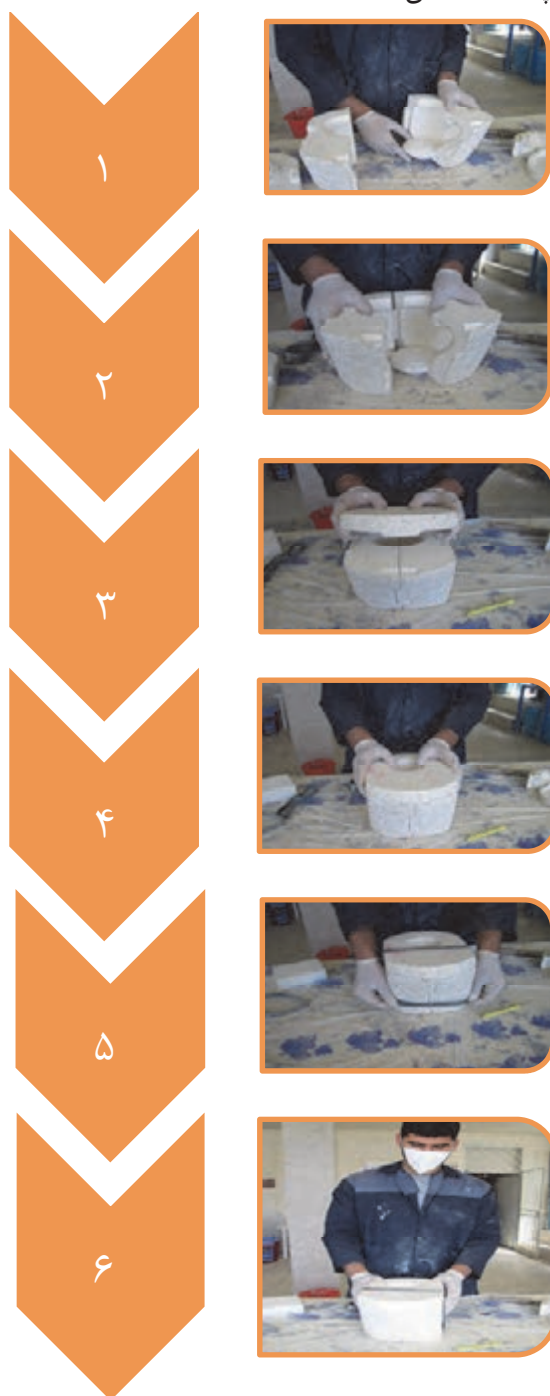
شکل ۷- مراحل بستن قالب
