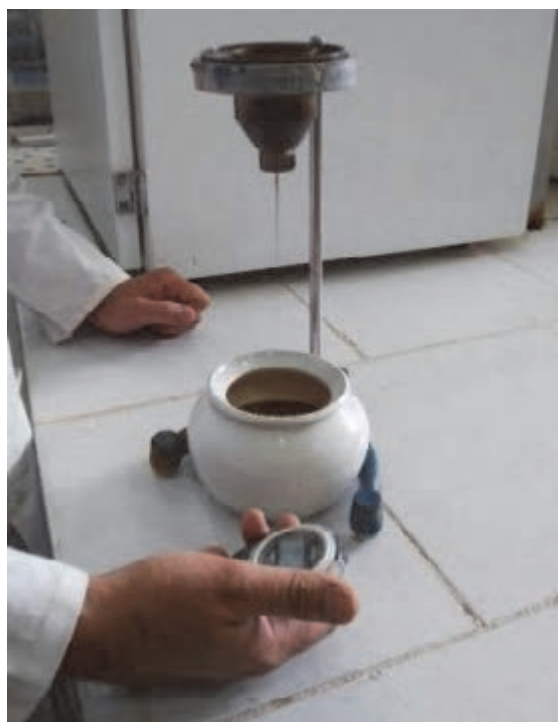
شکل ۱۶- اندازه گیری گرانیروی دوغاب
