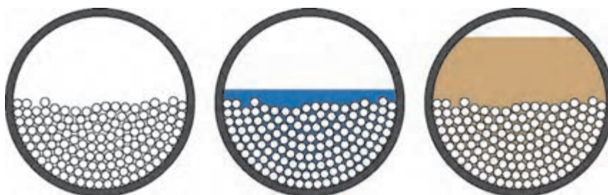
شکل ۱۷- محتویات فضای داخلی بال‌میل
