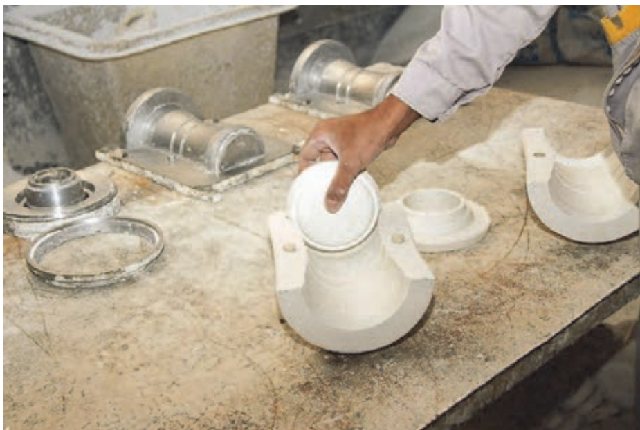
شکل ۵- یک قالب چند تکه
