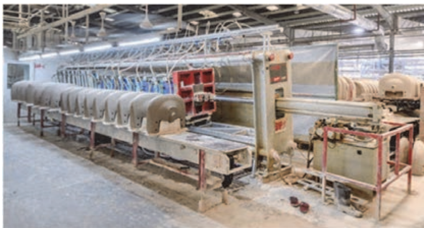
شکل ۶- ریخته‌گری دوغابی با فشار پایین
