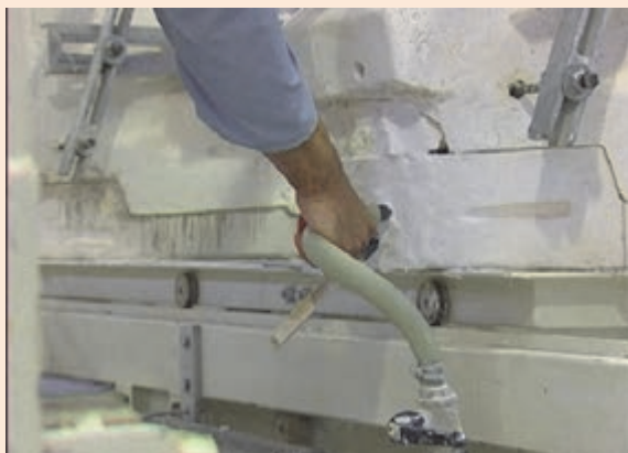
شکل ۲۵- مجرای زیر قالب جهت تخلیه دوغاب
