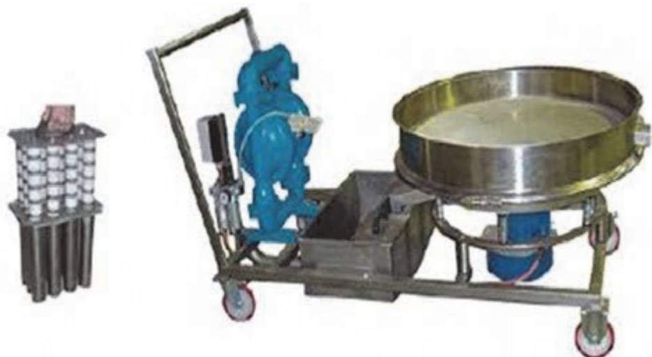
شکل ۲۶- گاری الک، آهن‌ربا و پمپ
