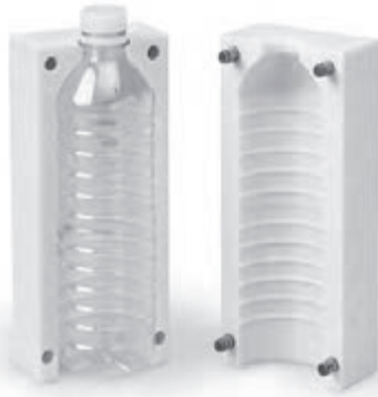
شکل ۲- قالب مورد استفاده در تولید بطری پلاستیکی
