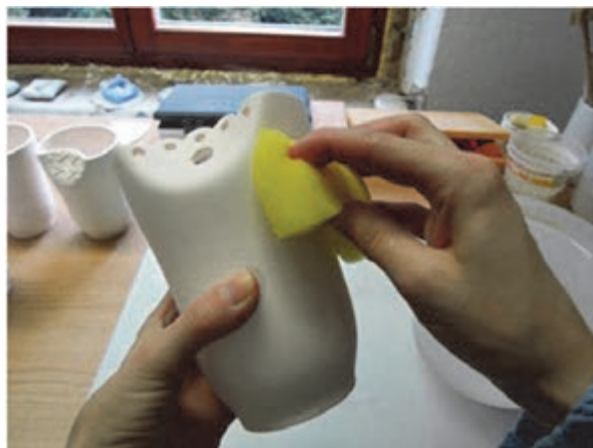
شکل ۳۱- پرداخت بدنه‌های ریخته‌گری دوغابی
