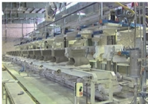
شکل ۳۷- بیرون آوردن بدنه از قالب
