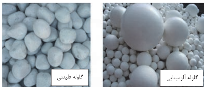
شکل ۱۸- گلوله‌های آلومینایی و فلینتی بال‌میل
