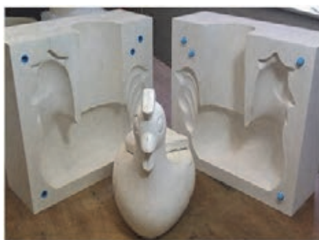
شکل ۶- پین‌های انواع قالب
