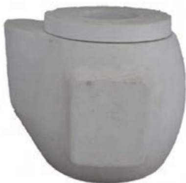
شکل ۲۷- قالب قوری درزبندی شده
