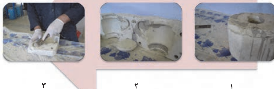
شکل ۵- بررسی قالب و جدا کردن لایه‌های دوغاب خشک شده از آن
