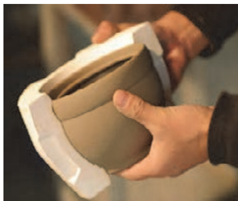
الف- خارج کردن بدنه ریخته‌گری شده
