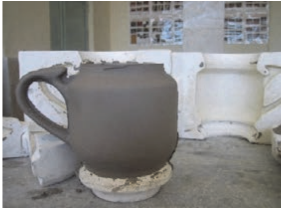
شکل ۴۲- شکل‌دهی جداگانه لوله و بدنه قوری
