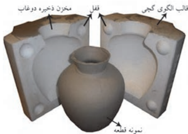
شکل ۱۵- قطعه ریخته گری شده در قالب الگو
