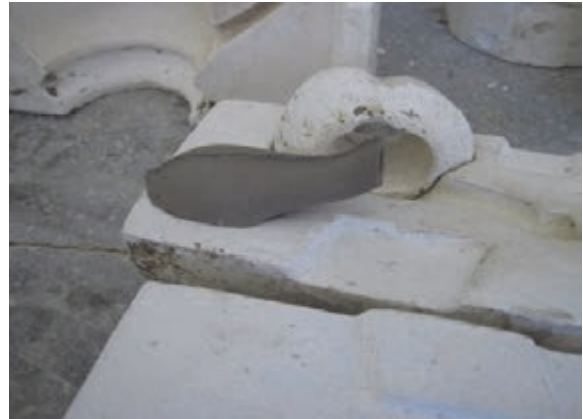
شکل ۴۲- شکل‌دهی جداگانه لوله و بدنه قوری
