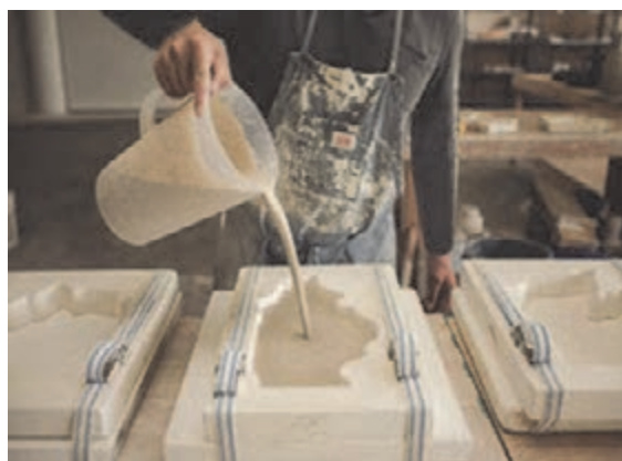
الف) ریخته‌گری دوغابی به روش دستی
