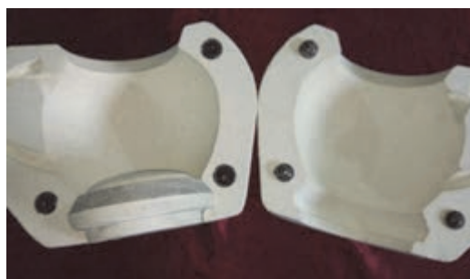
شکل ۲۴- الگوی گچی با زبانه های پلاستیکی
