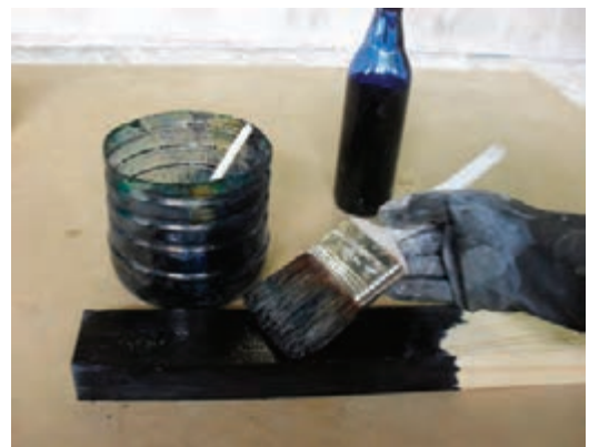
شکل ۵۴-۱۲- زدن آستری آب (روی سطح کار).
