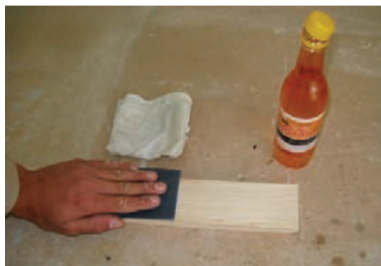
شکل ۱۸-۱۳- پرزگیری روی سطح چوب نراد با استفاده از کهنه نمدار، الکل و پوست آب شماره ۴۰۰.
