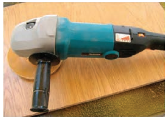
شکل ۱۰-۵- دستگاه سنباده گرد یا دیسکی.
