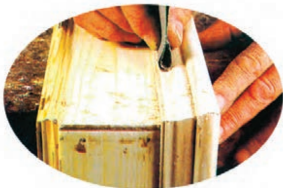
شکل ۲۸-۴ - سنباده‌کاری (روی سطوح محدب و مقعر).
