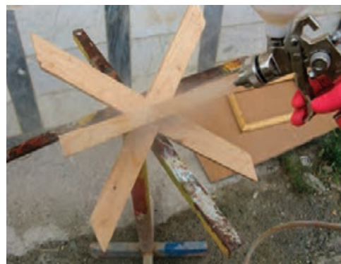
شکل ۱۴-۱۲- زدن کیلر به کار با پیستوله.
