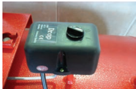
شکل ۹-۷- جعبه کلید قطع و وصل جریان برق.
