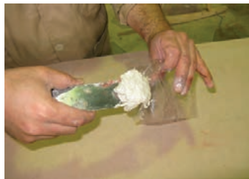
شکل ۳۱۳-۶- قراردادن بتونه سربشی داخل پلاستیک.
