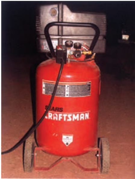
شکل ۷-۳- کمپرسور با مخزن عمودی.
