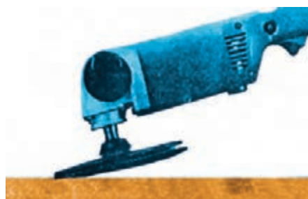
شکل ۳۳-۵- فشار بیش از حد به یک نقطه باعث فرای سطح کار می‌شود.
