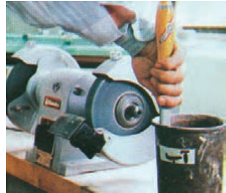
شکل ۳۰-۳۳- لبه‌ی تیغه را مرتب با آب فندک کنید تا نسوزد.
