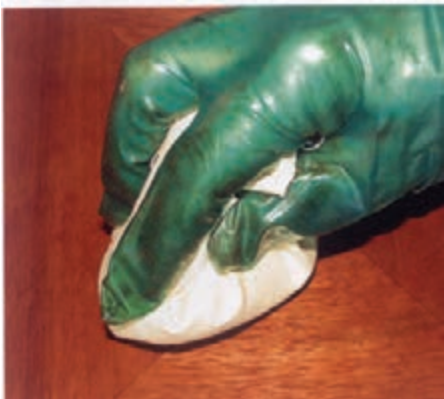
شکل ۵-۸- زدن سیلر با کهنه رنگ‌کاری.
