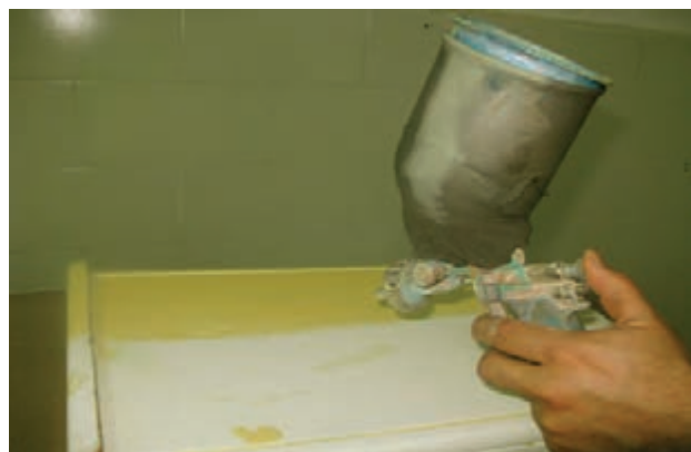
شکل ۶-۱۲- چهارپایه (رنگ شده با رنگ نیتروسولولوزی).
