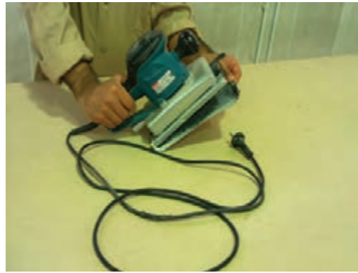
شکل ۱۸-۵- نمونه تعویض ورق سنباده لرزان.
