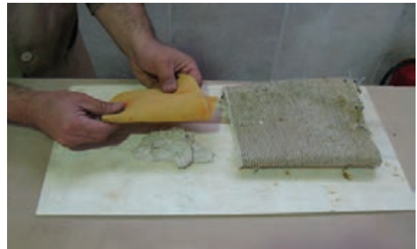
شکل ۴۵-۶- پوشش روی بتونه باقی‌مانده.
