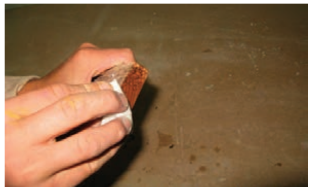
شکل ۶۴-۱۳- زدن آب به کله چوب.
