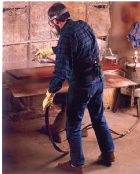
شکل ۱۲-۲۲- پاشیدن پلی استر ایستاده به سطح کار.
