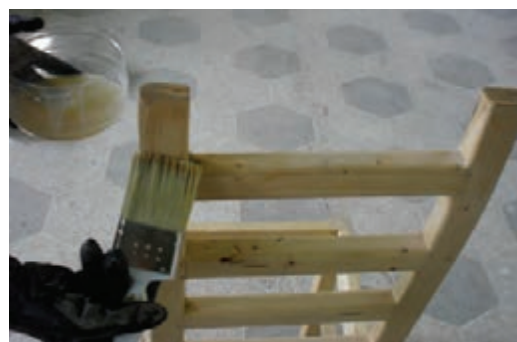
شکل ۱۳-۱۲- زدن کیلر به صندلی با قلم‌مو.
