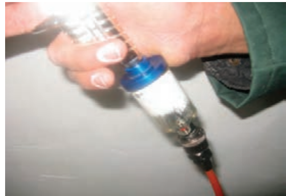
شکل ۲۶-۸- محل اتصال شیلنگ باد به پیستوله.
