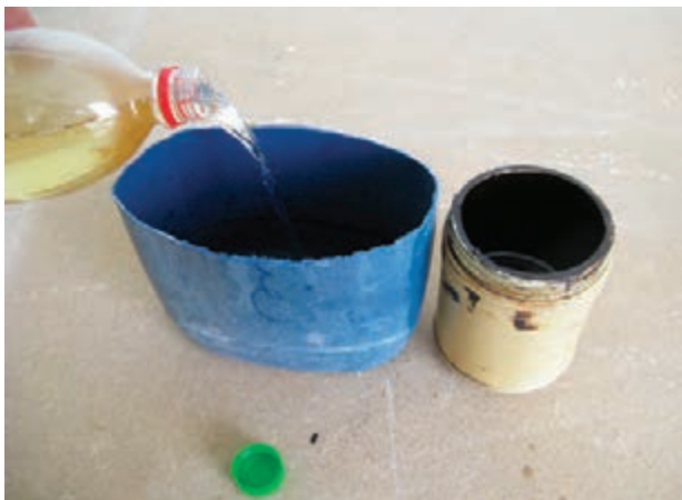
شکل ۴۵-۱۲- اضافه کردن نفت به آستری قیری.
