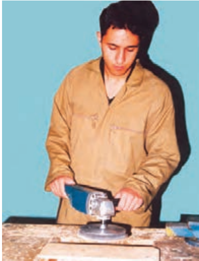
شکل ۵-۳۱- فشار یکنواخت به سطح کار.
