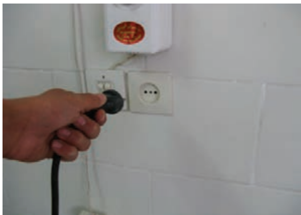
شکل ۲۵-۱۳- قطع کردن برق دستگاه سنباده لرزان.
