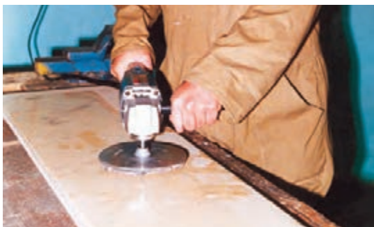
شکل ۲۲-۵- دستگاه سنباده گرد یا دیسکی.
