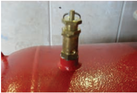
شکل ۱۰-۷- سوپاپ کمپرسور برای فروغ هوای اضافی.
