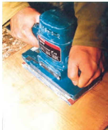
شکل ۵-۴۲- حرکت یکنواخت ماشین سنباده لرزان روی سطح کار.
