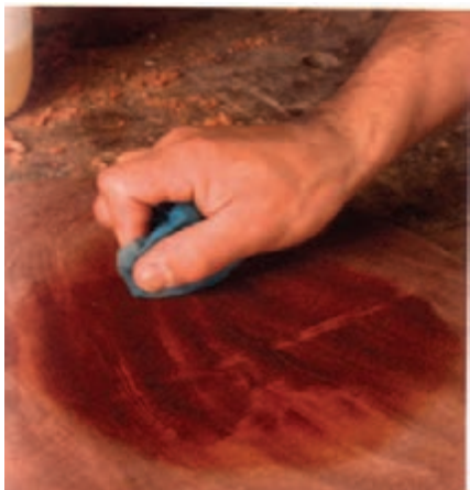
شکل ۷۳-۱۲- زدن لاک و الکل با کهنه (رنگ‌کاری).
