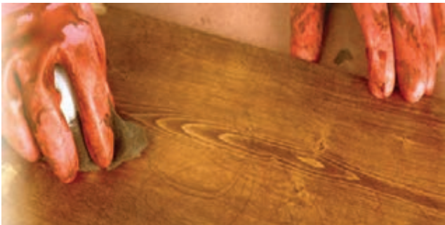
شکل ۴-۸- زدن آستری هم‌رنگی با پارچه رنگ‌کاری.
