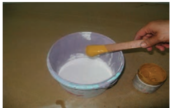
شکل ۵۵-۱۳- اضافه کردن جوهر پلاستیک برای تغییر رنگ پلاستیکی.
