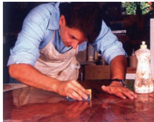
شکل ۱۲-۲۳- سنباده‌کاری سطح پلی استر فورده.
