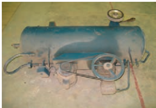
شکل ۱۱-۷- هیچ‌گاه کمپرسور را به پهلو نهبانید.
