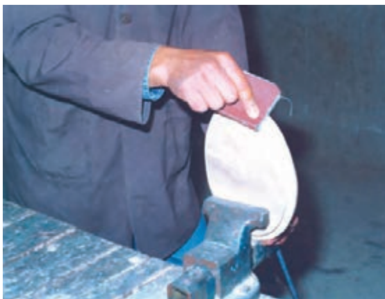
شکل ۲۲-۴- عده استفاده از چوب کمکی.
