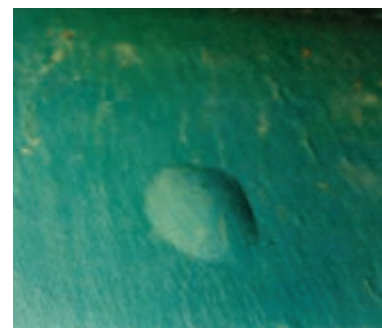
شکل ۸-۴۴- تاول زدگی سطح کار بعد از رنگ.
