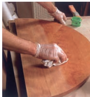
شکل ۳-۳۸- استفاده از پارچه نم‌دار در لیسه‌کاری.
