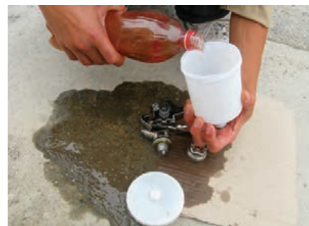
شکل ۷-۹- هنگام شستشوی پیستوله رنگ‌کاری کاملاً قطعات آنرا با زهموده و تمیز کنید.
