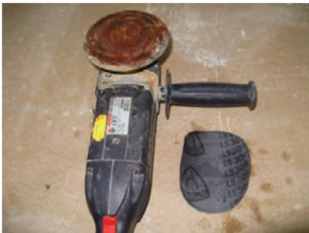
شکل ۲۲-۱۳- زدن چسب فوری به سنباده و صفحه ماشین پوست گرد.
