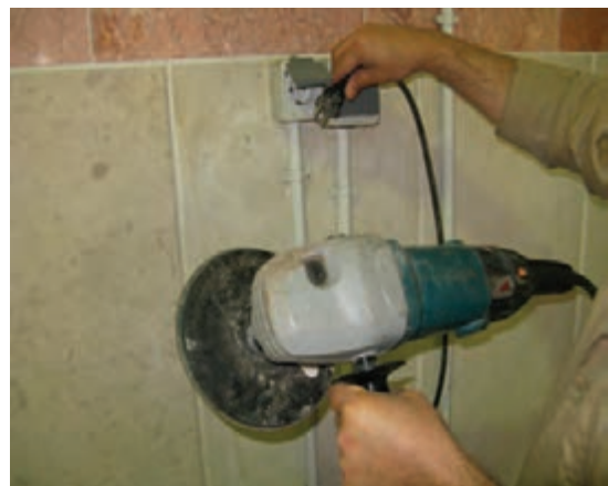
شکل ۲۰-۱۳- کشیدن دوشافه ماشین پوست گرد از پریش.
