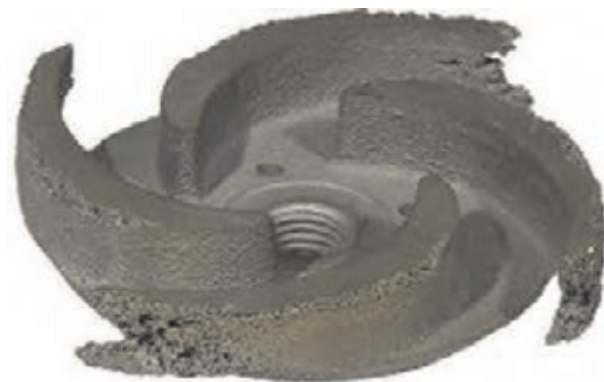
شکل ۱۹-۳- آسیب‌دیدگی پروانه پمپ در اثر پدیده کاویتاسیون
