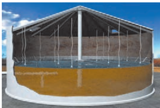
شکل ۱۸-۴- مخازن سقف شناور درونی
