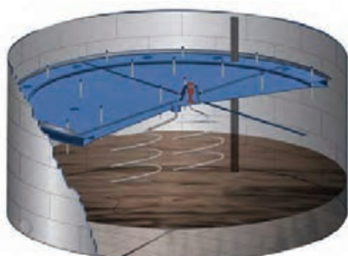
شکل ۴-۱۷- مخازن سقف شناور بیرونی
