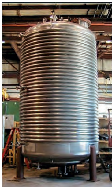
شکل ۵-۴- راکتور ناپیوسته صنعتی با سامانه گرمایی
