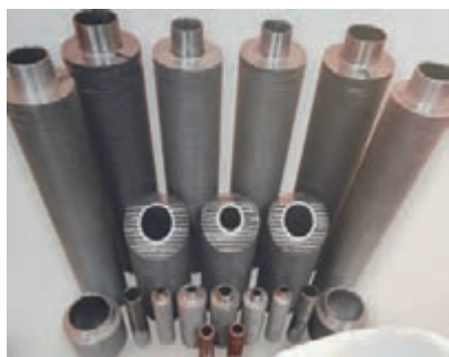
شکل ۵-۲- لوله‌های پره‌دار استفاده شده در مبدل‌ها با سطوح پره‌دار
