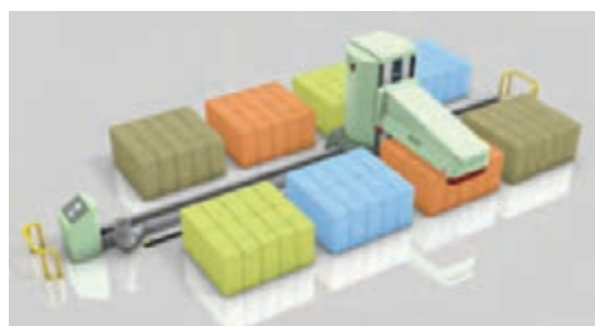
شکل ۳۲- چیدمان ۸ قسمتی عدل‌ها
