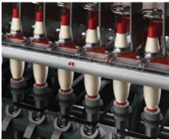
شکل ۳- فاصله دو دوک متوالی در دستگاه رینگ
