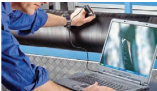
شکل ۲۲- ابزارهای مشاهده عیوب نوار اره‌ای (وایر) کارد
