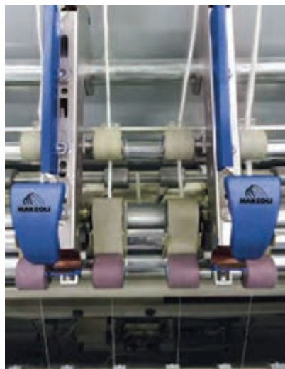
شکل ۹- تصویر واقعی سیستم کششی در رینگ
