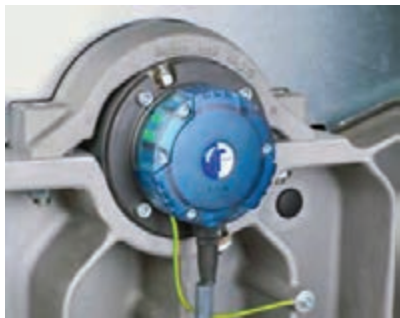
شکل ۱۷- سنسور تشخیص ناخالصی و تنظیمات
