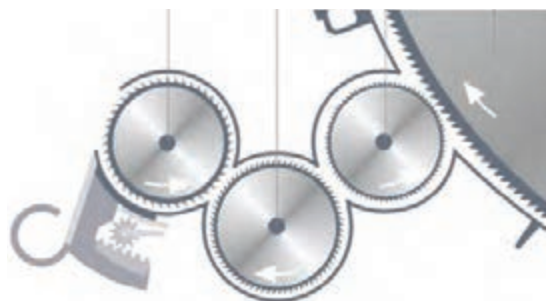
شکل ۷- سیستم Web Feed سه سیلندر
