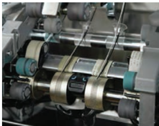
شکل ۱۶- یک واحد غلتک مشبک کشش رینگ (کامپکت)
