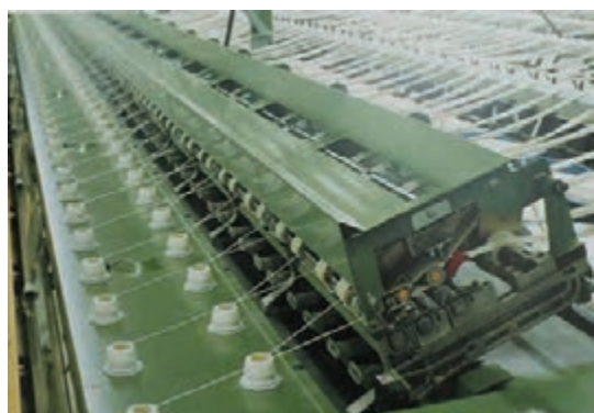
شکل ۳۳- خروج نیمچه نخ از منطقه کشش
