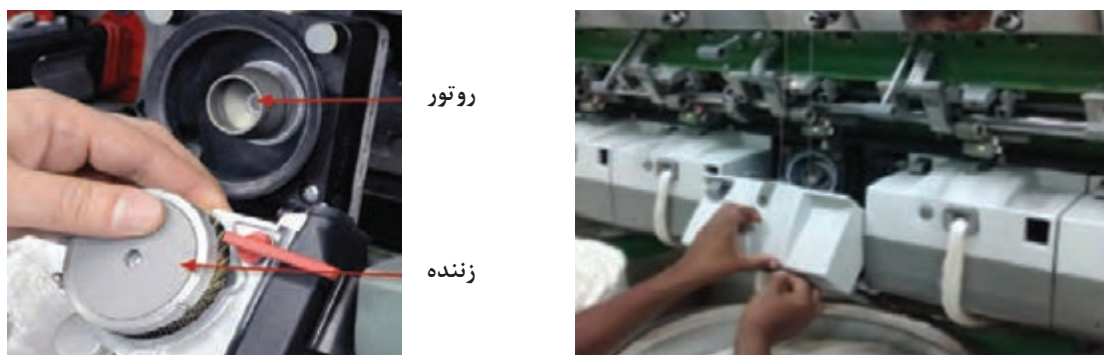
شکل ۶- پیوند نخ در داخل روتور
