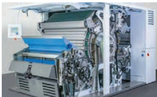
شکل ۲- نمای ماشین کارد
