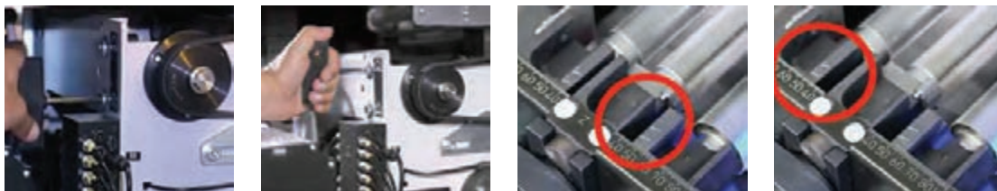
شکل ۹- تنظیم فاصله نواحی کشش بین غلتک‌ها
