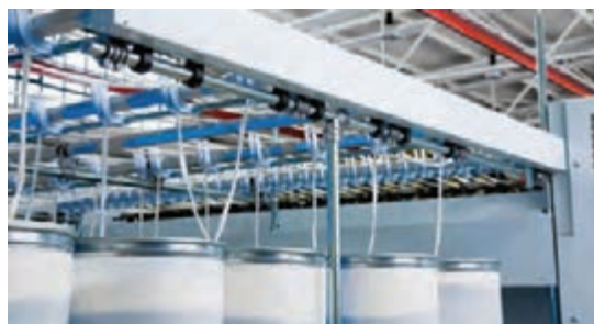
شکل ۲۱- نمای قفسه دستگاه فلایر
