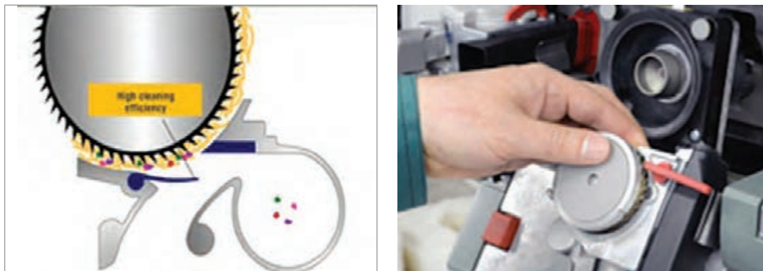
شکل ۱۱- نمایی از سیستم تغذیه زنده‌ای در ماشین چرخانه‌ای
