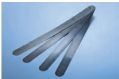
شکل ۱۸- دسته فیلر برای گیج‌گذاری ماشین کارد
