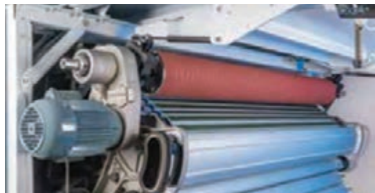
شکل ۳۶- دستگاه سنگ زدن فلت های کلاhek
