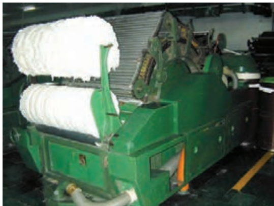
شکل ۴- تغذیه کارد با بالش
