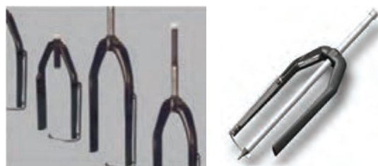
شکل ۴۰- فلایر یا پروانه
