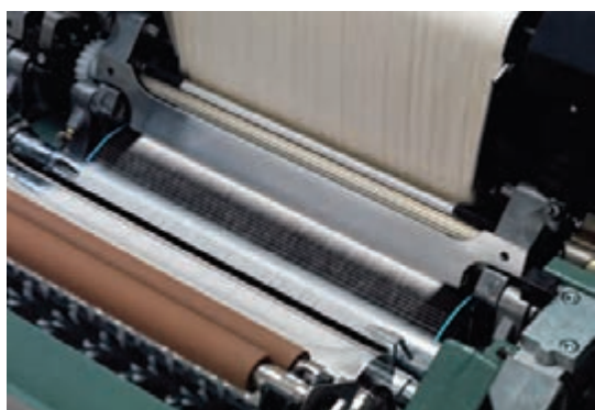
شکل ۳۱- یک واحد چشمه از یک ماشین شانه‌زنی و اجزای آن
