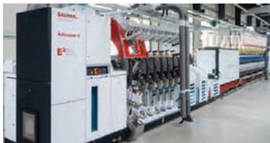
شکل ۳۶- تمیزکننده سیار با دمنده‌ها و مکندۀهای روی آن
