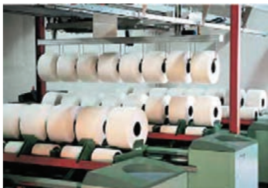
شکل ۲۸- نحوه قرارگیری بالشچه‌ها روی دستگاه شانه
