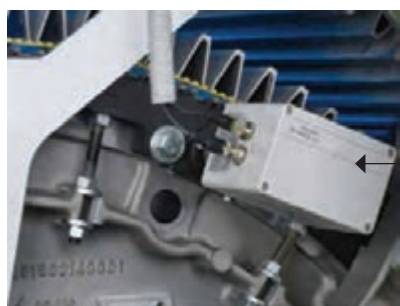
شکل ۳۵- موتور تنظیم فاصله کلاهدک و سیلندر (PFS-M)
