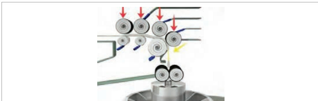
شکل ۸- چگونگی قرار گرفتن غلتک‌های کشش و غلتک‌های کاندن
