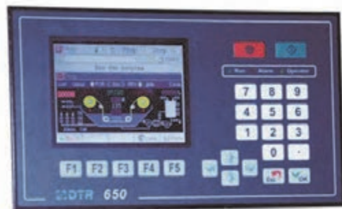
شکل ۹ تصویر یک صفحه‌ی پروگرامر ماشین جت
