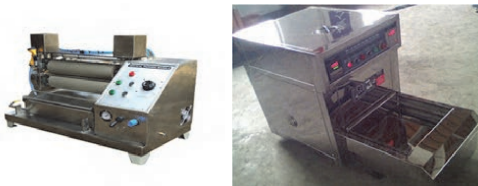
شکل ۱۱ ماشین رنگرزی ترموزول و فولارد آزمایشگاهی
