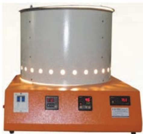
شکل ۱۴ یک مدل دستگاه تعیین ثبات نوری
