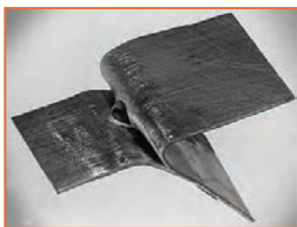
شکل ۱۹- نتیجه مطلوب در آزمون خم‌کاری
