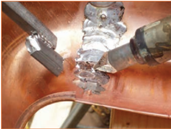
شکل ۲۲ - پرکردن درز اتصال به وسیله مذاب لحیم
