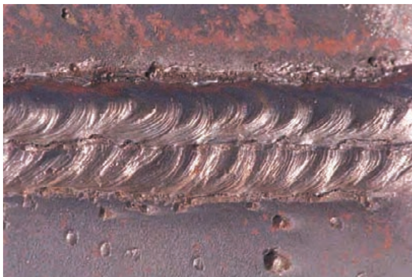
شکل ۴۰-۱: اندازه گرده جوش در پاس پوششی
