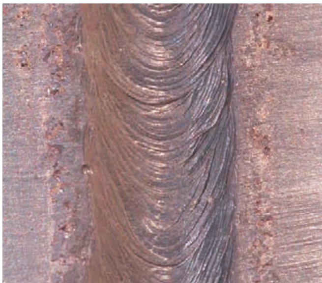
شکل ۲۷-۱: ساق جوش یکنواخت (toe)
