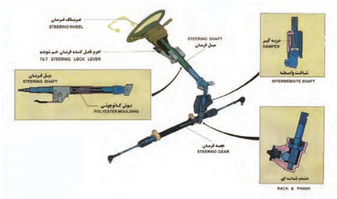
شکل ۲ - مجموعه فرمان و اجزای آن
