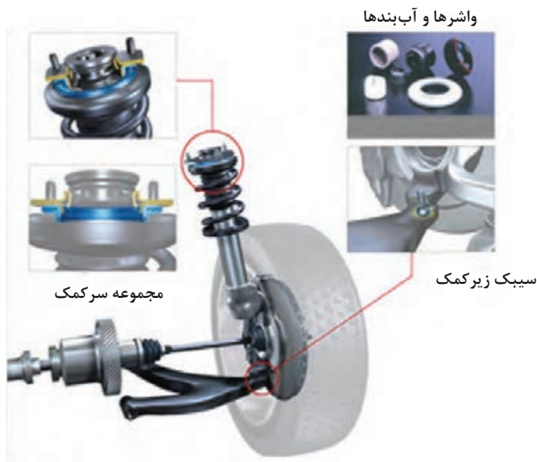
شکل ۳۴- برخی نقاط قابل تعمیر تعلیق مک فرسون
