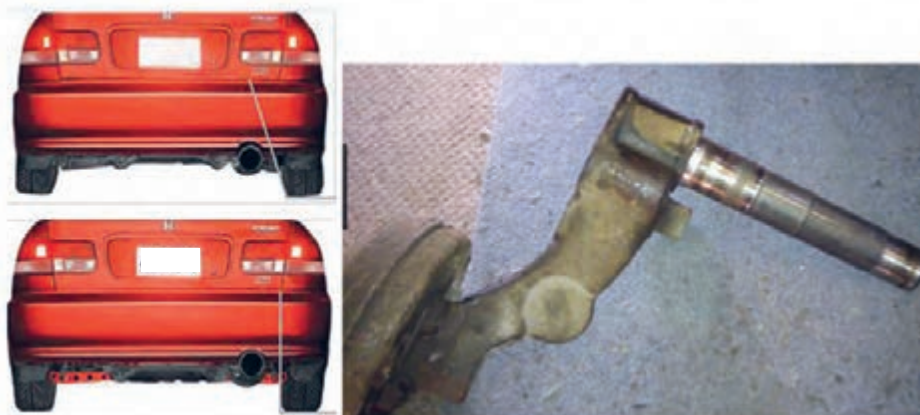
شکل ۴۵- خرابی بوش‌ها و تأثیر آن روی چرخ
