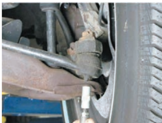
شکل ۳۳ - روش گریس کاری سیبک
