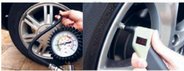
شکل ۲۱- شیوه بررسی و تنظیم فشار باد تایر
