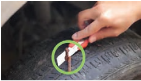
شکل ۲۷- مراحل پنچرگیری تایر بدون تیوب
