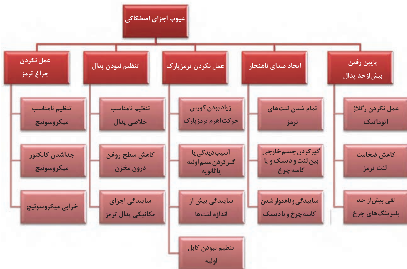
شکل ۲۳- عیوب اجزای اصطکاکی
