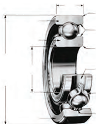
شکل ۵- ساختمان و اجزای بلبرینگ
