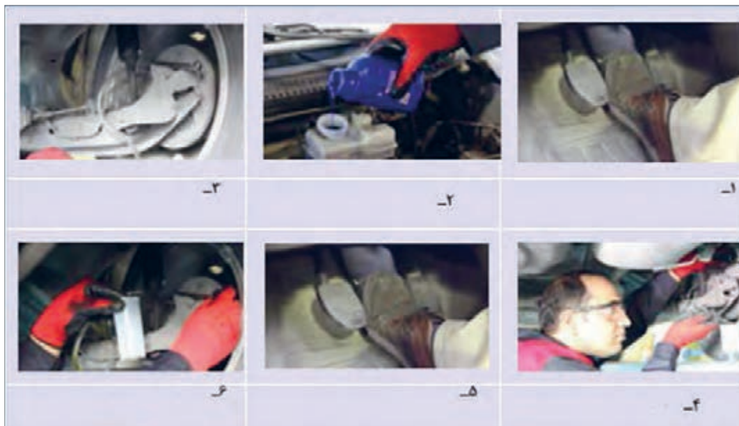
شکل ۱۹- مراحل هواگیری دستی مدار هیدرولیک ترمز
