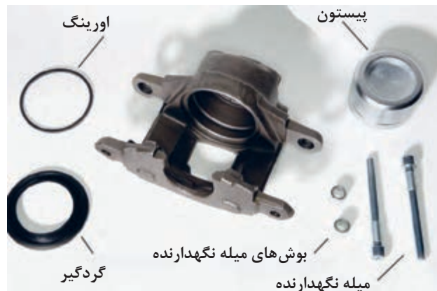
شکل ۳۶- اجزای مجموعه هیدرولیکی کالیپر ترمز
