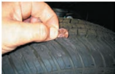
شکل ۱۷- نحوه اندازه‌گیری تقریبی شیار تایر
