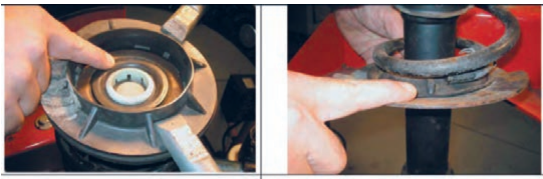
شکل ۳۶- برخی نکات مهم در هنگام بستن مجموعه تعلیق مک فرسون
