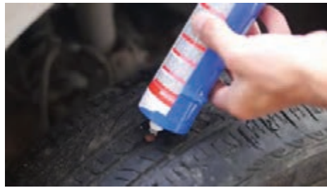
شکل ۲۷- مراحل پنچرگیری تایر بدون تیوب
