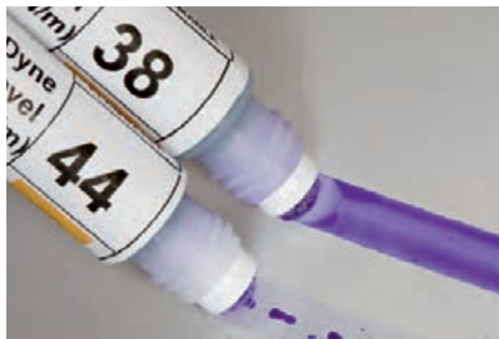
شکل ۳-۴۳ روش استفاده از ماژیک تستر
