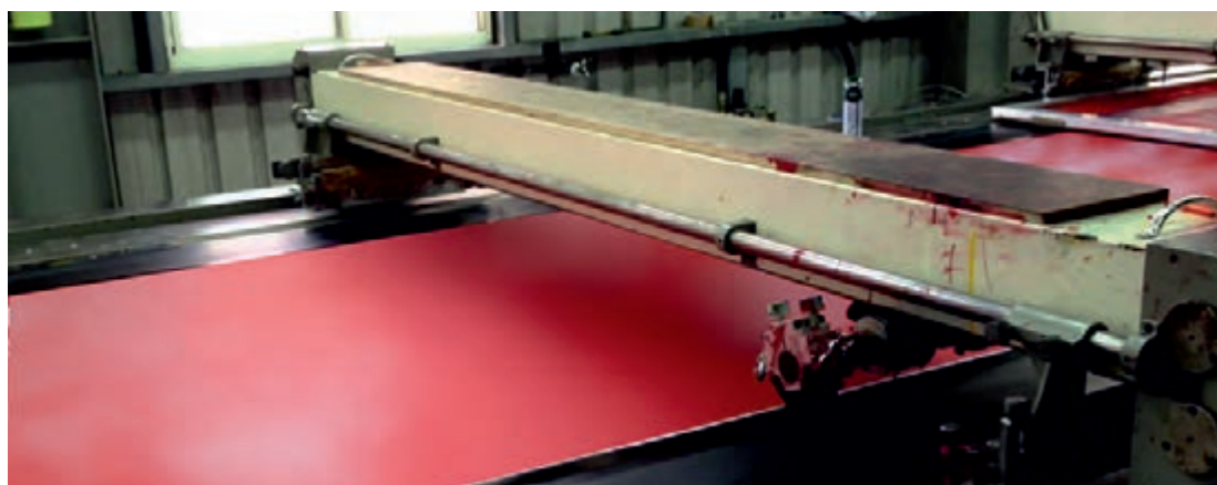
شکل ۱۷-۵ میز چاپ پارچه همراه با چسب
