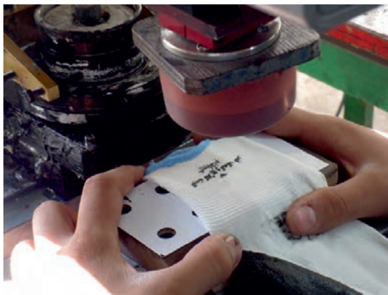
شکل ۳-۳۷ چاپ یک دستکش کار به روش بالشتکی
