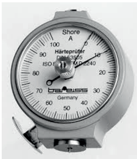
شکل ۴-۸۸ سختی سنج عقربه ای و دیجیتالی
