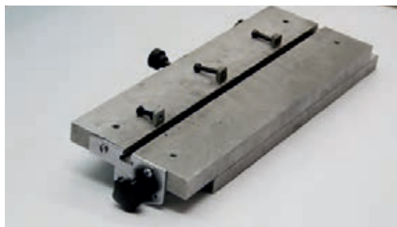
شکل ۲۶-۵ میز شیاردار- فیکسچر به همراه مهره های
