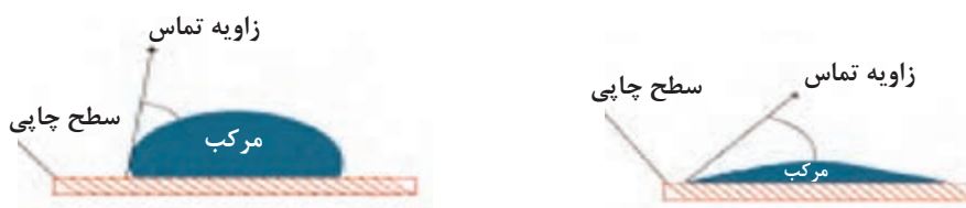
شکل ۳-۴۰ رابطه انرژی سطحی و زاویه تماس
