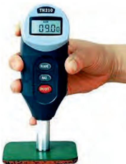
شکل ۴-۸۸ سختی سنج عقربه ای و دیجیتالی
