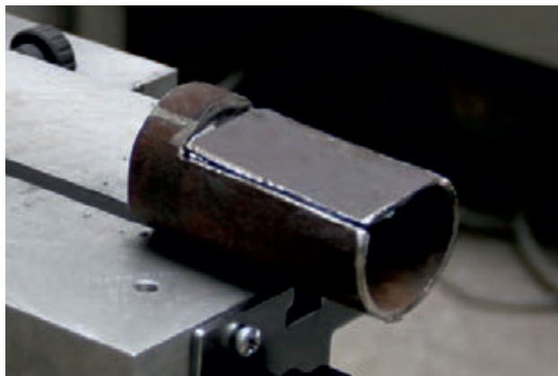
شکل ۲۴-۵ فیکسچرهای اندازه متغیر
