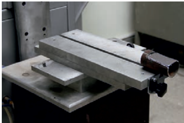
شکل ۵-۸ بستن قالب جای میز دستگاه
