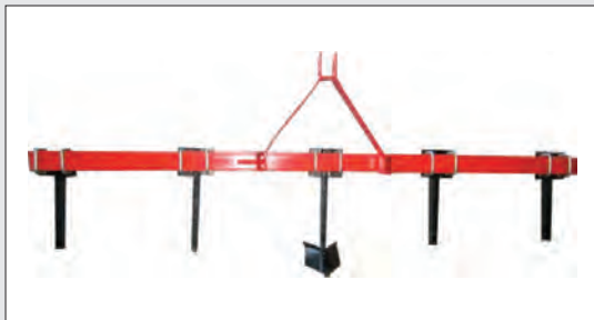
شکل ۳۱-۵- شیارکش با واحدهای عامل متعدد
