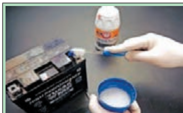
شکل ۱۸-۱- شست و شوی قطب‌ها با جوش شیرین و آب گرم
