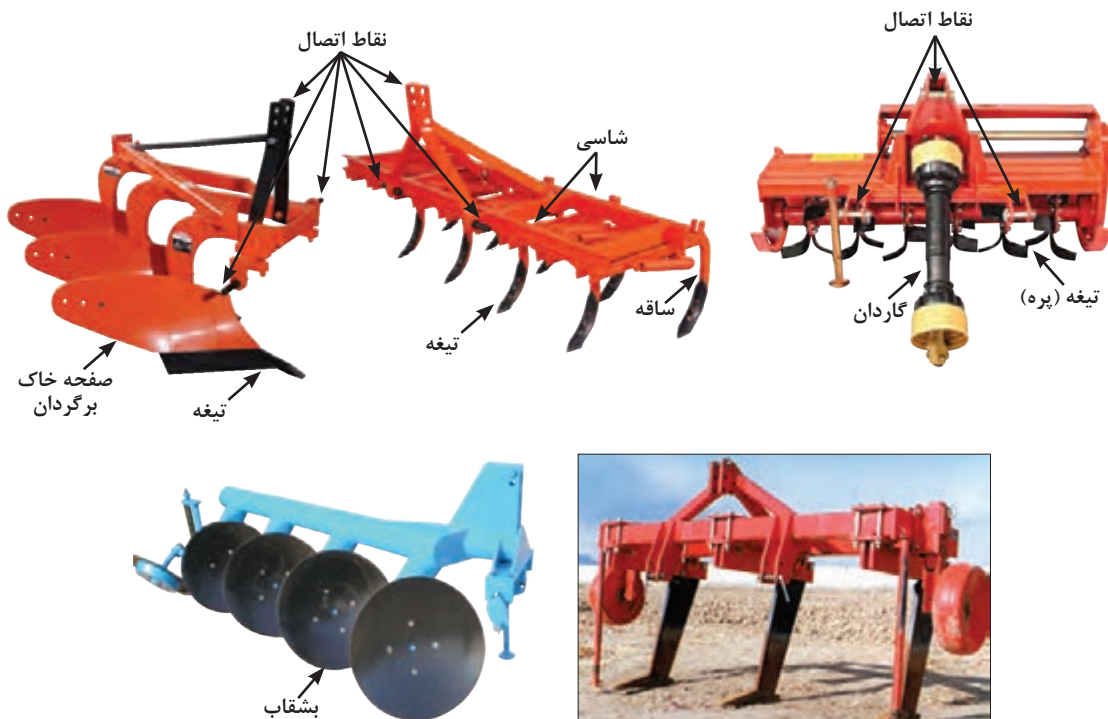
شکل ۱۹-۳- انواع گاوآهن‌ها و نمایش ساختار کلی آن
