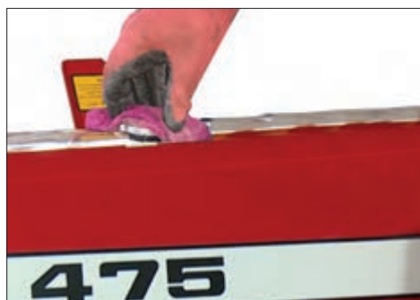
شکل ۴۵-۱ نحوه باز کردن درب رادیاتور
