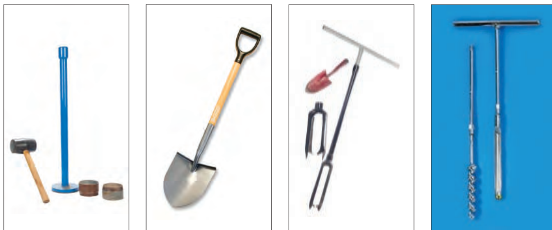
شکل ۸-۲- ابزار نمونه برداری از خاک
