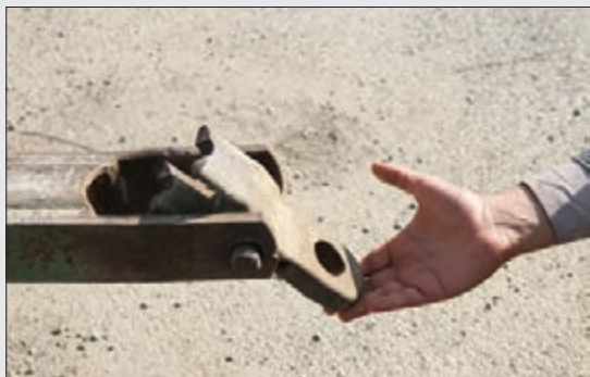
شکل ۱۲-۵- شکستگی نقطه اتصال صاف کننده
