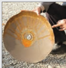
شکل ۱۸-۴- شکستگی نقطه اتصال و بشقاب
