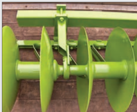
شکل ۲۰-۴- اجزای محور دیسک
