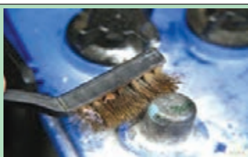
شکل ۱۷-۱- تمیز کردن قطب‌ها با برس سیمی
