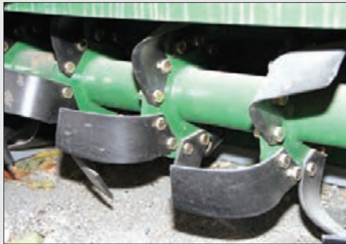
شکل ۲۲-۴- وضعیت درپوش و تیغه‌ها در گاوآهن دوار
