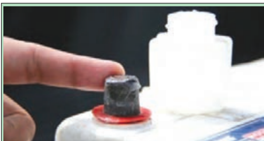
شکل ۲۰-۱- مالیدن گریس به قطب‌ها
