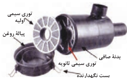
شکل ۲۶-۱- اجزای تشکیل دهنده صافی روغنی
