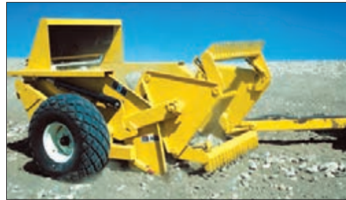
شکل ۲۰-۲- ماشین‌های سنگ جمع‌کن و اسکرپور
