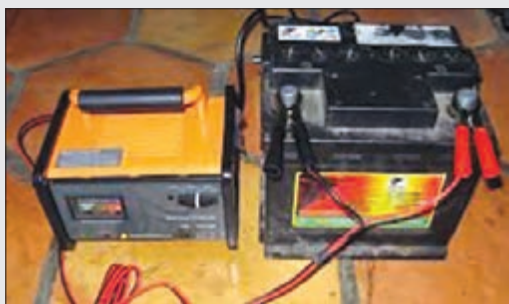
شکل ۵۲-۱- روش شارژ باطری با شارژر
