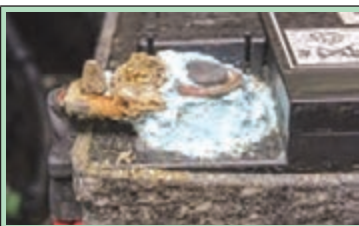
شکل ۱۶-۱- سولفاته شدن قطب‌های باتری
