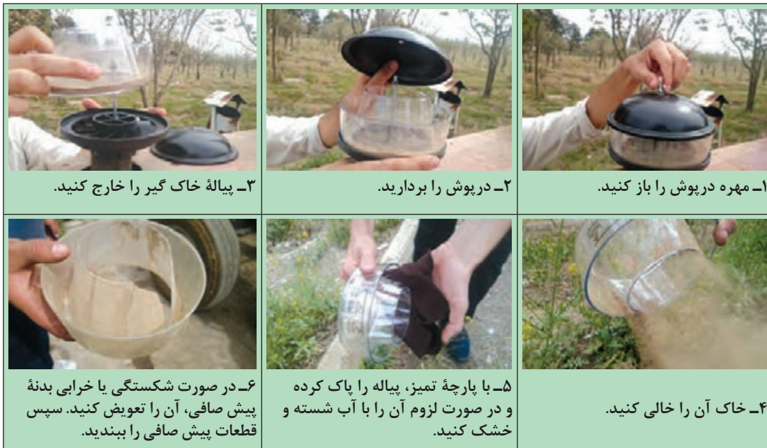
شکل ۳۱-۱- مراحل تمیز کردن پیش صافی
