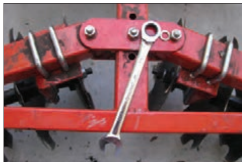
شکل ۲۸-۴ تغییر زاویه استقرار ردیف بشقاب‌ها روی شاسی
