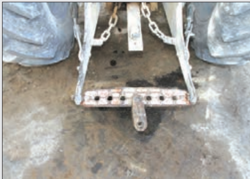
شکل ۲۹-۴- مالبند بلند و اتصال سه نقطه
