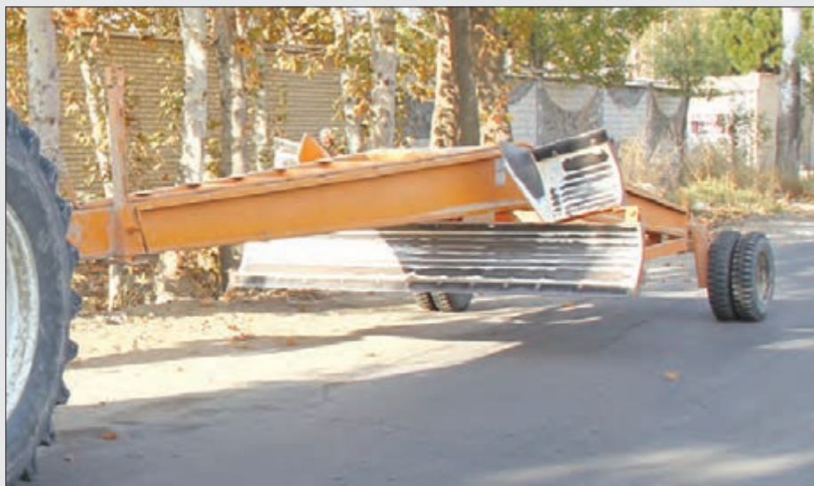
شکل ۱۹-۵- زمین‌صاف‌کن در وضعیت جابه‌جایی
