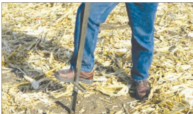
شکل ۹-۲- برداشت نمونه خاک با اُگر
