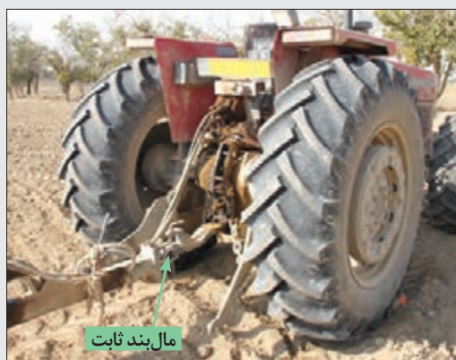
شکل ۱۶-۵- نقطهٔ اتصال در صاف‌کننده کششی
