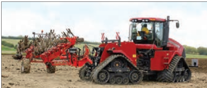
شکل ۵-۱- تراکتور چرخ زنجیری
