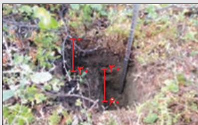
شکل ۱۵-۲- روش نمونه‌برداری از دو عمق ۳۰-۶۰ و ۳۰-۳۰
