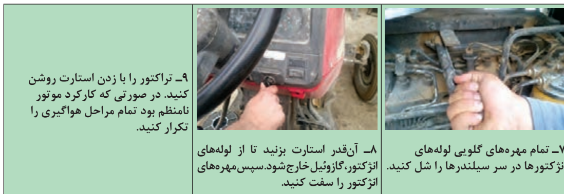
شکل ۴۰-۱- مراحل هواگیری سیستم سوخت رسانی
