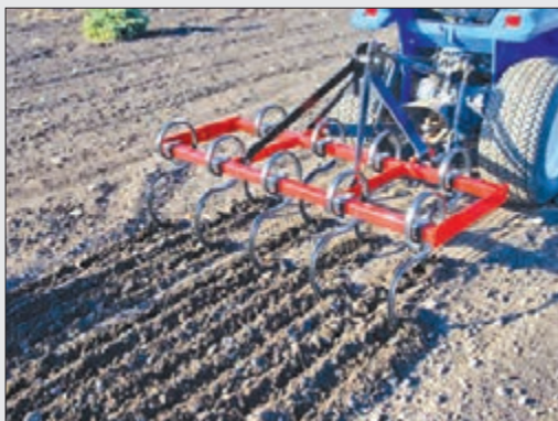
شکل ۳۳-۴ کولتیواتور با شاخه های فنری
