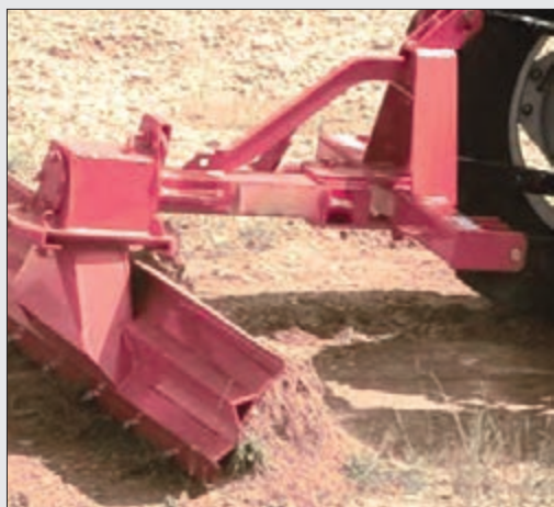
شکل ۲۶-۲ تیغه پشت تراکتوری متصل به تراکتور
