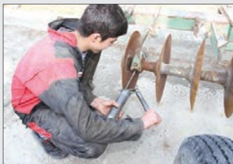
شکل ۲۱-۴- گریس کاری دیسک
