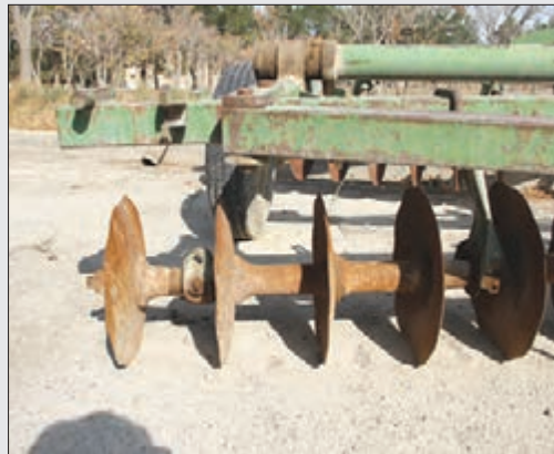
شکل ۱۹-۴- یاتاقان خراب بشقاب
