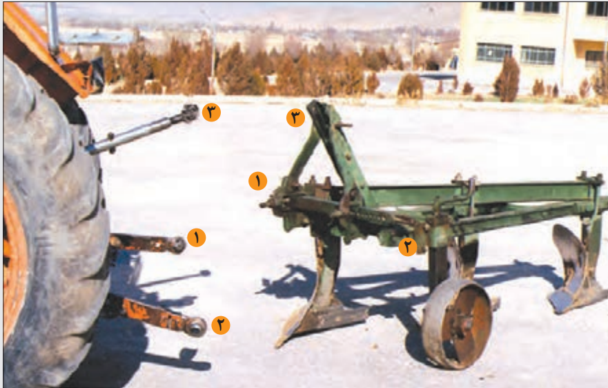
شکل ۲۸-۳- اتصال گاواهن به تراکتور
