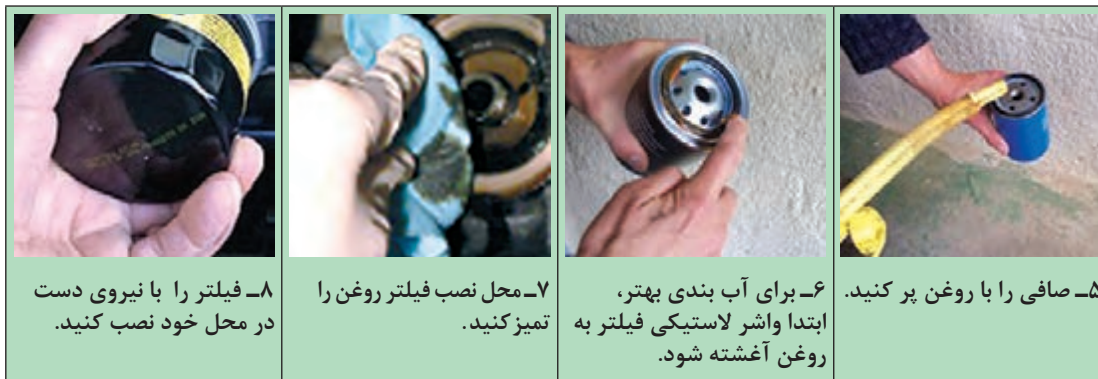
شکل ۵۰-۱- مراحل تعویض صافی روغن
