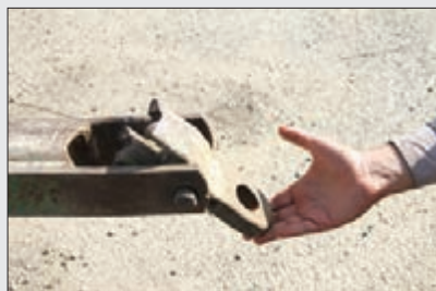
شکل ۱۸-۴- شکستگی نقطه اتصال و بشقاب
