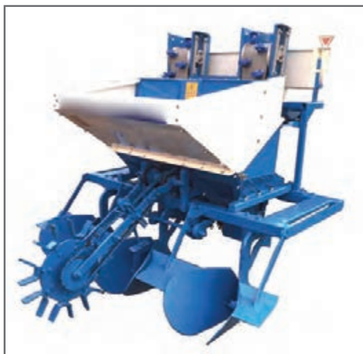
شکل ۵- غده کار خودکار دو ردیفه سوار با موزع پیاله ای
