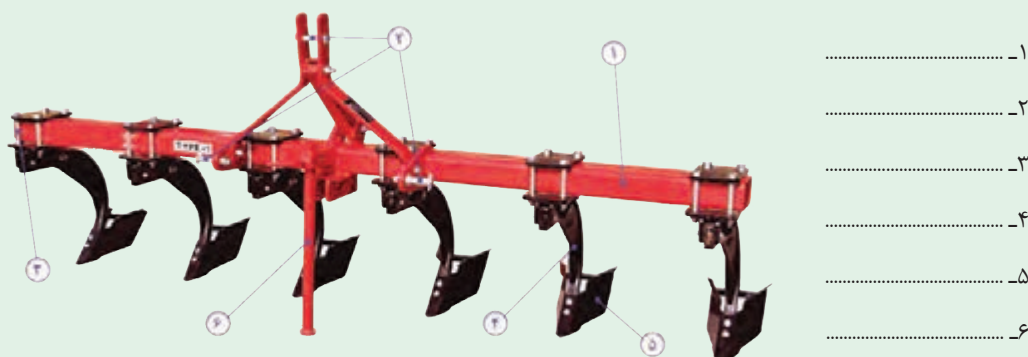
شکل ۱۳- ساختمان شیار کش
