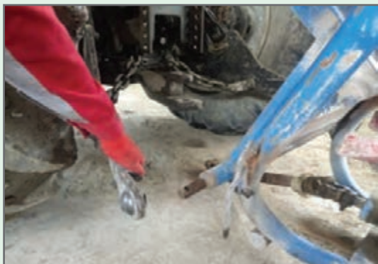
شکل ۹- اتصال بذریاش به بازوهای کناری تراکتور
