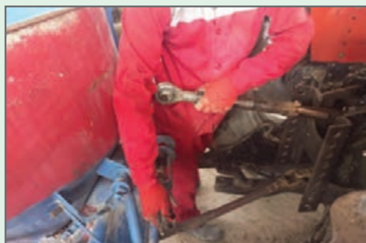
شکل ۱۱- اتصال بازوی وسط تراکتور به بذریاش
