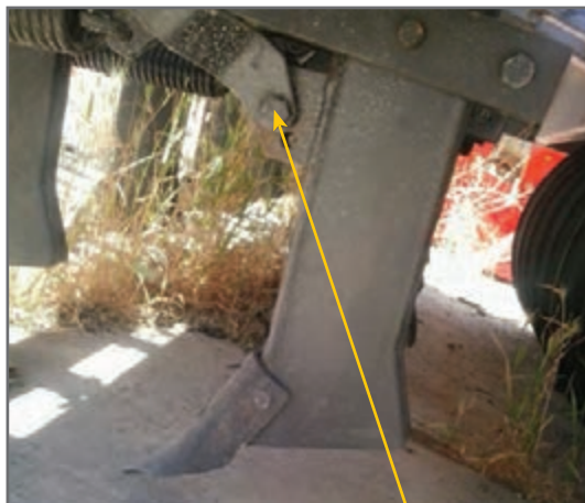
شکل ۵۴- سوراخ روی بازوی بیلچه شیار بازکن
