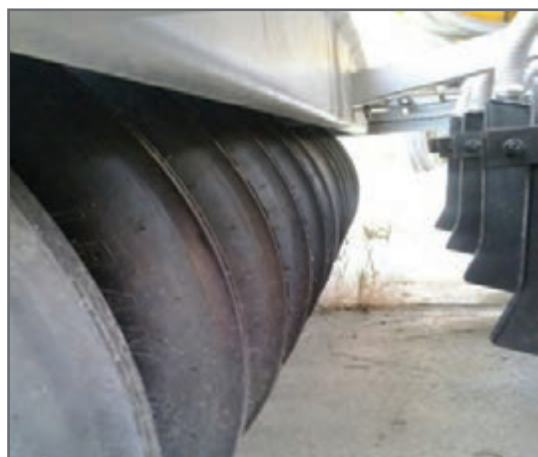
شکل ۵۵- چرخ های فشار دهنده بوشورت به هم پیوسته
