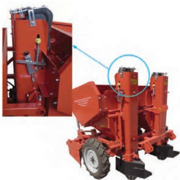
شکل ۱۳- مکانیزم تنظیم کشش نوار نقاله و تک دانه کن
