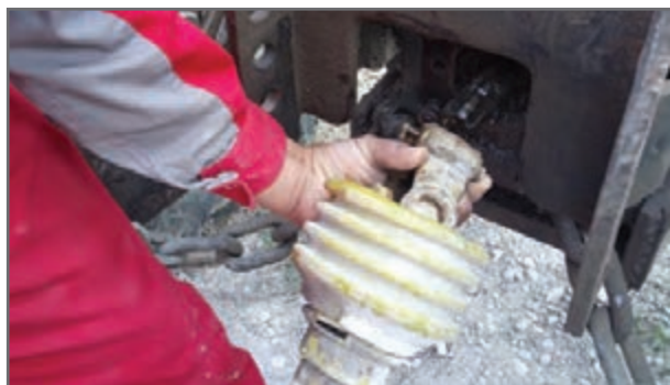
شکل ۱۲- اتصال گاردان به تراکتور
