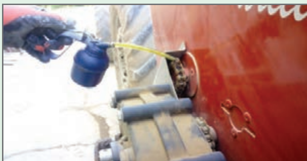
شکل ۴۳- روغن کاری چرخ دنده‌ها
