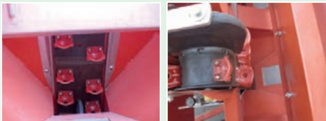
شکل ۱۶- موزع پیاله‌ای یک و دو ردیفه
