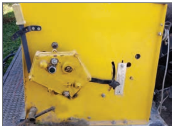
شکل ۱۵- جعبه دنده و درجه ریزش بذر
