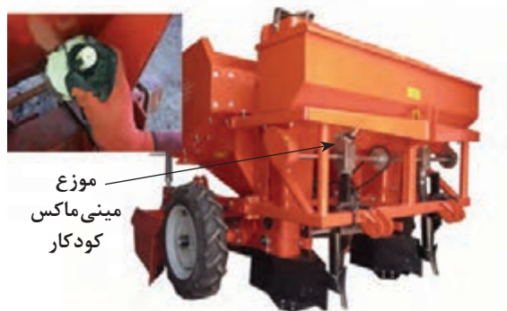
شکل ۱۵- تنظیم موزع میینی ماکس کودکار
