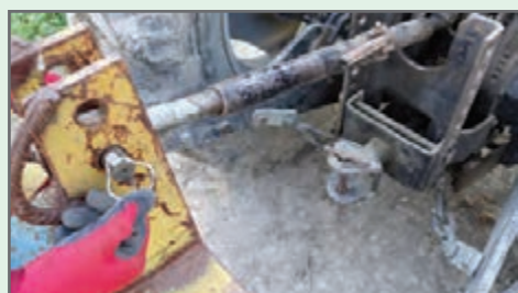
شکل ۲۳- اتصال بازوی وسط تراکتور به نه‌رکن
