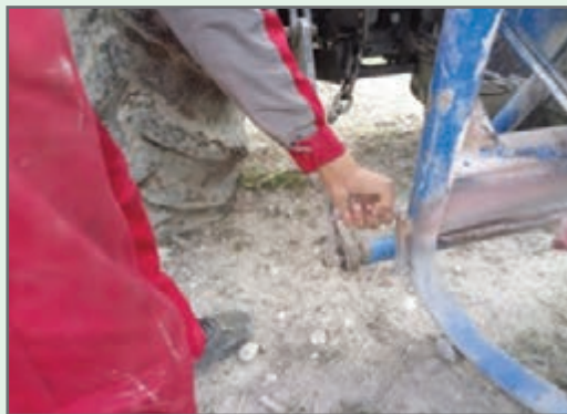
شکل ۹- اتصال بذریاش به بازوهای کناری تراکتور
