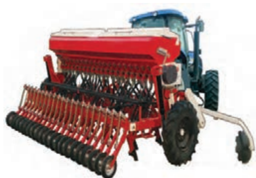
شکل ۳۴- کودکار و بذرکار کاشت مستقیم دیم مدل: KBDFN-21-21-420+P
