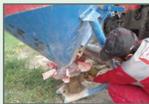
شکل ۱۰- نصب گاردان بین بذریاش و تراکتور
