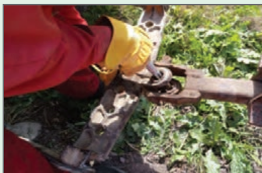
شکل ۱۱- اتصال دیسک کششی هیدرولیکی
