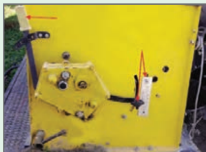
شکل ۱۷- اهرم تنظیم ریزش بذر
