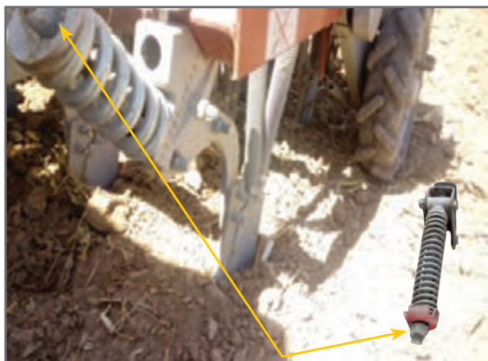
شکل ۵۳- شیار بازکن و مهره نگهدارنده فنر و تنظیم فشار
