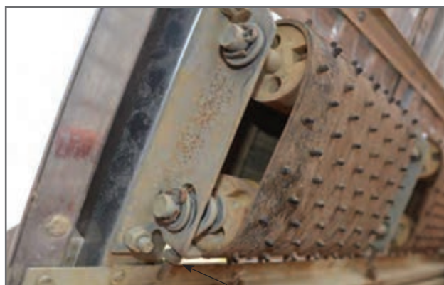
شکل ۲۳- تنظیم کشش تسمه انتقال نشاها
