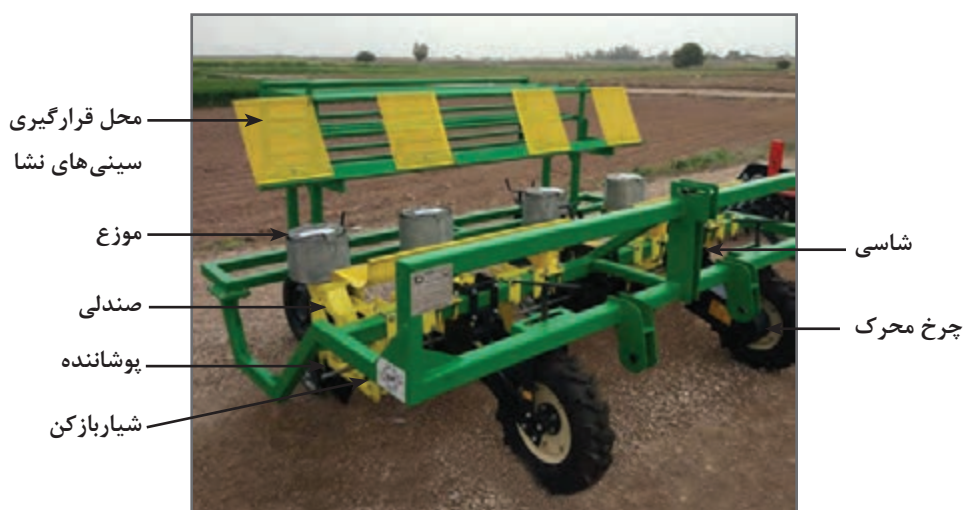
شکل ۴- اجزای ساختمانی یک نمونه نشاکار صیفی
