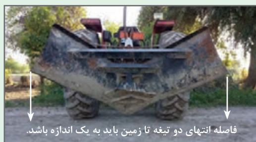
شکل ۲۵- تنظیم تراز عرضی نه‌رکن
