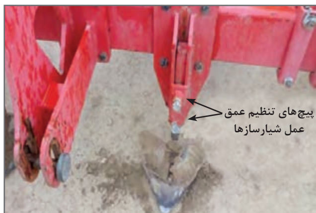
شکل ۱۷- پیچ‌های تنظیم عمق شیارساز
