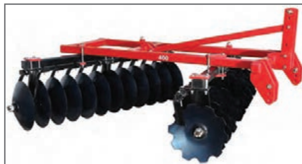
شکل ۵- دیسک آفست سوار
