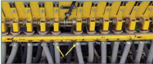
شکل ۲۸- بست‌های نگهدارنده لوله‌های سقوط
