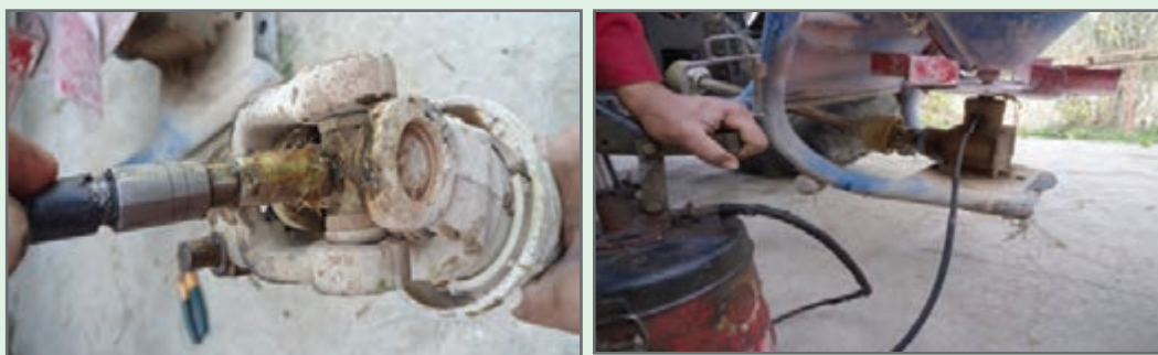
شکل ۱۶- گریس کاری گاردان و بذریاش
