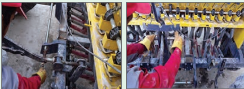
شکل ۱۳- متصل کردن خطی کار به تراکتور
