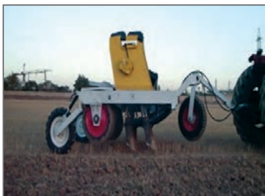
شکل ۴۷- خطی کارهای سوار و کششی در دیم کاری
