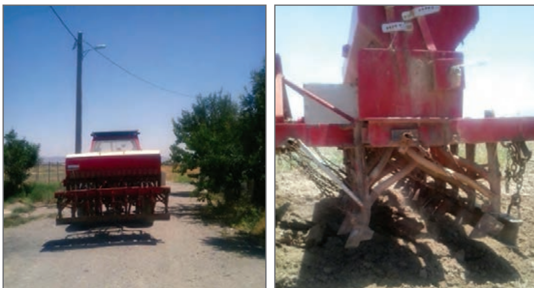
شکل ۵۰- برای تراز عرضی از پشت و برای تراز طولی از بغل به دستگاه نگاه کنید.
