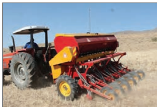
شکل ۳۵- کودکار بذرکار کشت مستقیم دیم مدل شاهین ۲۵۰۰
