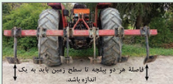
شکل ۱۴- تراز طولی شیارک
