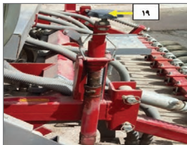
شکل ۳۹- اهرم تنظیم عمق کاشت
