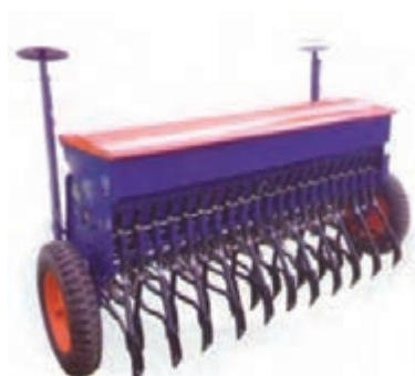
شکل ۵- خطی کار مخصوص کاشت گندم وجو
