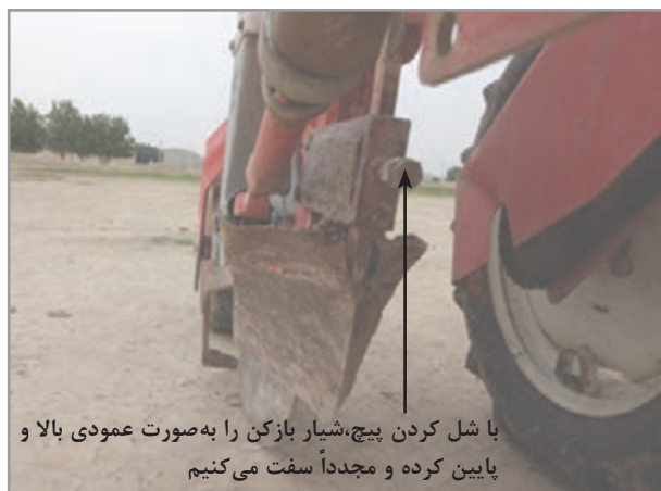
شکل ۲۰- تنظیم شیار بازکن
