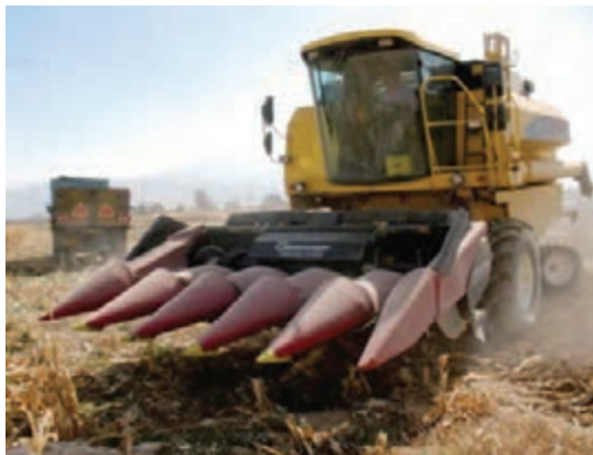
شکل ۱۲- کمباین دارای هد مخصوص برداشت ذرت دانه‌ای
