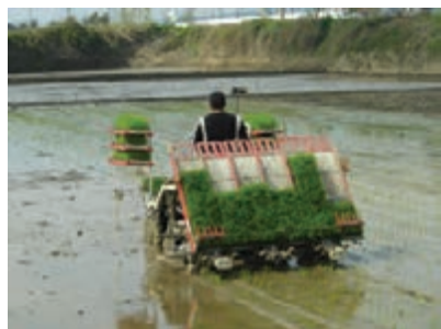
شکل ۳- نشاکاری برنج با نشاکار
