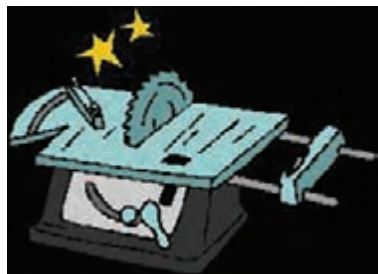
شکل ۳۱- نبود حفاظ در محل های متحرک دستگاه
