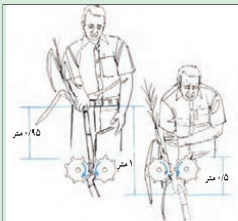
شکل ۲۷-۱- سعی در رفع گیر کردن ماشینی که در حال کار است یک مخاطره شدید محسوب می شود
