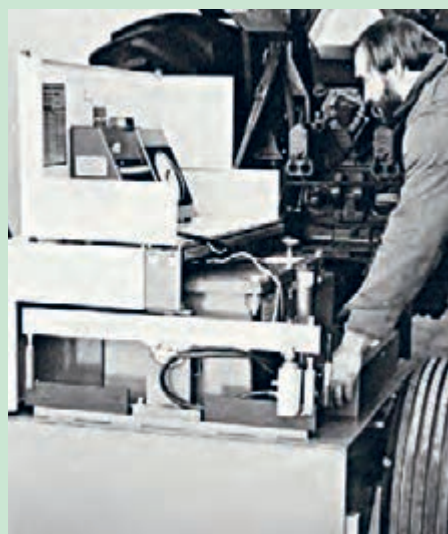
شکل ۳۶- اندازه‌گیری توان یک تراکتور با دینامومتر
