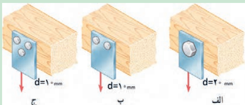
شکل ۲۰-۴- چند روش اتصال تسمه به دیوار چوبی تحت بارگذاری برشی
