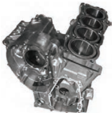
شکل ۲۰-۵- بدنه موتور (چدن خاکستری)
