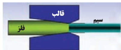
شکل ۲۵-۵- تولید سیم به روش کشش
