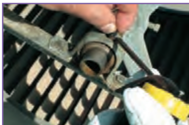
ث - روغن کاری یاتاقان‌ها
