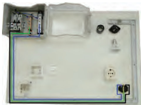
شکل ۵-۱۰- انجام سیم‌کشی پریز ۱
