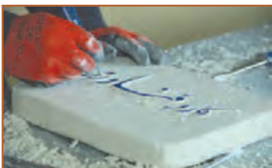
شکل ۷-۲۳ کنده کاری قطعه گچی
