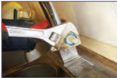
ث- باز کردن پیچ روی مغزی (گلند)
