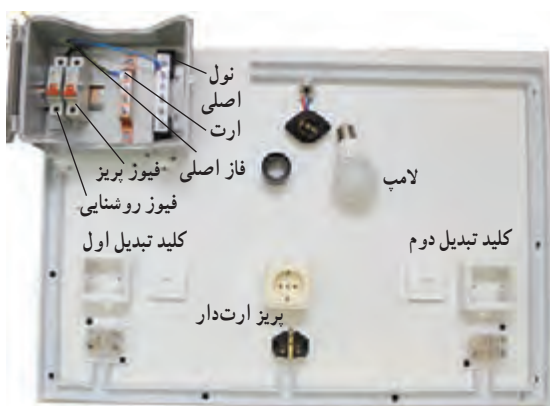
شکل ۵-۲۰- سیم‌کشی کلیدهای تبدیل
