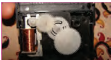
ب- بعد از باز کردن موتور ساعت
