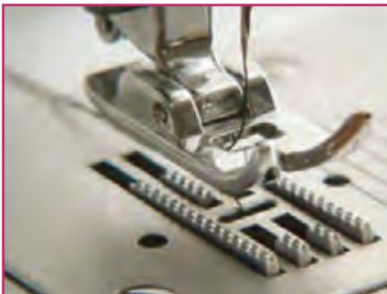
پ- ساز و کار حرکتی شانه (دندانه) کار پیش بر ماشین دوخت
