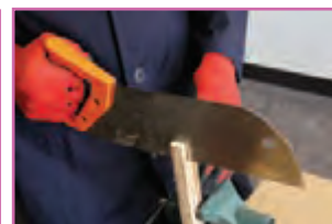
ث - اره کاری شیار بازوی چوبی
