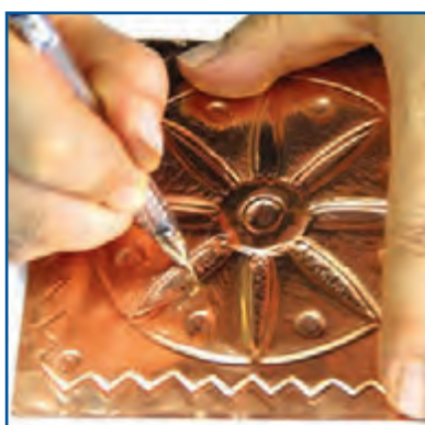
شکل ۶-۱۰- نحوه اجرای بافت
