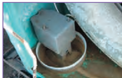
ج - بررسی و تمیز کردن پمپ آب
