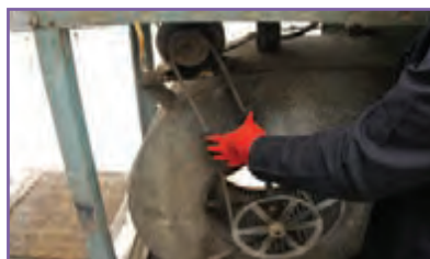
پ - بررسی وضعیت تسمه
