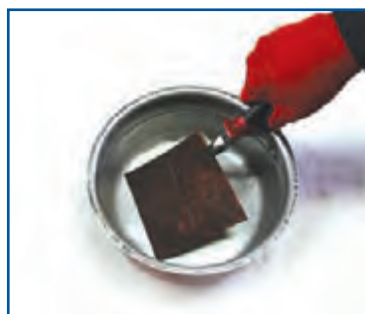
شکل ۹-۱- سرد کردن پلاک مسی با آب
