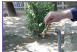
خ - آزمایش آب‌بندی شیر
