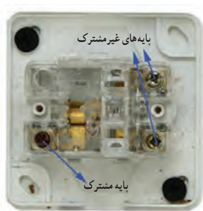
شکل ۵-۱۹- نمای داخلی یک نمونه کلید تبدیل
