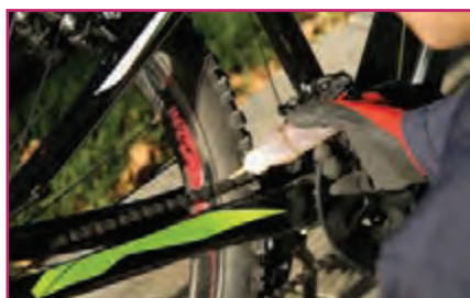
پ- روغن کاری اجزاء
