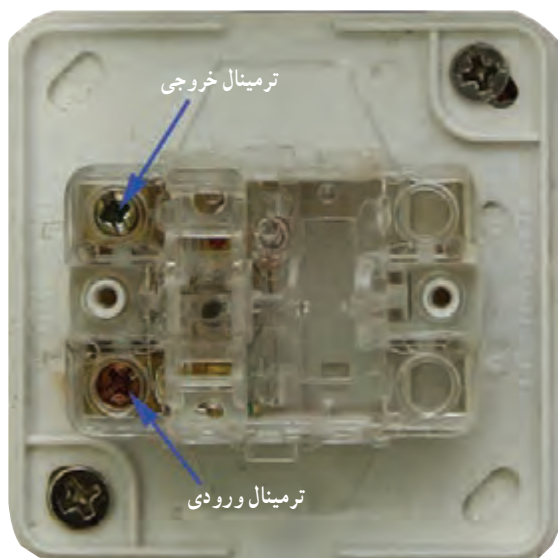
شکل ۴-۵- نمای داخلی یک نمونه کلید یک پل
