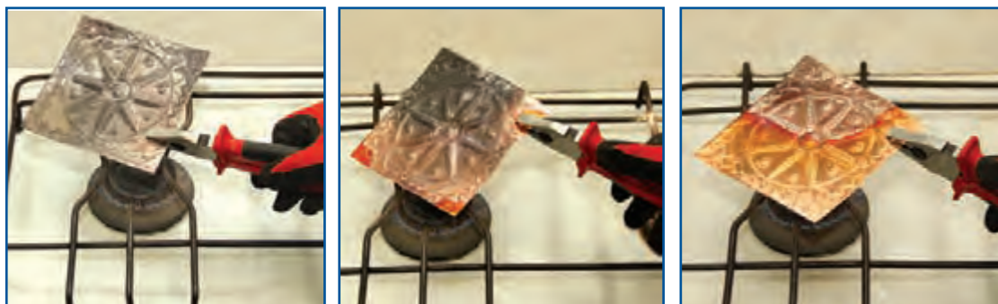
شکل ۸-۱- حرارت دادن پلاک مسی
