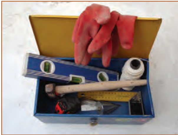
شکل ۱۰-۷- برخی از ابزار مورد نیاز دیوار چینی
