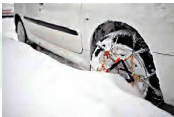
شکل ۸-۲۳ - استفاده از زنجیر چرخ
