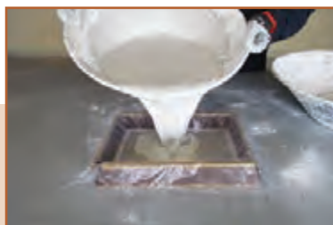
ث - ریختن ملات گچ در قالب
