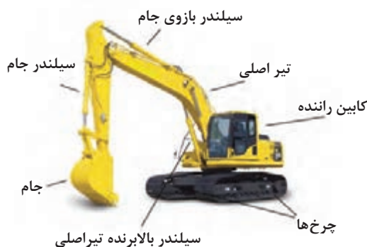
شکل ۵- قسمت‌های مختلف بیل مکانیکی
