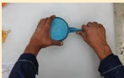
نحوه تنظیم انواع شناور
