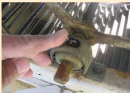
محل روغن کاری یاتاقان
