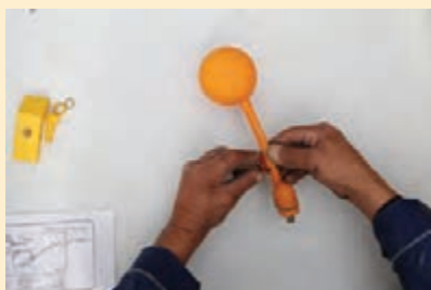
نحوه تنظیم انواع شناور
