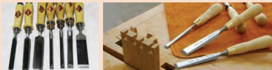
شکل ۲۱- انواع مغارها، برای ساخت اتصالات چوبی
