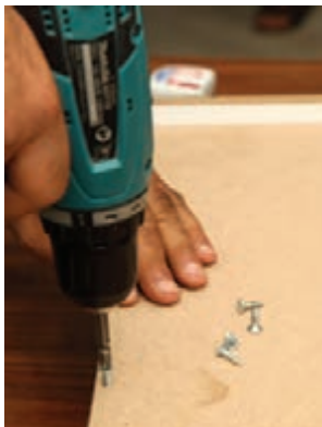
شکل ۵۶ - بستن کف جعبه با پیچ
