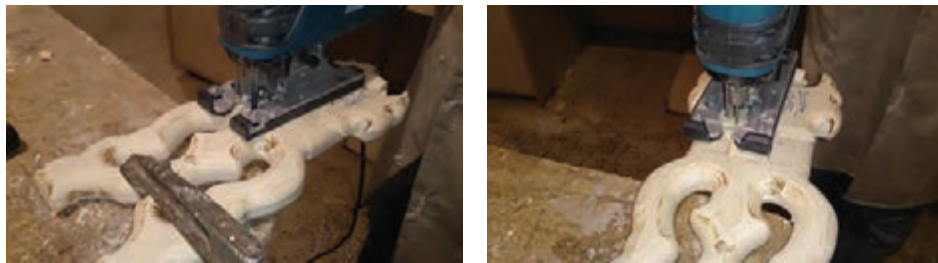
شکل ۲۶- برش طولی مفصل با اره عمودبر
