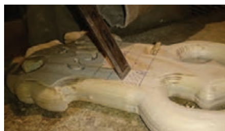
شکل ۲۳- مغارکاری مفصل‌ها به صورت غلط
