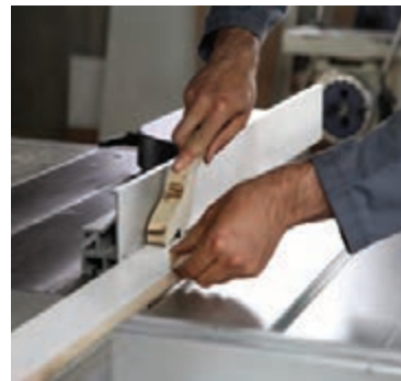
شکل ۵۱ - شیارزدن
