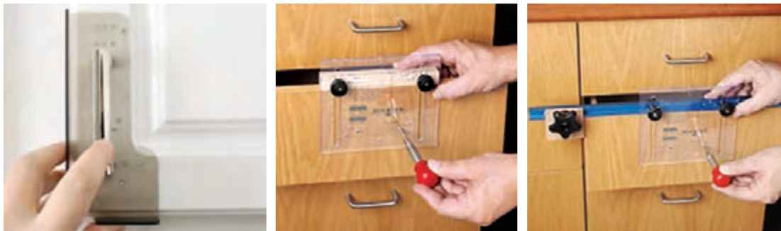
شکل ۱۳۵- چند نوع شابلون سوراخ کاری محل دستگیره
