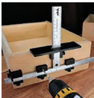
شکل ۱۳۴- چند نوع شابلون سوراخ کاری محل دستگیره
