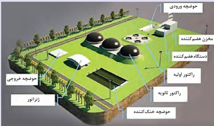
مواد آلی را در حوضچه ورودی، به نسبت تقریباً مساوی با آب مخلوط می‌کنند تا رقیق شوند، آنگاه این مواد را از طریق لوله‌ای به مخزن تخمیر منتقل می‌کنند. در این مخزن با انجام فعل و انفعالات شیمیایی بی‌هوایی، مجموعه‌ای از باکتری‌ها عملیات تخمیر و تولید گاز متان را انجام می‌دهند و گاز حاصله از قسمت بالایی مخزن (انباره گاز) جمع‌آوری شده و از آنجا به حوضچه و کanal خروجی منتقل می‌شود. بقایای مواد آلی پس از تخمیر، به عنوان کودی مرغوب، در کشاورزی استفاده می‌شود.
