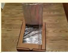
۶. خط کش را در بین پخش بریده شده و در حالت بسته قرار می‌دهیم تا پوشش آلومینیوم درون جعبه، نور را به داخل جعبه بازتاب دهد.
