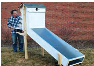
**خشک کن غیرمستقیم:** در این روش درجه حرارت قابل کنترل است و موادغذایی به‌طور مستقیم با اشعه خورشید در تماس نیستند. در نتیجه رنگ آنها ثابت می‌ماند. در این وسیله با عبور هوای گرم شده توسط خورشید از درون محفظه، آب داخل محصولات تبخیر شده و هوای مرطوب از قسمت هواکش خارج می‌شود.
