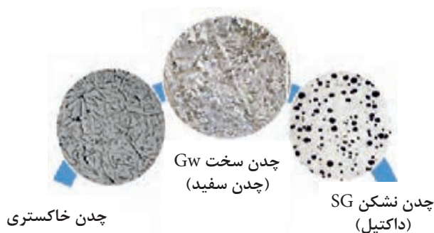
شکل ۱۹- انواع چدن و شکل متالوگرافی آنها
