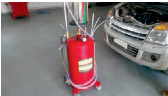
تعویض روغن موتور با ساکشن
