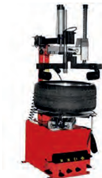
تعویض لاستیک با دستگاه
