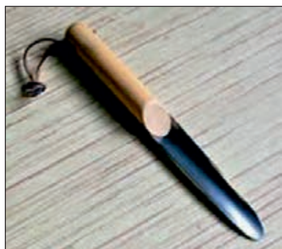
سوند برای برداشت سبزی و صیفی‌های ساقه‌ای
