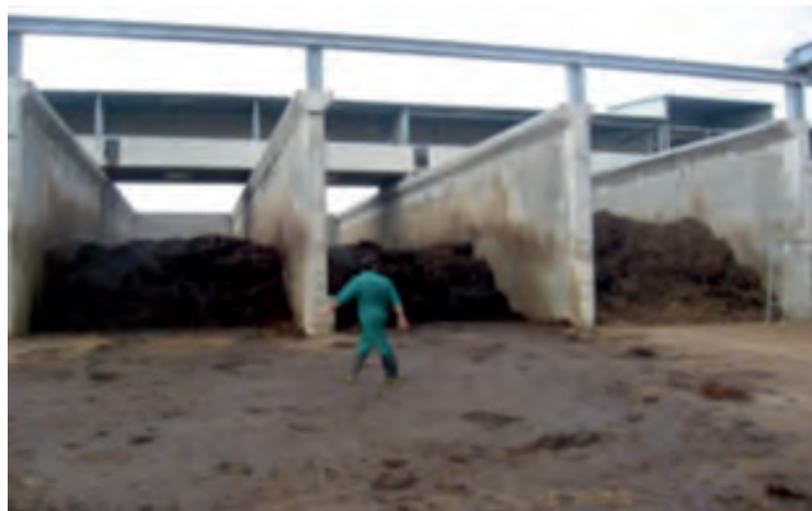
بونکرهای مخصوص پاستوریزاسیون
