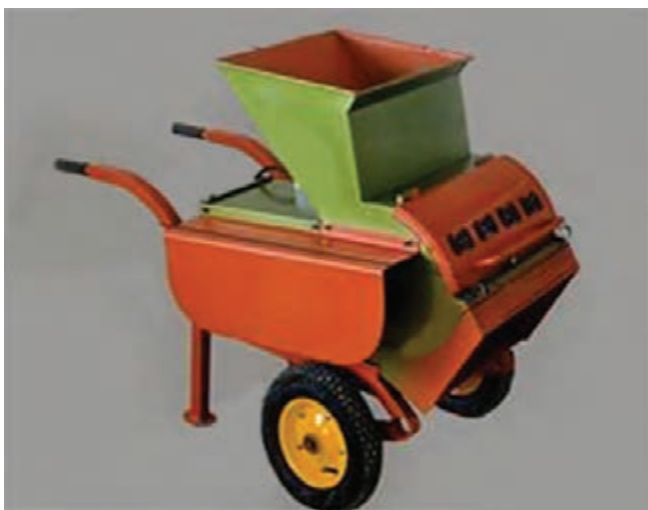
یک نمونه دستگاه علوفه خردکن
