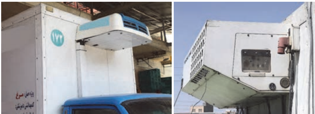
شکل ۲۱- تجهیزات سرمایشی نصب شده بر روی وسیله‌نقلیه
