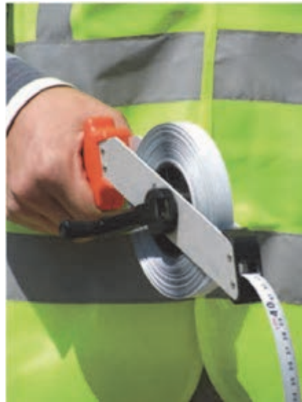
شکل ۱۶- متر کمری ۷/۵ متری و متر فلزی ۵۰ متری
