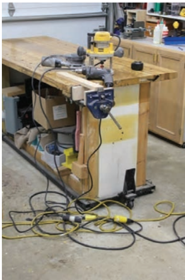
استفاده از پریز زمینی (نامنظم بودن سیم‌ها)
