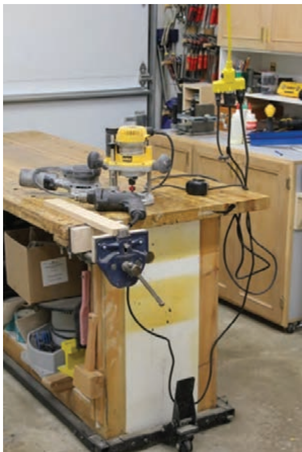
استفاده از پریز سقفی (منظم بودن سیم‌ها)
