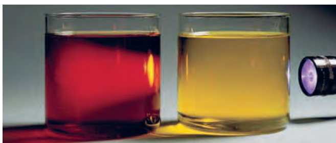
شکل ۲- مقایسه رفتار نور در یک محلول و کلئوئید. ذره‌های موجود در کلئوئید درشت‌تر از محلول اند و به همین دلیل نور را پخش می‌کنند.
