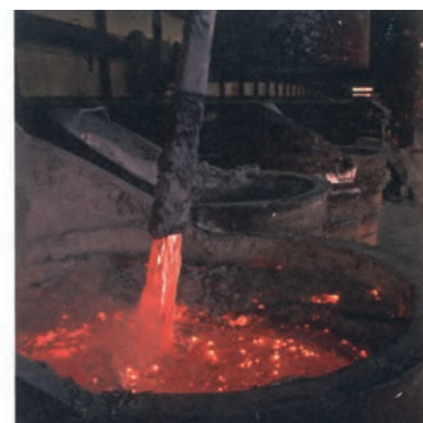
شکل ۱۸- فرایند هال برای تولید آلومینیم از \text{Al}_2\text{O}_3
