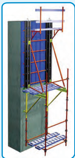
شکل ۲۰-۳- قالب رونده (لغزنده)
