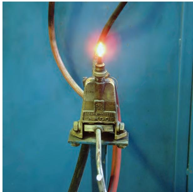
شکل ۲-۶۸—شمعک روی میز جوشکاری گاز
