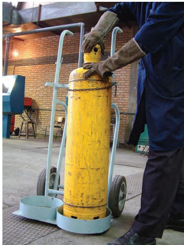
شکل ۲-۱۹—کپسول استیلن و کلاهک آن
