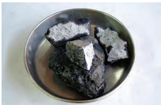
شکل ۲-۱۱—قطعه شکسته شده‌ی سنگ کاربید و شکل ظاهری آن
