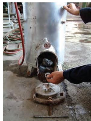
شکل ۲-۳۴ - قراردادن کاربید در محفظه مخصوص
