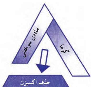
شکل ۱-۱۶- ممانعت از رسیدن اکسیژن به ماده‌ی سوختنی
