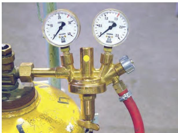
شکل ۲-۱۳۵- پیچ تنظیم فشار استیلن روی رگولاتور
