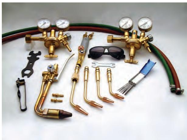
شکل ۲-۱۵- تجهیزات جوشکاری با شعله‌ی گاز
