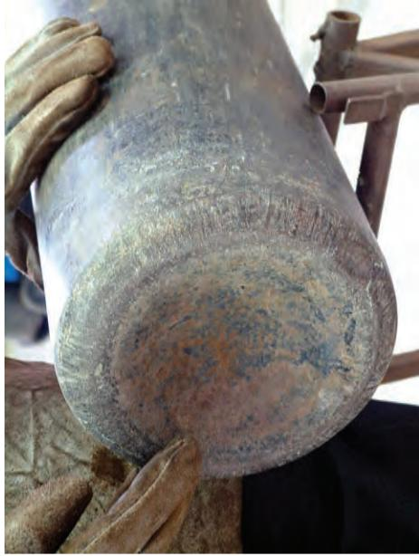
شکل ۲-۱۸—گودی ته کپسول اکسیژن
