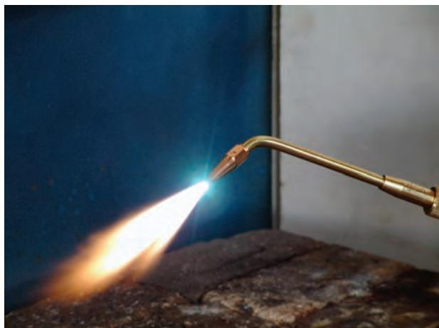
شکل ۱-۳- شعله‌ی سوختن گاز استیلن با اکسیژن
