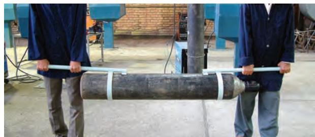
شکل ۲-۸۶—روش درست جابه‌جا کردن کپسول
