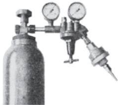
شیر اطمینان خشک : این وسیله مانند شیر یک طرفه عمل می کند و مانع عبور گاز مخلوط به داخل کپسول می گردد (شکل ۲-۴۴).
