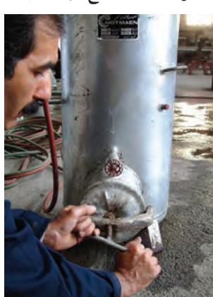
شکل ۲-۳۶ - بستن دریچه محفظه کاربید
