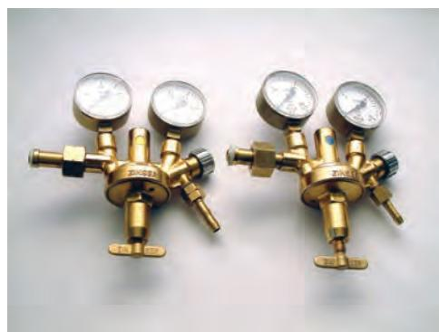
شکل ۲-۴۵ - رگولاتور اکسیژن و استیلن
