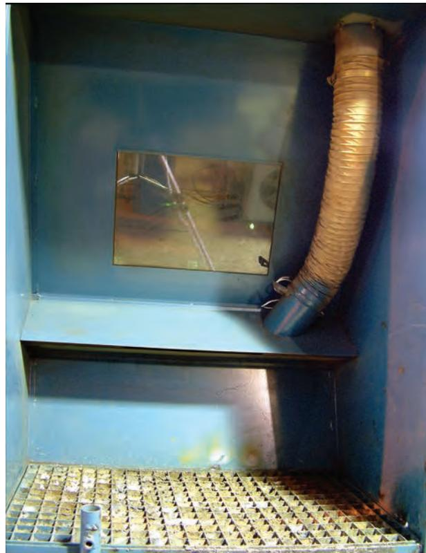
شکل ۱-۳۸- نمایی از یک کایین با تهویه
