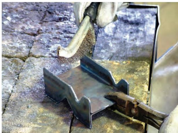
۱۴- سطح قطعه کار جوش داده را برس بزنید و اشکالات کار را بررسی نمایید. شعله باید یکسان لبه هارا ذوب کند و موج های جوش یکنواخت باشد (شکل ۲-۱۷۹).
