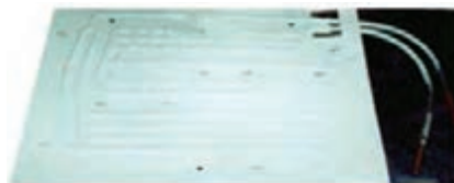
شکل ۵-۳ - محل لوله‌های انتقال گاز
