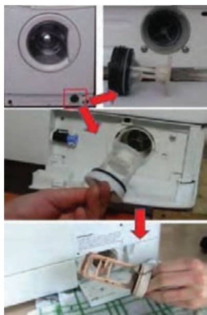
شکل ۳-۴- نحوه تمیز کردن فیلتر لباسشویی
