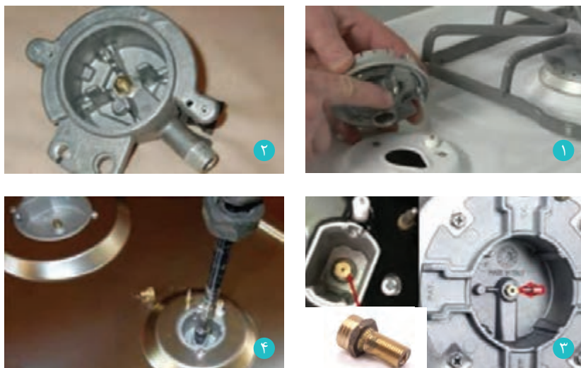
شکل ۴-۷- مراحل تعویض ژیگلور یا پستانک گازی
