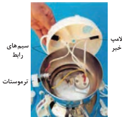
شکل ۱۷-۴ - اجزای داخلی سماور برقی
