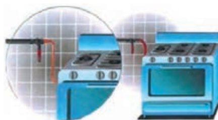
شکل ۵-۷- اجاق گاز باید به وسیله لوله فلزی به سیستم لوله کشی نصب شود.
