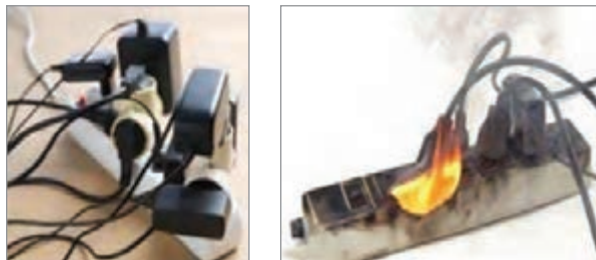
شکل ۸-۶- خطر جرقه زدن و آتش‌سوزی در اتصال زنجیره‌وار
