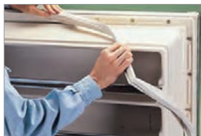
شکل ۹-۵- تعویض نوار لاستیکی در یخچال
