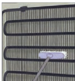
شکل ۵-۶ - تمیز کردن کندانسور یخچال
