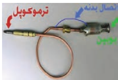
شکل ۱۰-۷- ترموکوپل بخاری گازی
