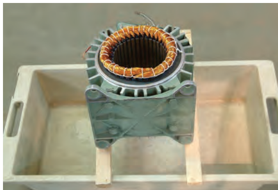
شکل ۴-۲۲- خارج کردن اضافات شارلاک از استاتور
