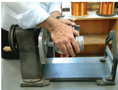
شکل ۱۸-۳- باز کردن قالب‌ها
