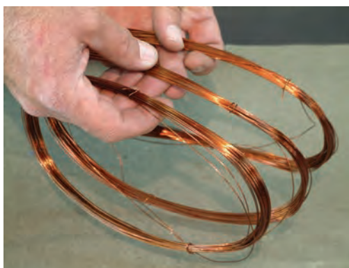
شکل ۱۹-۳- درآوردن کلاف از قالب
