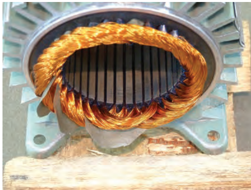
شکل ۲-۳۱- عایق کاری پیشانی کلاف‌ها
