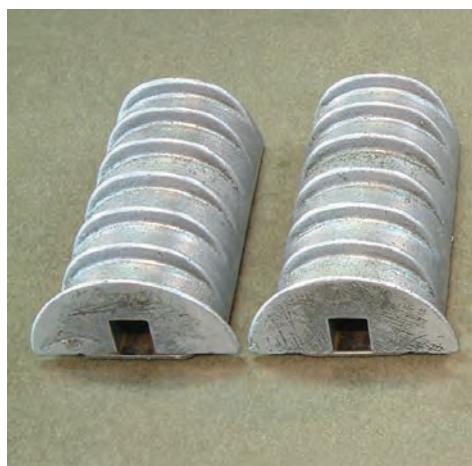
شکل ۲-۳- قالب کلاف مساوی
