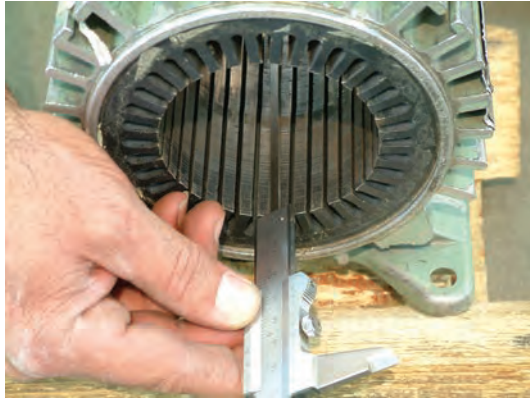
شکل ۲۶-۲- اندازه گیری محیط داخلی و طول شیار
