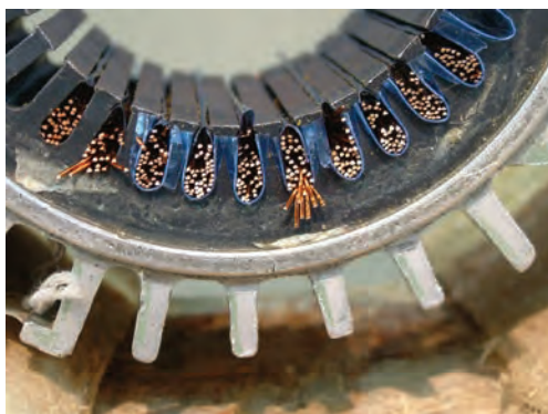
شکل ۲-۲۱ - برش سیم‌ها در یک طرف استاتور
