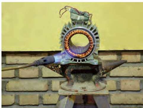
شکل ۲-۱۸- سوزاندن مستقیم سیم‌ها با شعله
