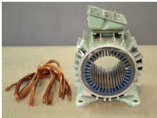
شکل ۲۴-۲ – سیم‌های بیرون آمده از استاتور
