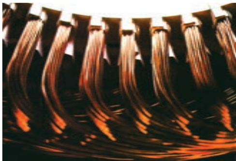
شکل ۲-۳۰- عایق گذاری بین طبقات
