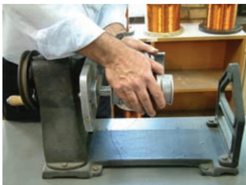
شکل ۱۸-۳ - باز کردن قالب‌ها
