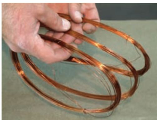
شکل ۱۹-۳ - درآوردن کلاف از قالب
