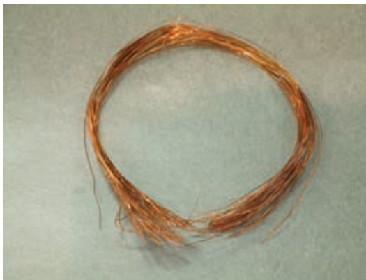
شکل ۱۶-۳- الف - شمارش تعداد دور هر بوبین
