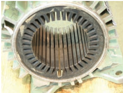
ب - اندازه کردن ابعاد عایق با ابعاد شیار شکل ۲۸-۲ - تنظیم عایق برشمان در شیارهای استاتور
