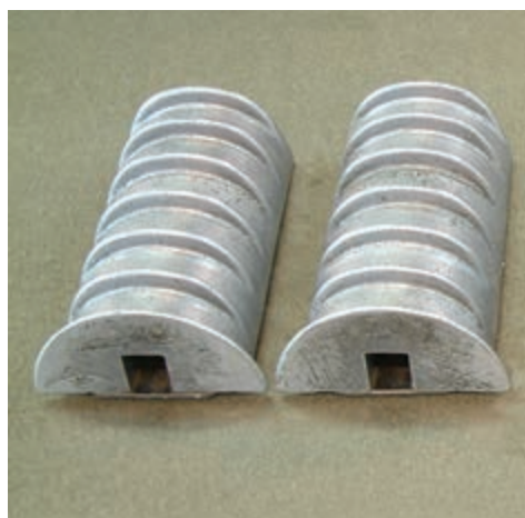
شکل ۲-۳- قالب کلاف مساوی
