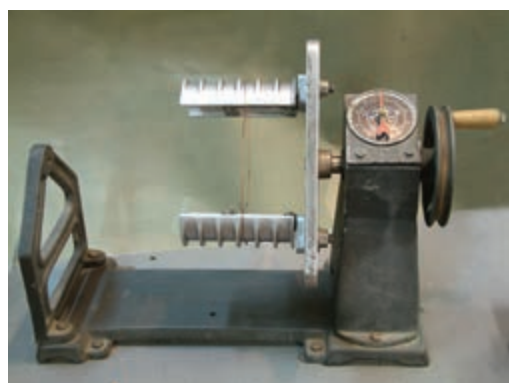
شکل ۳-۵- تنظیم قالب‌ها بر اساس اندازه‌ی کلاف
