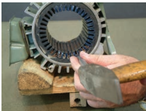
شکل ۲-۲۳ - هدایت سیم ها به طرف دوم استاتور
