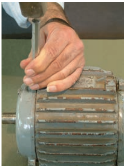
شکل ۱-۲۳- علامت‌گذاری روی پوسته و درپوش‌ها
