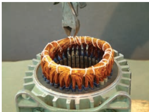
شکل ۲-۱۳ - چیدن نخ‌های کلاف‌بندی با سیم‌چین
