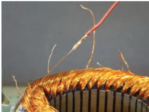
شکل ۴-۱۱- اتصال سیم‌های افشان به سیم‌های لاک‌ی
