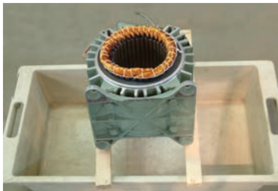
شکل ۴-۲۲- خارج کردن اضافات شارلاک از استاتور
