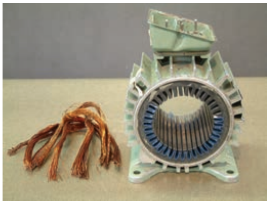
شکل ۲۴-۲- سیم‌های بیرون آمده از استاتور
