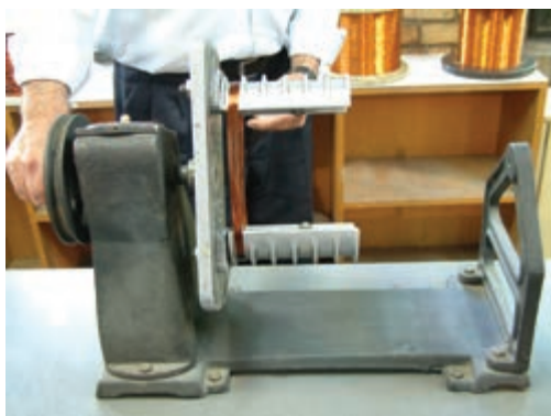
شکل ۱۷-۳ - بیچیدن سیم‌ها روی قالب‌ها
