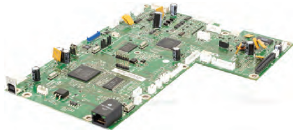
شکل ۲-۴۴ - برد اصلی دستگاه چهارکاره لیزری
