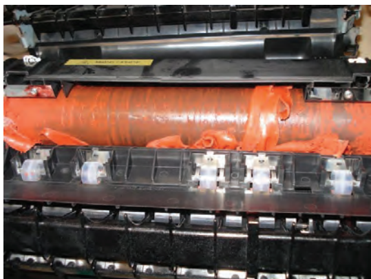
شکل ۳-۳۶- غلتک پرس معیوب
