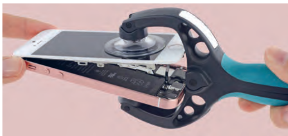
شکل ۵-۳۵- جدا کردن صفحه لمسی با ابزار وکیوم
