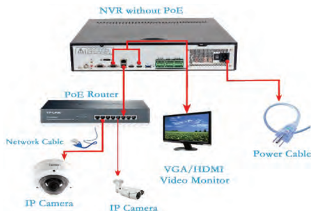
شکل ۱۷- اتصال دوربین به NVR
