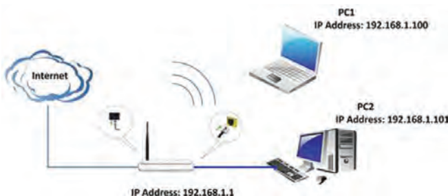
شکل ۳- شبکه خانگی مودم ADSL
