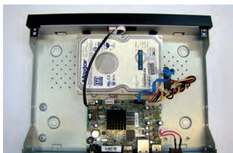
شکل ۳۵- محکم کردن دیسک سخت در محل نصب
