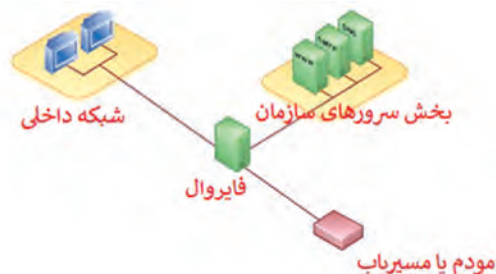
شکل ۲۳- محل قرارگیری فایروال بین شبکه داخلی و شبکه خارجی
