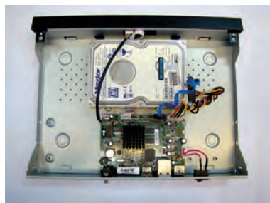
شکل ۲۱- دستگاه باز شده NVR
