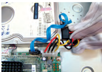
شکل ۳۴- اتصال کابل تغذیه دیسک سخت
