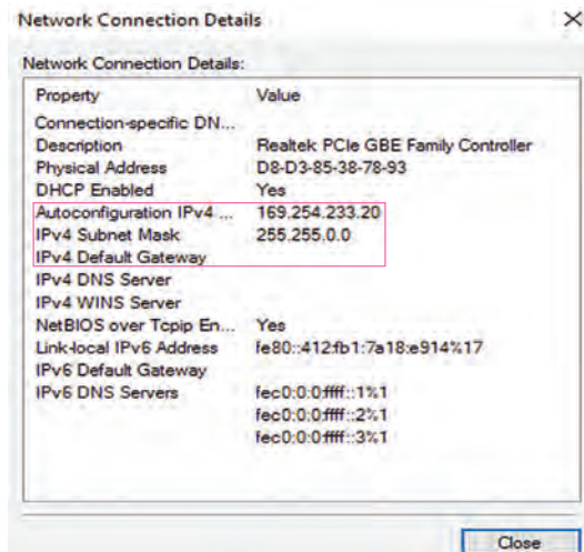
شکل ۲۳- مشخصات کارت شبکه
