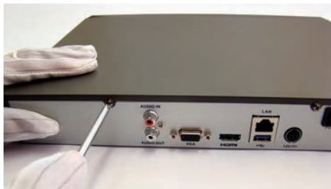
شکل ۳۲- بازکردن درپوش NVR
