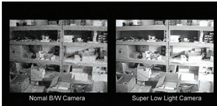
شکل ۱۸- تأثیر مشخصه Minimum Illumination در تصویر
