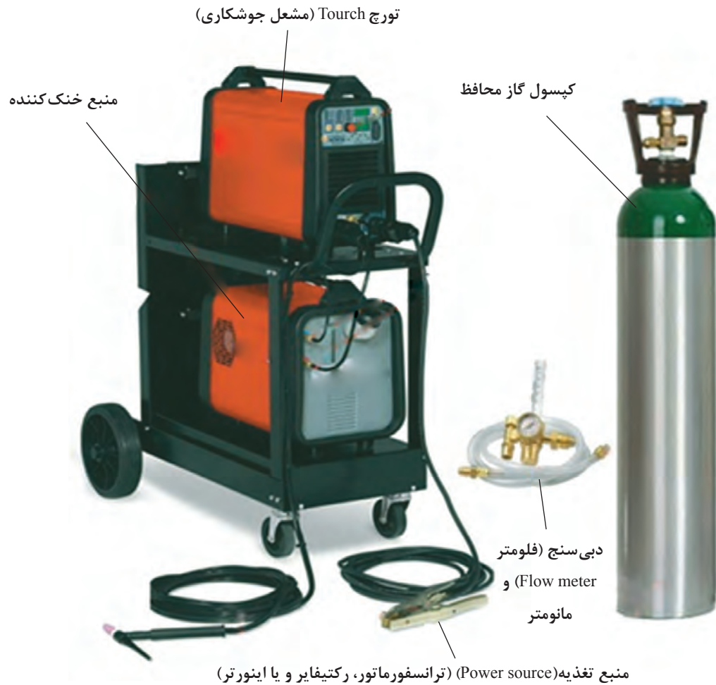
شکل ۲- تجهیزات فرآیند GTAW
