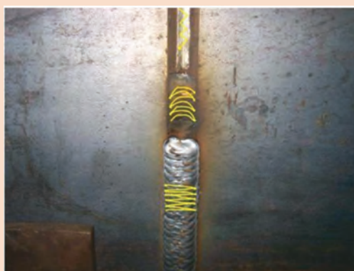
شکل ۲۶- زاویه تورچ و جهت حرکت آن برای انجام پاس سوم
