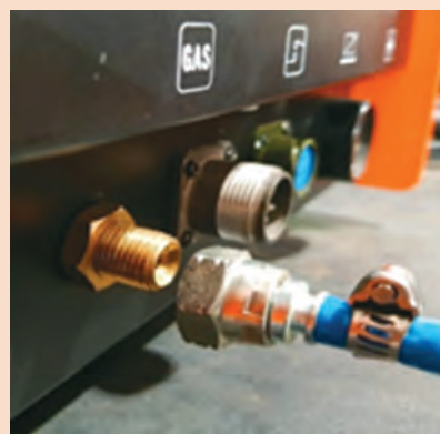
شکل ۶- نصب اتصال گاز محافظ
