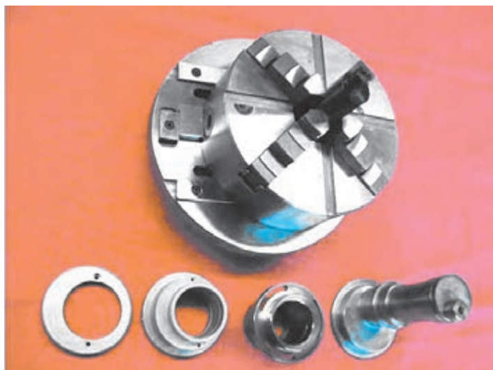
شکل ۱۷- سه‌نظام قابل تنظیم و قطعات تولید شده
