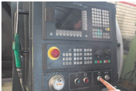
شکل ۱۹- روشن کردن سیستم هیدرولیک دستگاه
