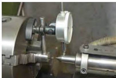
شکل ۳۰- اندازه‌گیری انحراف مرغک
