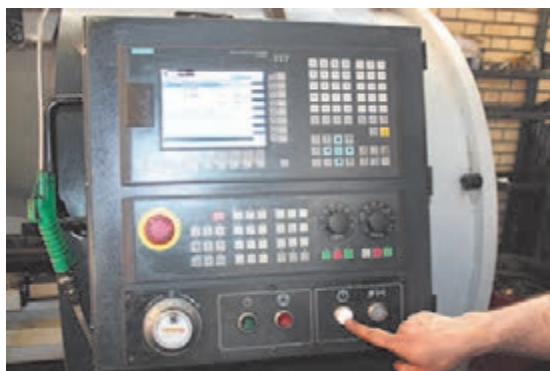
شکل ۲۱- زدن مجدد کلید سیستم هیدرولیک
