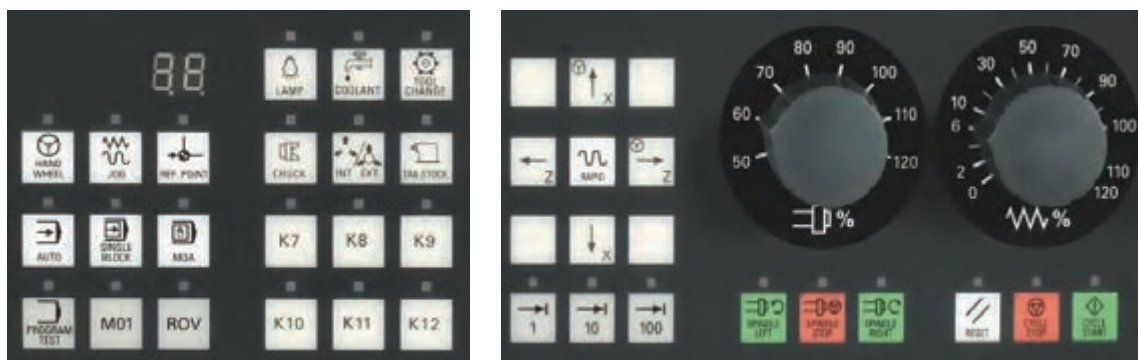
شکل ۱۷- کلیدهای اپراتوری سیستم کنترل
