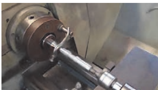
شکل ۲۰ - لنگ تراشی بین دو مرغک
