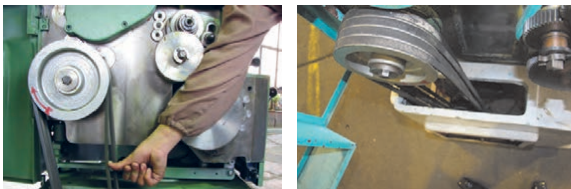
شکل ۳۵- اجزای انتقال حرکت از موتور به جعبه دنده اصلی
