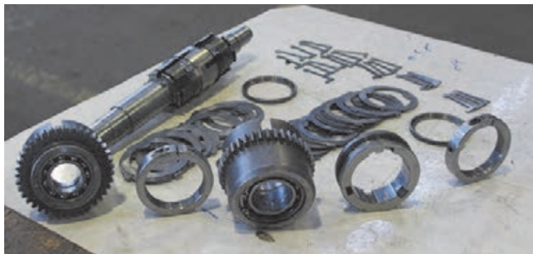
شکل ۴۰- اجزای مجموعه کلاچ
