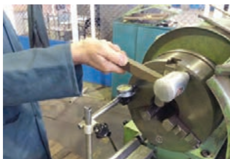
شکل ۷- اندازه‌گیری میزان لقی محوری
