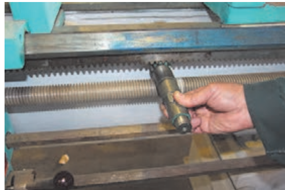
شکل ۱۵- درگیری چرخ دنده با دنده شانهای
