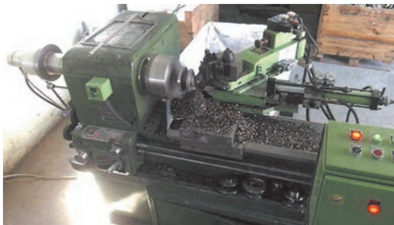
شکل ۷- عملیات کپی تراشی
