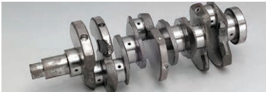
شکل ۱۶- میل لنگ آهنگری شده-محصول نهایی
