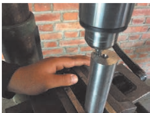
شکل ۲۳ - مته‌مرغ‌ک‌زنی به وسیله ماشین مته ستونی
