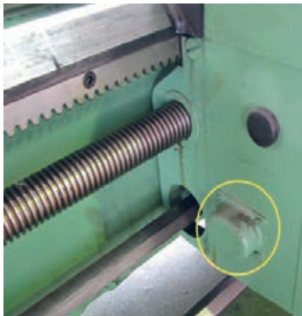
شکل ۲۰- پیچ تنظیم حساسیت اهرم‌های خودکار
