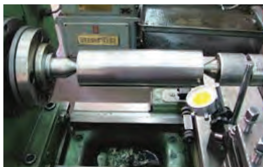
شکل ۲۷- اندازه‌گیری انحراف دستگاه مرگک
