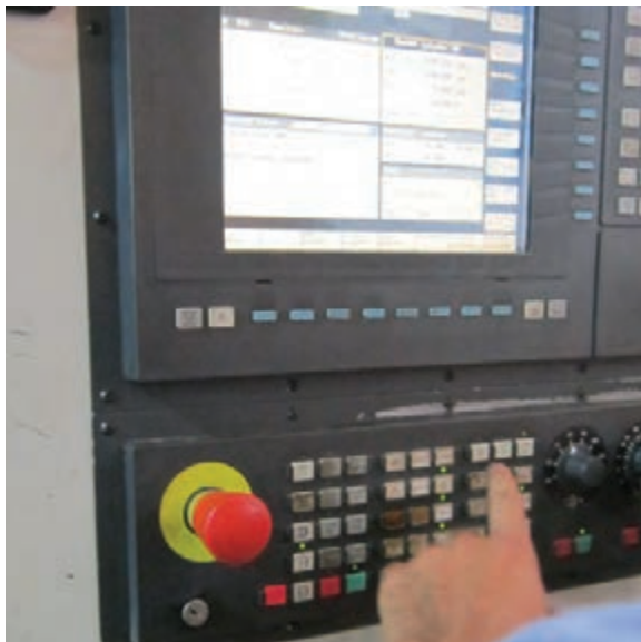
شکل ۲۴- زدن کلید TURRET
