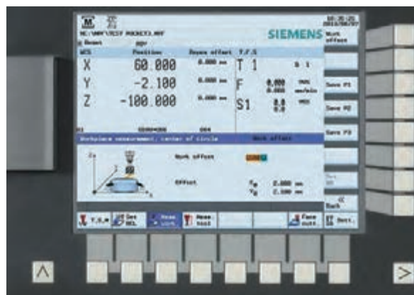
شکل ۱۵- کلیدهای قسمت برنامه‌نویسی سیستم کنترل
