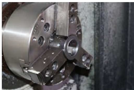
شکل ۹- استقرار سه‌نظام روی مجموعه محور اصلی
