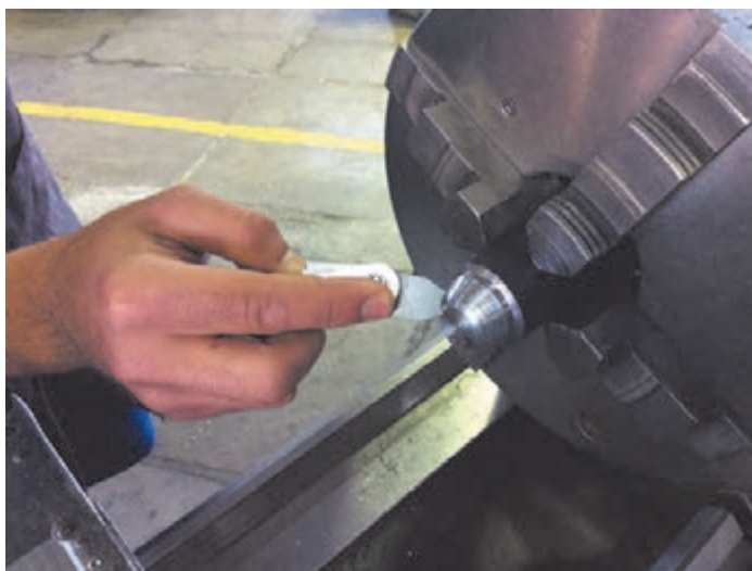
شکل ۱۲- کنترل فرم به وسیله شابلون
