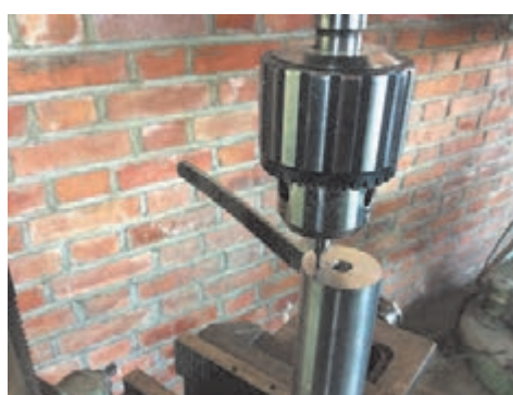
شکل ۲۳ - مته‌مرغ‌ک‌زنی به وسیله ماشین مته ستونی
