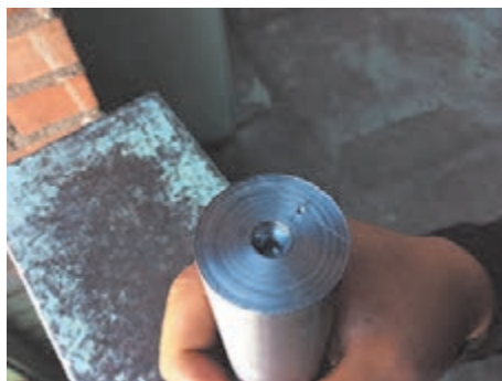
شکل ۲۲ - سنبه‌نشان‌زدن پیشانی قطعه کار
