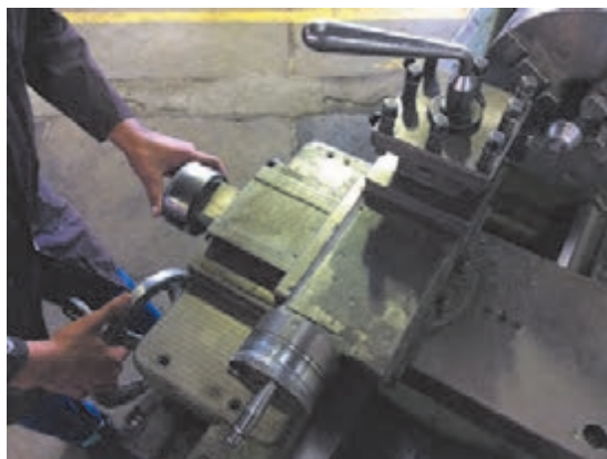
شکل ۱۰- حرکت همزمان سوپرت‌های دستگاه
