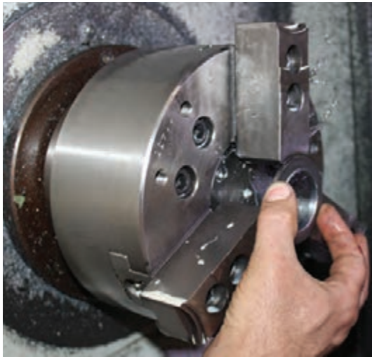
شکل ۳۰- بستن قطعه کار روی سه نظام
