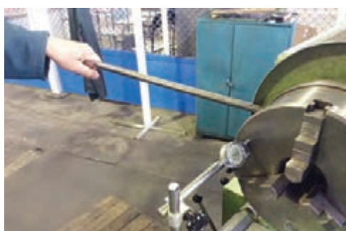
شکل ۷- اندازه‌گیری میزان لقی محوری
