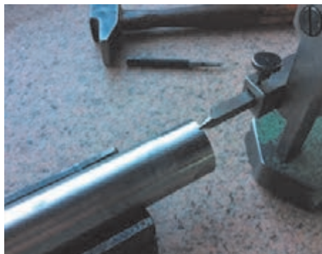
شکل ۲۱ - خط‌کشی و تعیین مراکز لنگ
