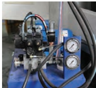
شکل ۱۱- سیستم هیدرولیک ماشین تراش CNC مدل ۴۰ TME
