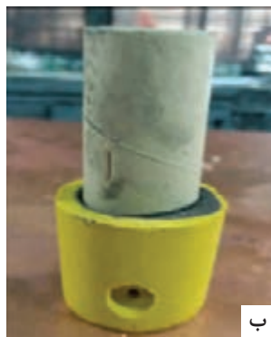
شکل ۵- انواع نمونه گیر الف) نمونه گیر دائم (قالب فلزی) ب) نمونه گیر موقت (از جنس ماسه چراغی)
