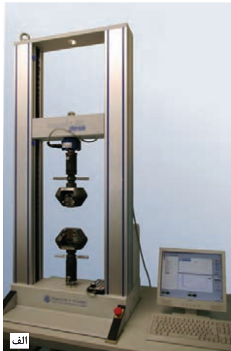
شکل ۱- الف) دستگاه تست کشش ب) نمونه مورد آزمایش در دستگاه کشش (قبل و بعد از کشش)
