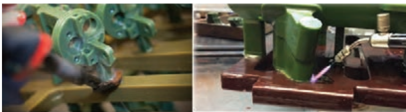
شکل ۲۲- کاردک و مشعل جهت مونتاژ کردن مدل‌های مومی
