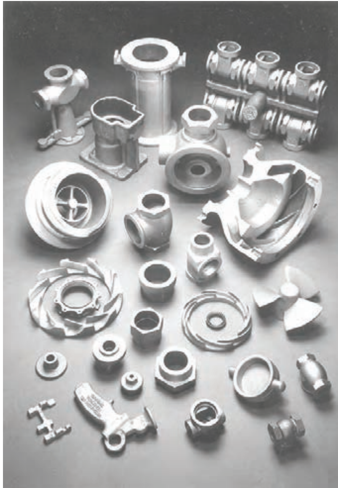
شکل ۲- بعضی از قطعات تولید شده با روش قالب گیری پوسته‌ای
