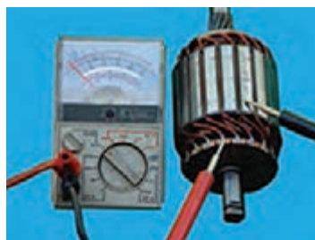
- آزمایش اتصال بدنه آرمیچر
