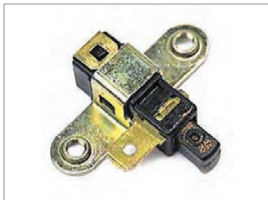
شکل ۲۴- میکروسوییچ ترمز دستی و محل بستن آن
