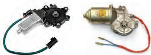
شکل ۴- دو نوع موتور شیشه بالابر
