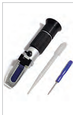
رفلکتومتر، اندازه‌گیری جرم حجمی الکترولیت
