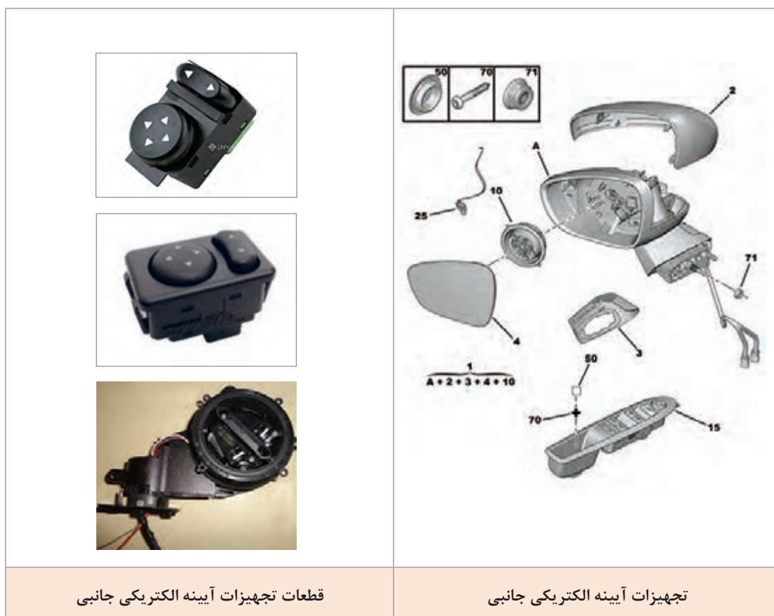
شکل ۱۱- نمونه تجهیزات مربوط به آینه جانبی الکتریکی
