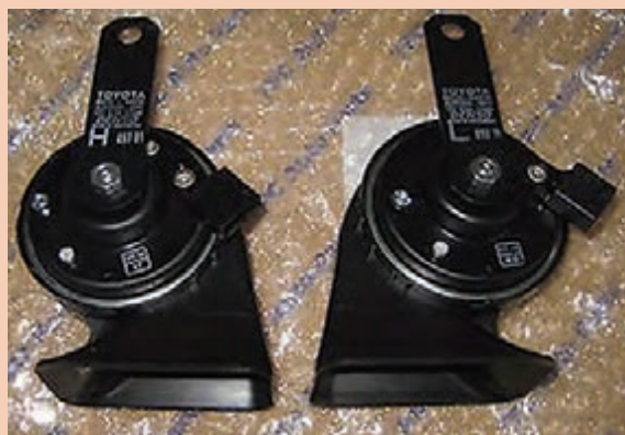
شکل ۴۸- درج L و H روی دستگاه بوق
