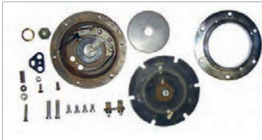
شکل ۴۵- اجزای داخلی بوق الکترومغناطیسی
