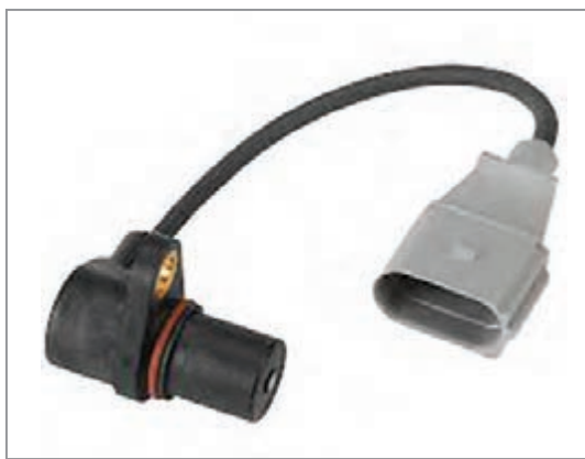
شکل ۱۸- حسگر دور موتور و محل بستن آن
