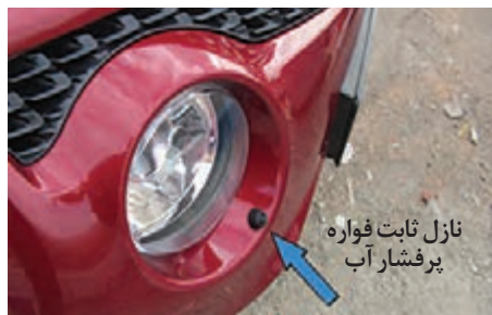
شکل ۱۹- روش های تمیز کردن چراغ
