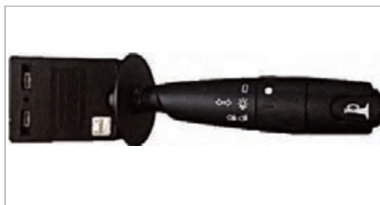
مدل بسته شده روی دسته کنترل چراغ‌ها
