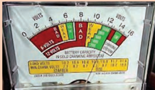
شکل ۵۱- نشان دهنده دستگاه آزمایش باتری
