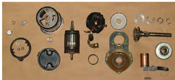
شکل ۹۷- اجزای استارت تر از نوع بالشتک با آهنربای دائم
