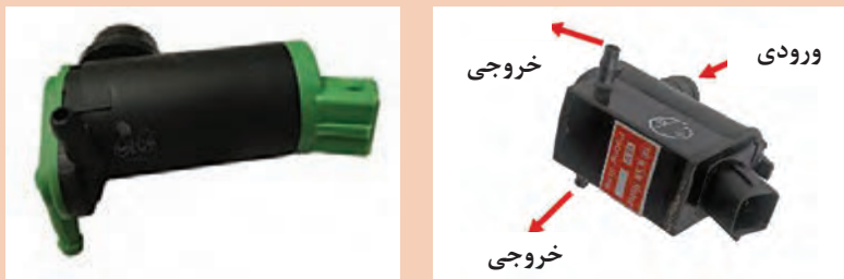
شکل ۱۷- دو نوع موتور پمپ شیشه شوی
