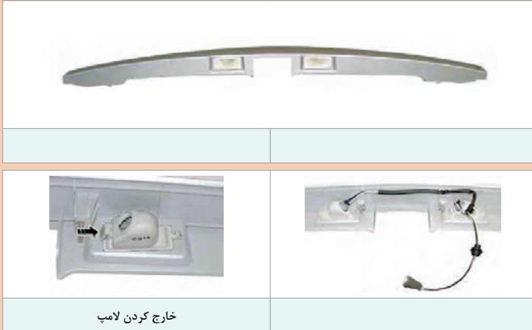
شکل ۳۵- روش باز کردن و بستن چراغ پلاک
