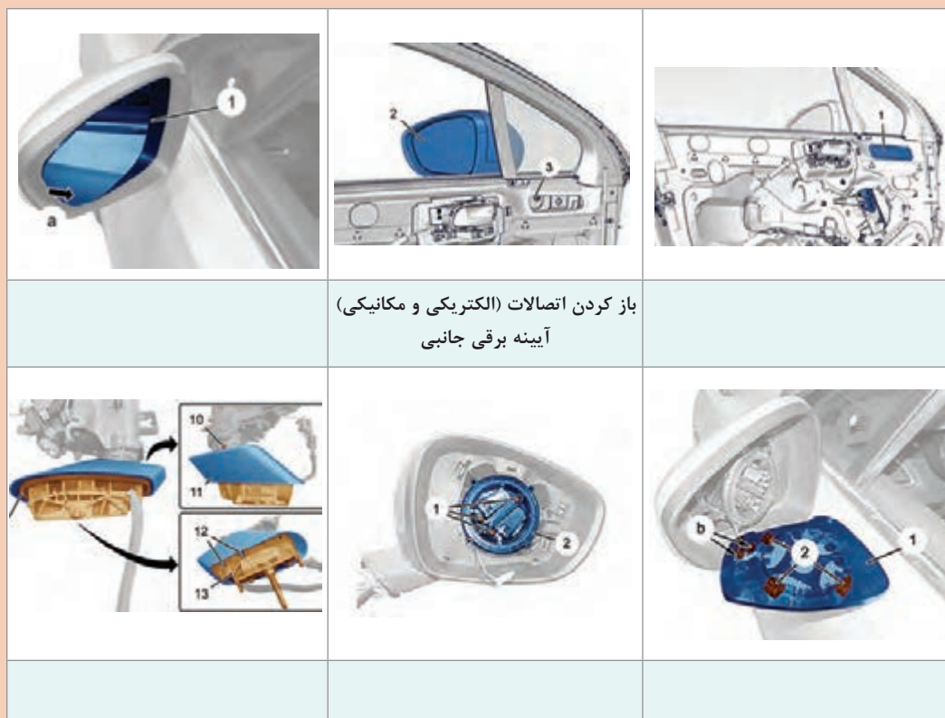
شکل ۲۰- نکات مهم باز کردن، بررسی و بستن مجموعه آئینه جانبی الکتریکی
