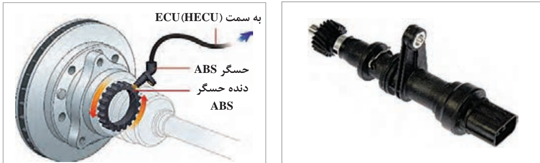
شکل ۱۶- حسگر سرعت خودرو از نوع القایی
