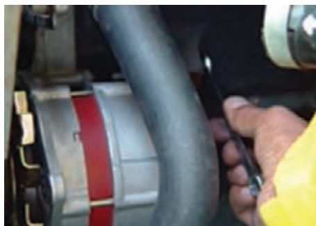
بازکردن پیچ‌های پایه آلترناتور
