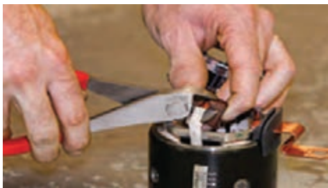
شکل ۹۹ – برخی نکات لحیم کاری زغال‌های استارتر
