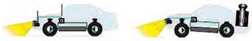
شکل ۹- دلیل نیاز به سیستم تنظیم ارتفاع چراغ
