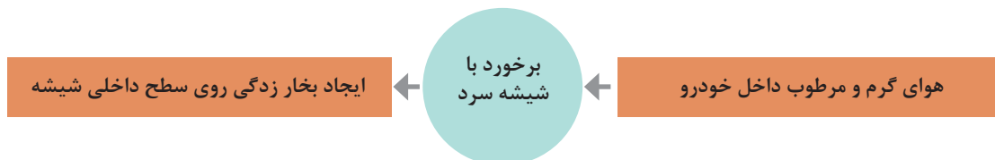
شکل ۳۲- فرایند بخار زدگی شیشه‌ها
