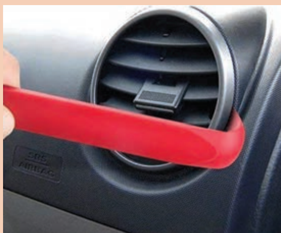
شکل ۲۱- چند نوع ابزار مخصوص تریم
