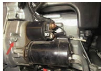
باز کردن پیچ‌های اتصال استارتر به موتور
