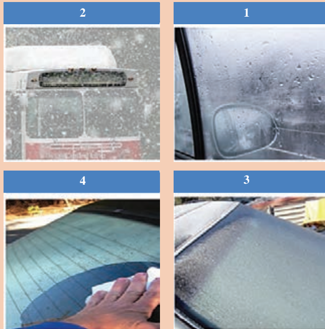
شکل ۳۱- بخار گرفتگی روی شیشه‌ها
