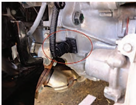
شکل ۱۸- حسگر دور موتور و محل بستن آن
