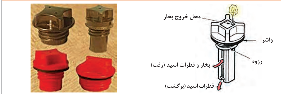
انواع در خانه باتری استاندارد و LM
