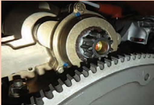
شکل ۱۰۰-ارتباط دنده فلاپیول با دنده استارتر
