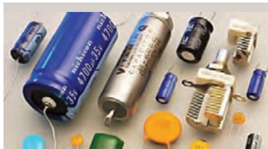
شکل ۱۸- چند نمونه خازن
