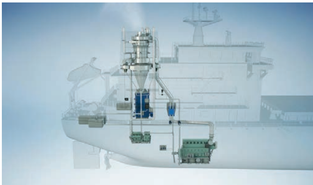
شکل ۲۶- نمایی از سامانه تخلیه دود یک کشتی
