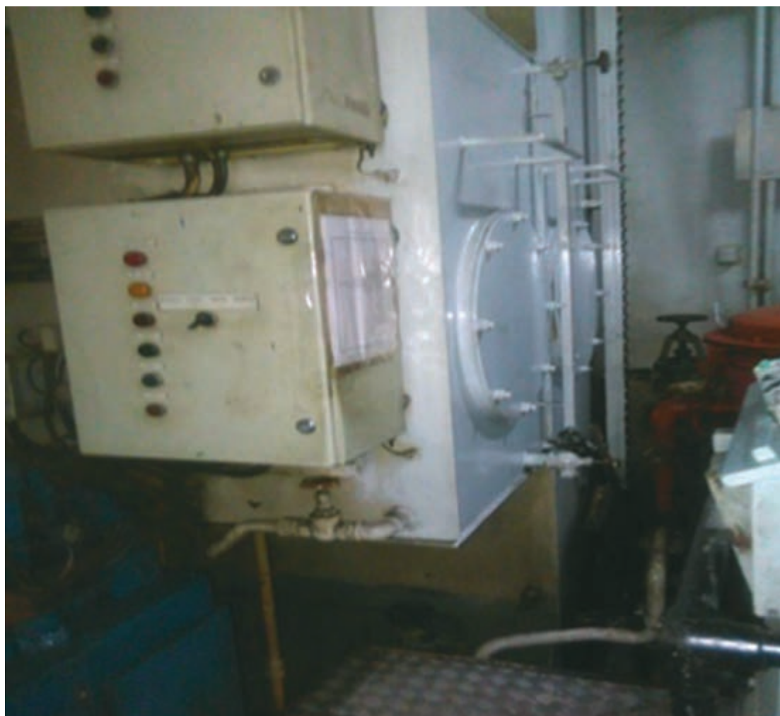
شکل ۲۳- مخزن سوخت روزانه یک شناور
