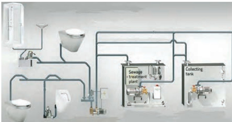
شکل ۱۴- نمودار سامانه دفع فاضلاب یک کشتی
