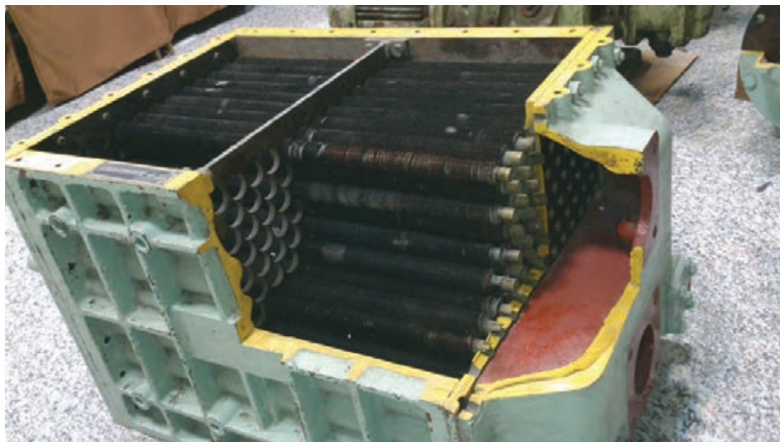
شکل ۲- کولر هوای یک موتور دیزل
