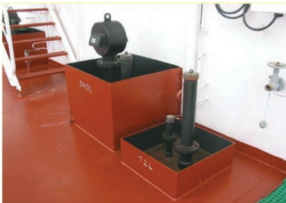
شکل ۲۵- سامانه هوا و اندازه‌گیری مخزن یک کشتی
