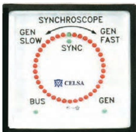
شکل ۲۰- سنکروسکوپ و مدار یک سنکروسکوپ ساده
