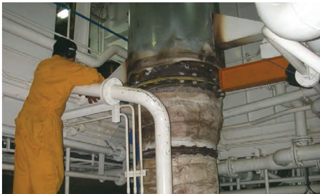
شکل ۲۷- سامانه تخلیه دود یک کشتی
