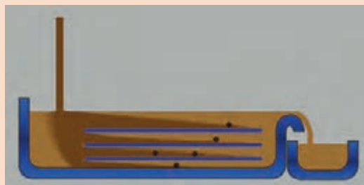
شکل ۲۰- نحوه قرار دادن صفحات موازی درون فیلتر
