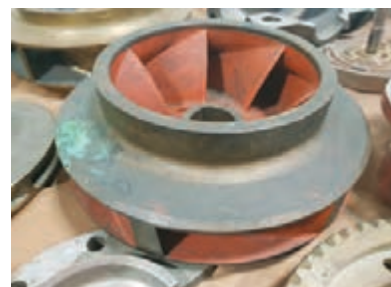
شکل ۳۶ ب) - پروانه بسته
