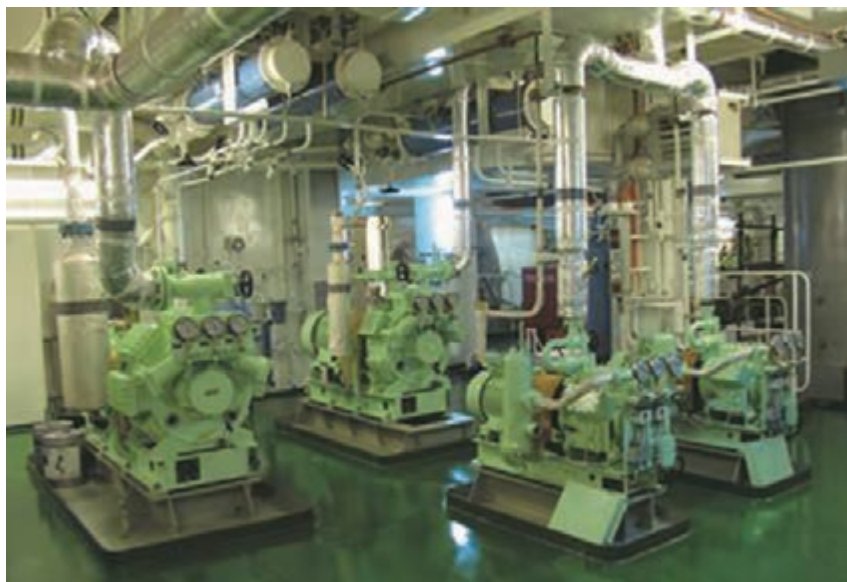
شکل ۱۹- کمپرسورهای هوا در ساختمان کشتی
