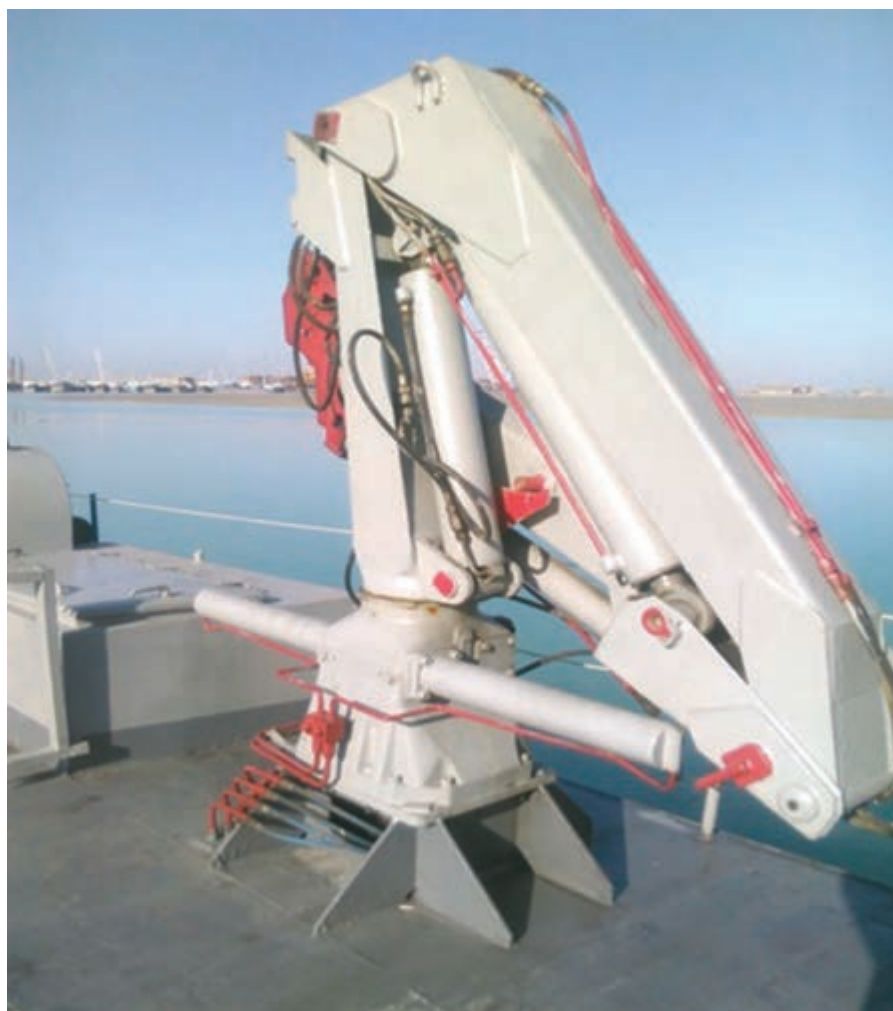
شکل ۲۲- جک هیدرولیکی بر عرشه یک شناور
