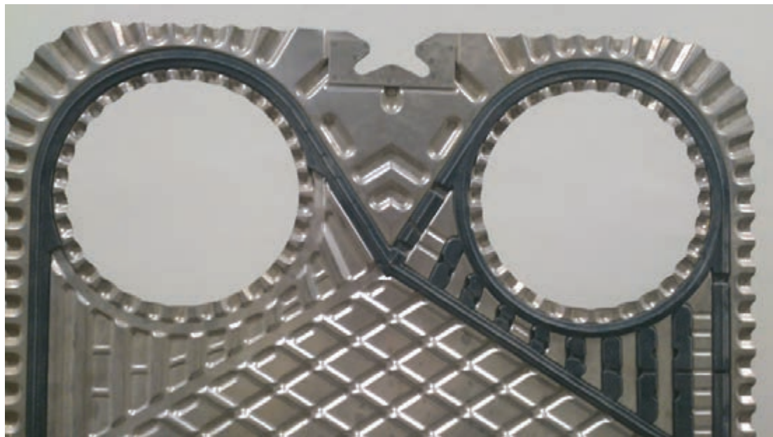
شکل ۱۲ - نوار آب‌بندی ورود و خروج سیال
