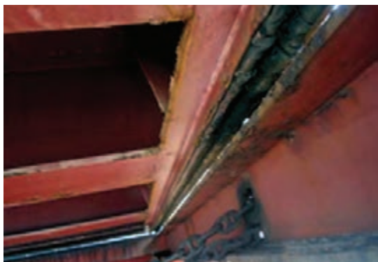
شکل ۴- لاستیک اطراف درِ انبار که له شده است و باید تعویض شود.
