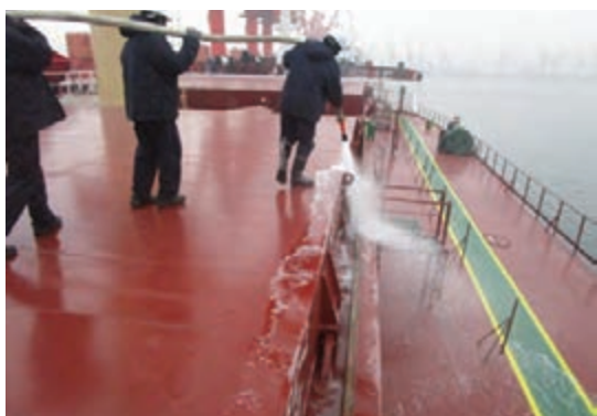
شکل ۵- آزمایش نفوذ ناپذیری در انبار در برابر آب
