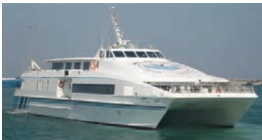
شکل ۱۵- یک شناور کاتاماران با بدنه آلومینیومی
