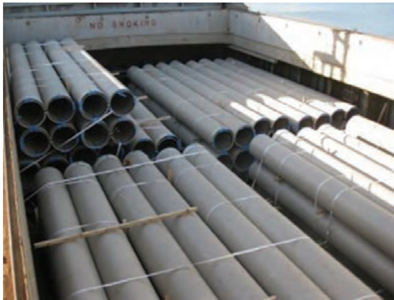
شکل ۱- بارچینی و مهار کالا در انبار یک کشتی
