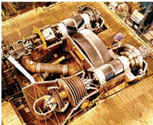
شکل ۲۱- توربین بخار به همراه جعبه‌دنده
