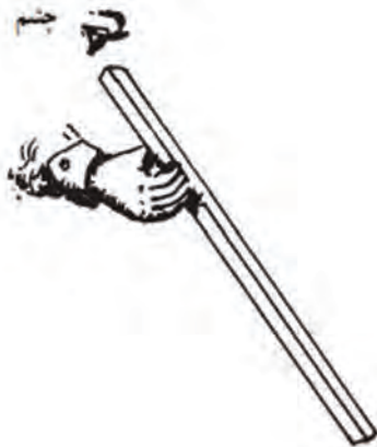
شکل ۴-۴. قرار دادن چشم در دو طرف شمشه به منظور کنترل صاف بودن
