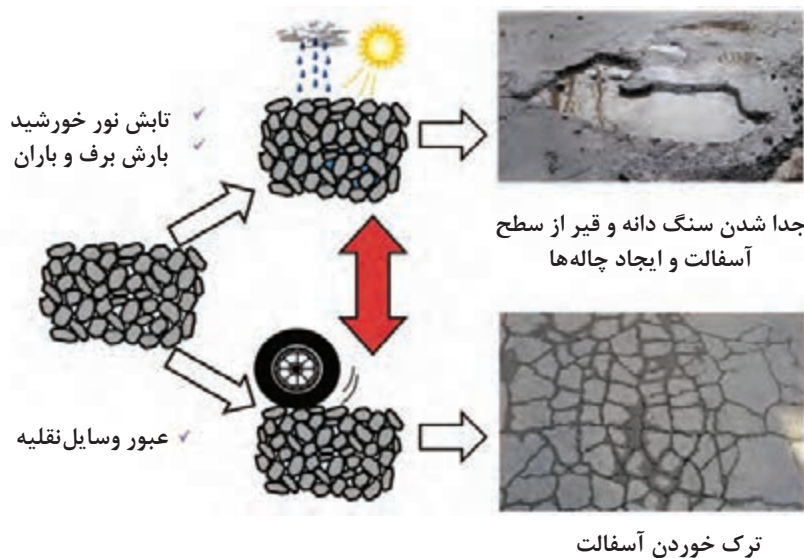
شکل ۱۹- اثر عوامل مختلف بر خرابی آسفالت
