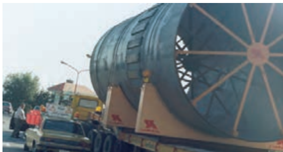
شکل ۱۱- نمونه‌ای از قید گهواره‌ای (زین)
