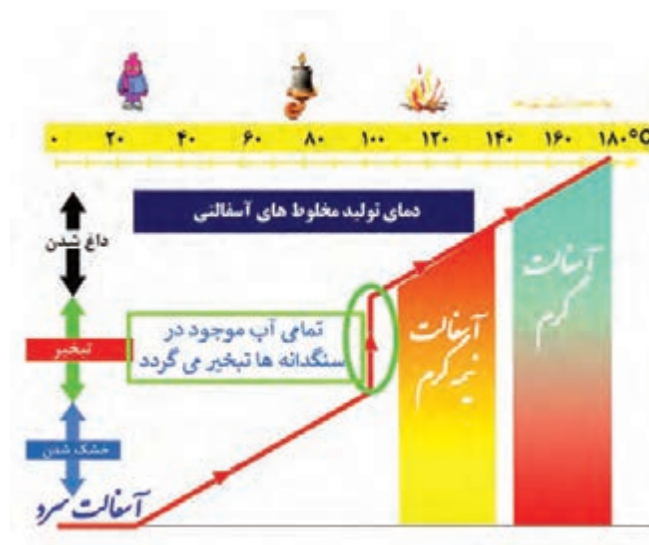
شکل ۲۷- دسته‌بندی آسفالت براساس دمای تولید آسفالت
