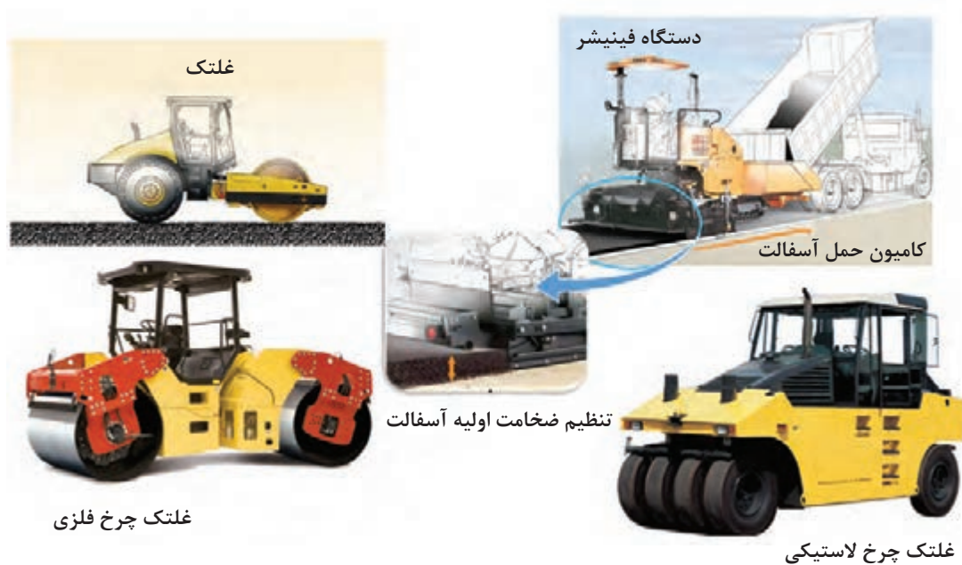
شکل ۳۲ - تجهیزات پخش و تراکم آسفالت
