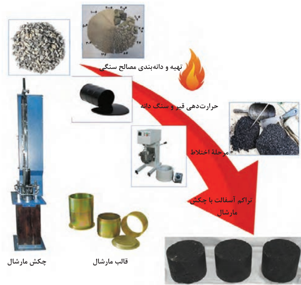
شکل ۲۹- فرایند تولید آسفالت در آزمایشگاه
