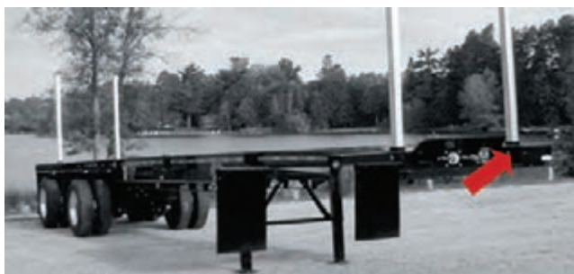
شکل ۲۰- قرار گرفتن ستون‌ها در جاستون‌ها روی کفی
