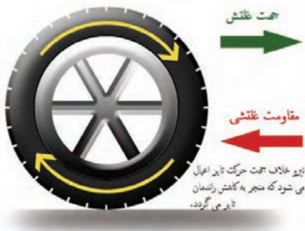
شکل ۱- جهت غلتش تایر و مقاومت غلتشی
