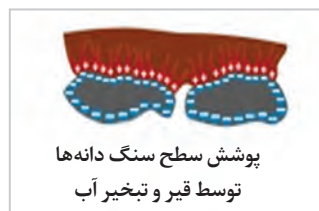
شکل ۲۵- فرایند شکستن قیرابه در زمان اختلاط با سنگ دانه ها
