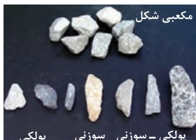
شکل ۶- انواع سنگ دانه‌ها از لحاظ شکل ظاهری
