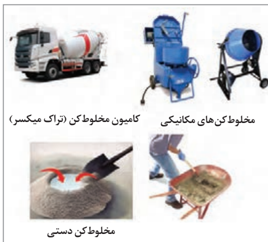
شکل ۱۳- انواع روش های اختلاط بتن
