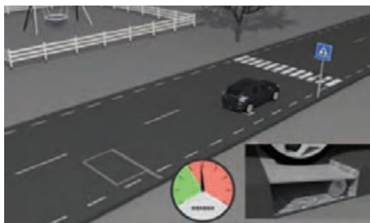
شکل ۳- تغییر شکل سرعت‌گیر بر حسب سرعت نزدیک شدن خودرو
