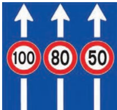
شکل ۳۴- تابلوی حداکثر سرعت در آزاد راه
