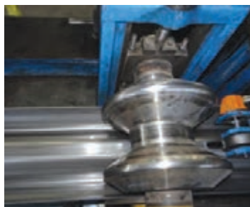
شکل ۴- ساخت و تولید گاردریل به روش نورد
