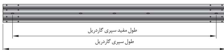
شکل ۶- طول سپری گاردریل و طول مفید آن
