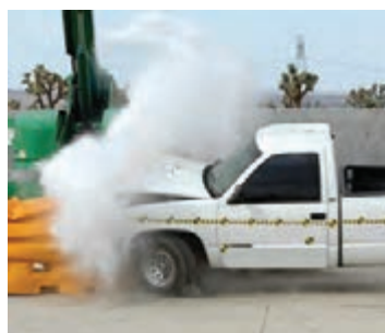
شکل ۱۲- تخریب ضربه‌گیرهای وزنی بشکه‌ای بعد از برخورد
