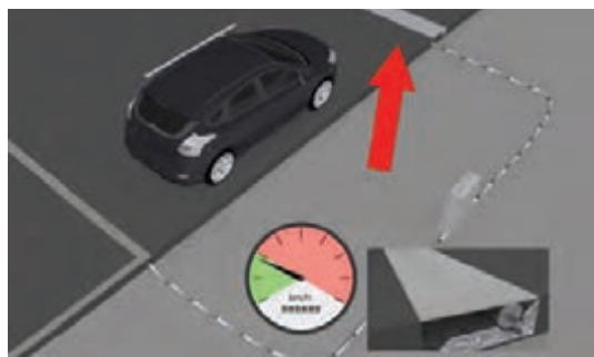
شکل ۳- تغییر شکل سرعت‌گیر بر حسب سرعت نزدیک شدن خودرو
