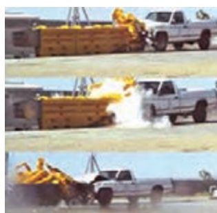
شکل ۱۱- عملکرد ضربه‌گیر وزنی بشکه‌ای شکل در هنگام برخورد
