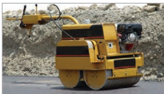
شکل ۴۱- غلتک دستی برای تراکم آسفالت
