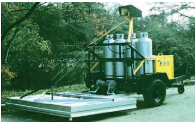
شکل ۴۷ - تجهیزات صفحه گرمکن
