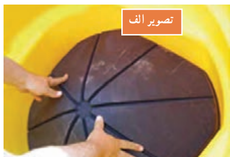
شکل ۲۲- چیدمان بشکه‌ها و قرار دهی مخروط درونی
