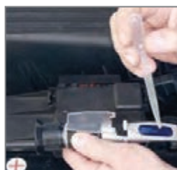
شکل ۱۰- اندازه گیری الکترولیت باتری
