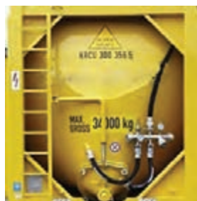
شکل ۲۹- شیرهای اهرمی و مدخل خروجی کانتینر
