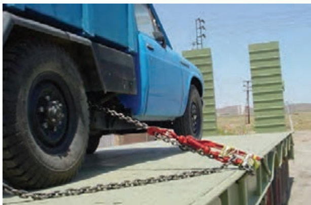
شکل ۲۲- نمونه‌ای از مهار نادرست یک اتومبیل
