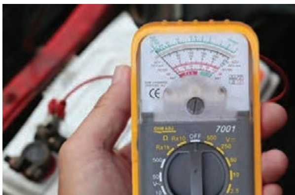
شکل ۴۰- تست باتری
