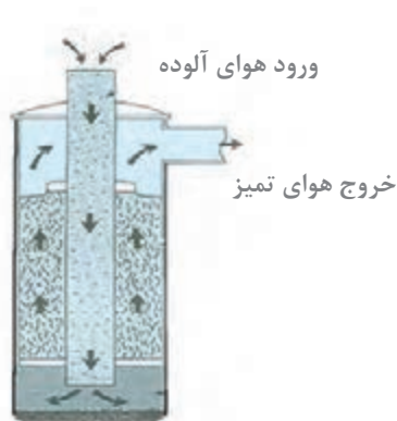
مکانیزم تصفیه هوا توسط فیلتر هوای روغنی
