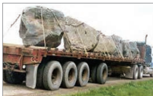
شکل ۱۶- نمونه‌ای از مهار صحیح سنگ‌ها
