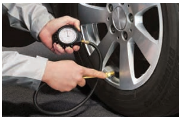
شکل ۱۰- اندازه‌گیری و تنظیم فشار باد تایر
