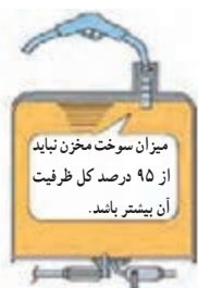
شکل ۲۲- پر کردن مخزن سوخت
