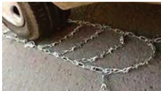
شکل ۱۳- بستن زنجیر چرخ
