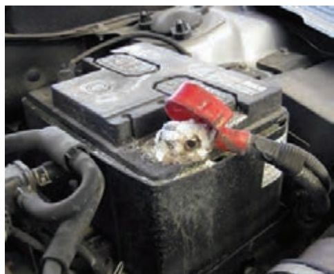
شکل ۴۱- سولفاته کردن قطب باتری
