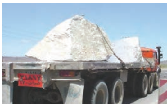
شکل ۱۷- نمونه‌ای از مهار نادرست سنگ‌ها
