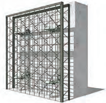
پانل فلزی در سیستم شبکه‌ای داربستی
