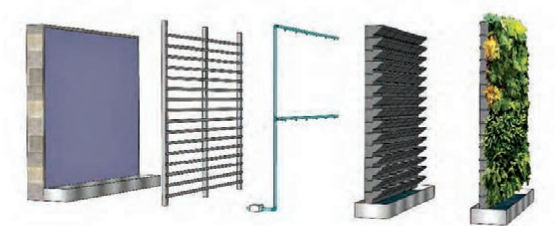
نحوه اتصال گلدان‌های کاشت روی شبکه‌های فلزی
