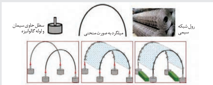
مراحل ساخت تونل سبز توسط شبکه‌های سیمی
