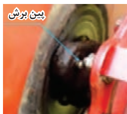
شکل ۱۱- پین برشی و کلاچ ایمنی در دستگاه بسته‌بند
