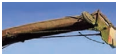
شکل ۵۸- حرکت عمودی کلاهک لوله تخلیه
