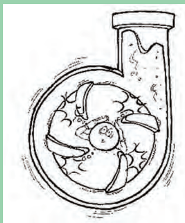
شکل ۱۵- کاویتاسیون در پروانه پمپ
