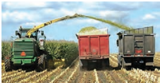
شکل ۴۴- برداشت ذرت به وسیله چابر خودگردان
