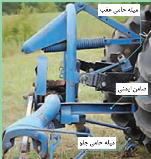
شکل ۲۱- نحوه اتصال دروگر شانه‌ای به تراکتور
