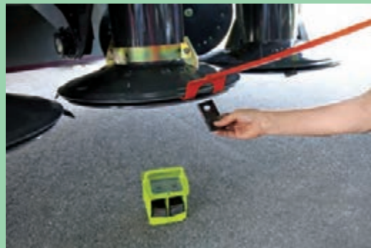
شکل ۲۰- نحوه تعویض تیغه در دروگر استوانه‌ای
