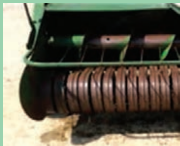
شکل ۲۱- تنظیم ارتفاع واحد بردارنده به کمک اهرم و پیچ تنظیم ارتفاع
