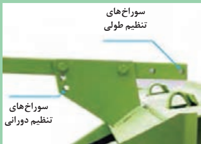
شکل ۵۱- هدایت کننده علوفه و پیچ‌های تنظیم آن
