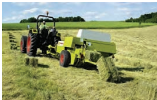
الف) رها کردن بسته روی زمین
