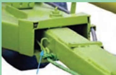
شکل ۷۰- طناب آزادکننده پین
