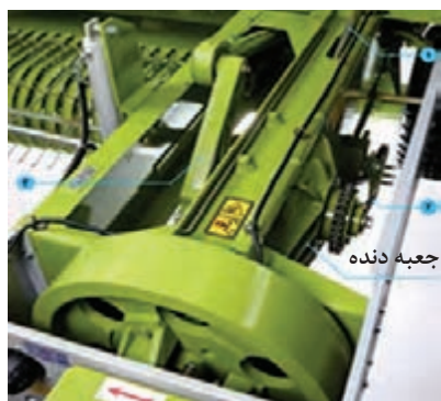
شکل ۱۲- مسیر انتقال توان در دستگاه بسته‌بند
