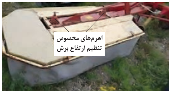
شکل ۲۸- اهرم‌های مخصوص تنظیم ارتفاع برش
