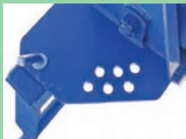
شکل ۱۳- صفحه سوراخ دار روی شاسی شانه خورشیدی
