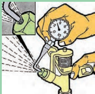
شکل ۲۱- اندازه گیری با فشارسنج بوردون
