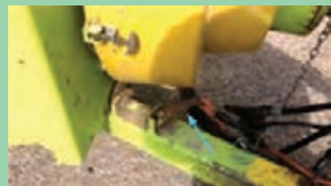
شکل ۱۶- پین تغییر وضعیت دستگاه از حالت حمل و نقل به حالت کار و بالعکس
