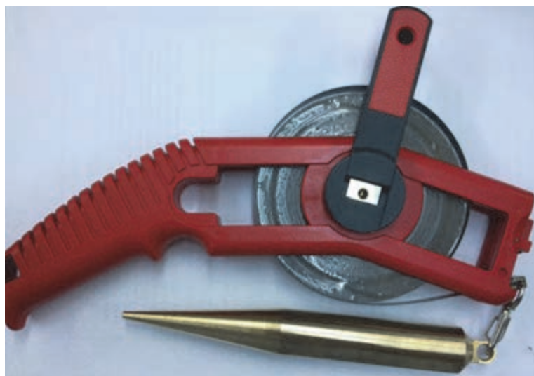
شکل ۳-۶- Sounding tape برای اندازه‌گیری سطح مخزن
