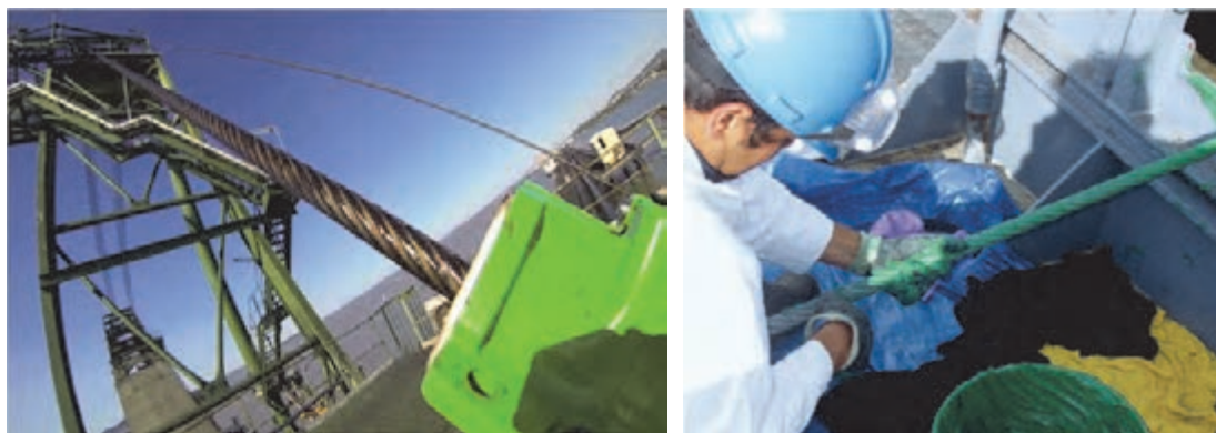
شکل ۲۲-۱ روان کاری طناب سیمی با گریس
