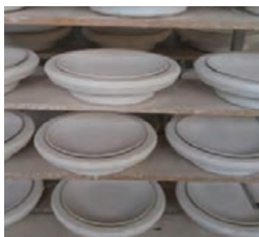
شکل ۳۷- خشک کردن قالب و قطعه در خشک‌کن با دمای ۴۵ درجه سلسیوس
