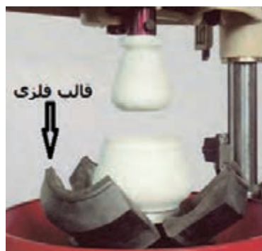
شکل ۹- قالب فلزی چند تکه مورد استفاده در روش جیگر و جولی
