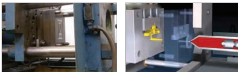
شکل ۲۱- قالب تحت فشار و تزریق
