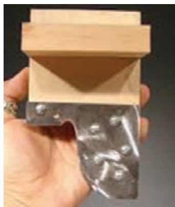
شکل ۱۴- شابلون تقویت شده با چوب
