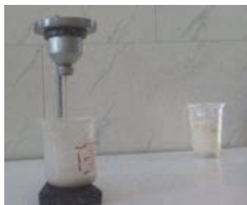
شکل ۹- ویسکوزیمتر ریزشی
