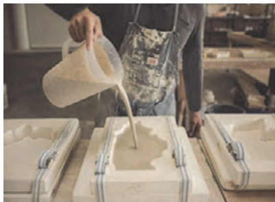
الف) ریخته‌گری دوغابی به روش دستی
