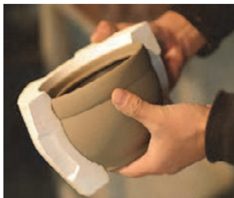
الف- خارج کردن بدنه ریخته‌گری شده
