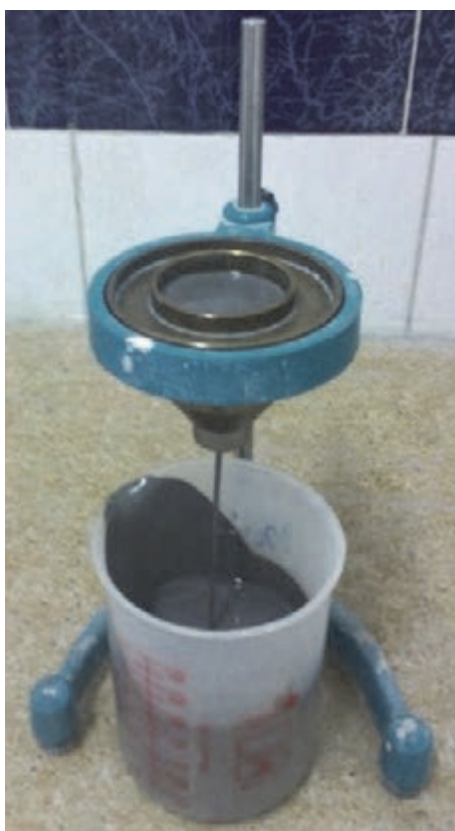
شکل ۸- ویسکوزیومتر ریزشی
