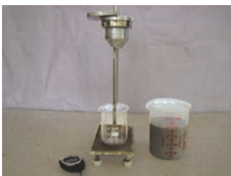
شکل ۱۴- ویسکوزیومتر ریزشی
