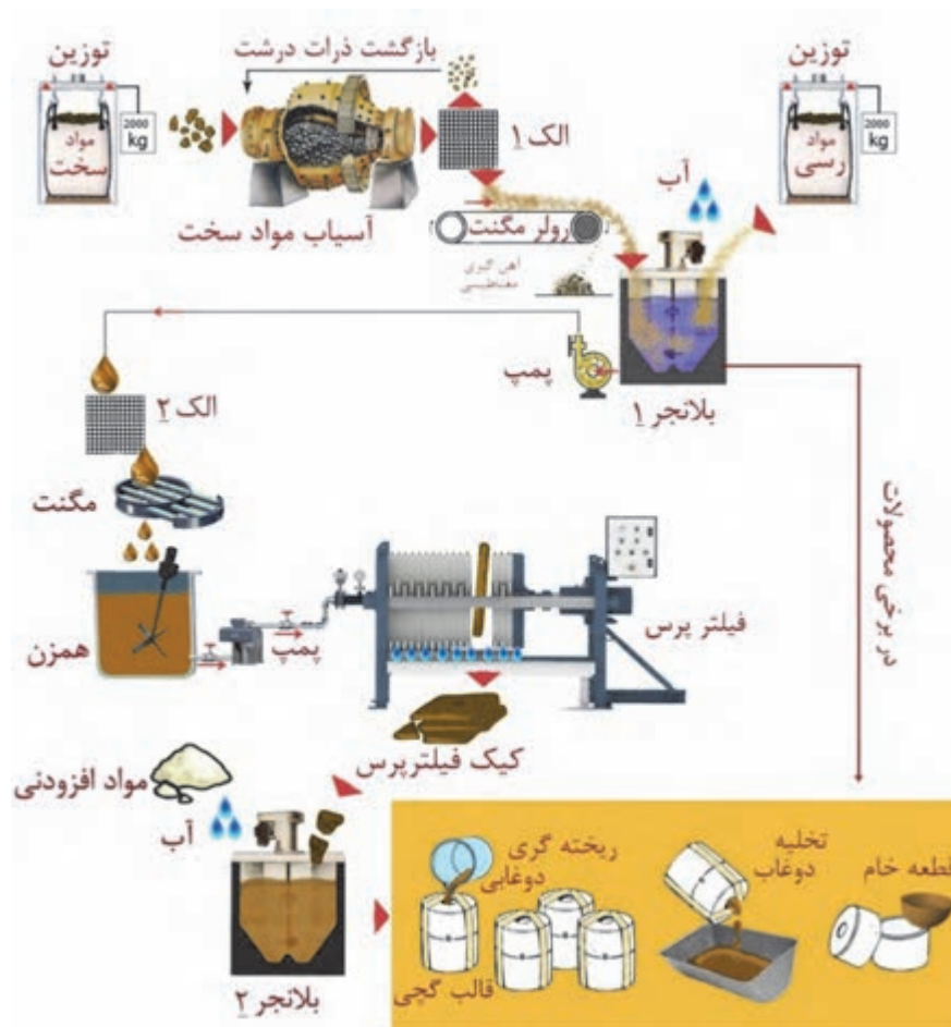
شکل ۱۱- فرایند ساخت دوغاب و شکل‌دهی قطعه
