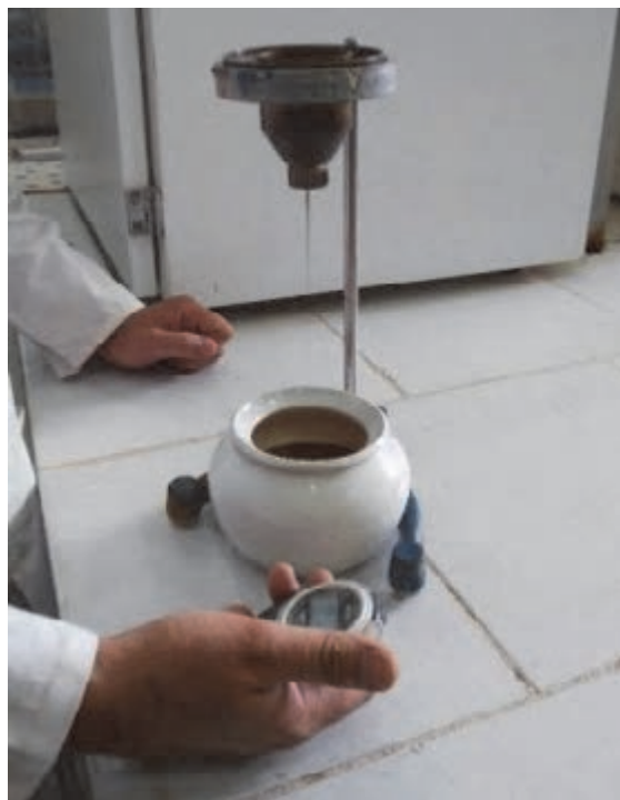
شکل ۱۶- اندازه گیری گرانیروی دوغاب
