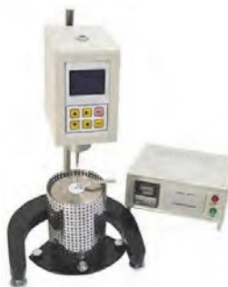
شکل ۱۲- ویسکوزیومتر چرخشی
