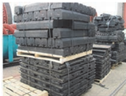
شکل ۲۱- آستر لاستیکی بال میل
