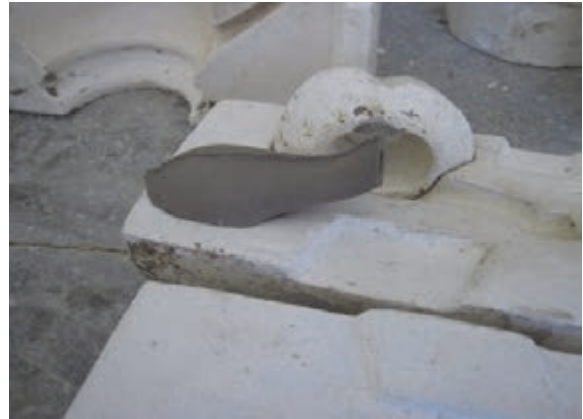
شکل ۴۲- شکل‌دهی جداگانه لوله و بدنه قوری
