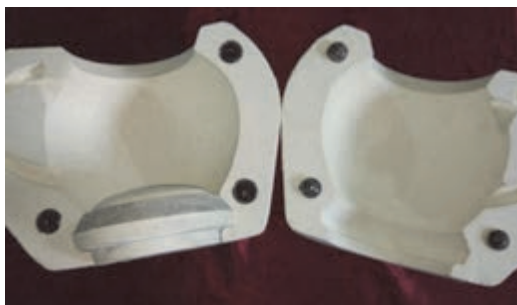
شکل ۲۴- الگوی گچی با زبانه های پلاستیکی
