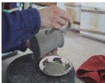
شکل ۴۳- دوغاب با روانی کم برای مونتاژکاری
