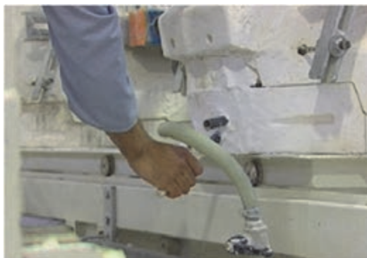
شکل ۳۵- باز کردن لوله‌ها جهت تخلیه دوغاب اضافی
