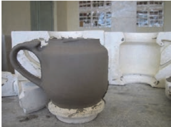
شکل ۴۲- شکل‌دهی جداگانه لوله و بدنه قوری
