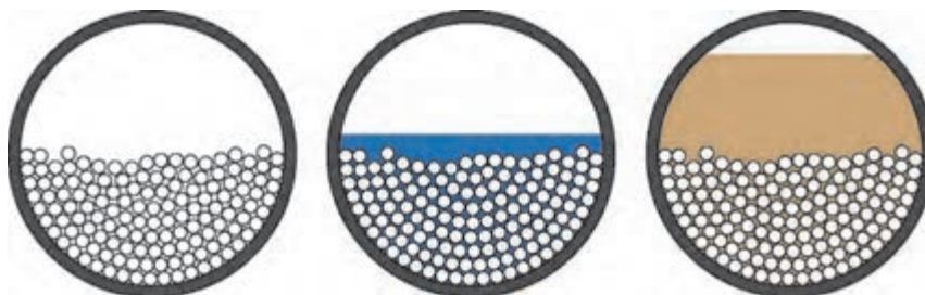
شکل ۱۷- محتویات فضای داخلی بال‌میل
