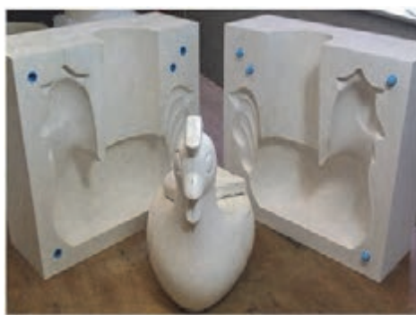
شکل ۶- پین‌های انواع قالب
