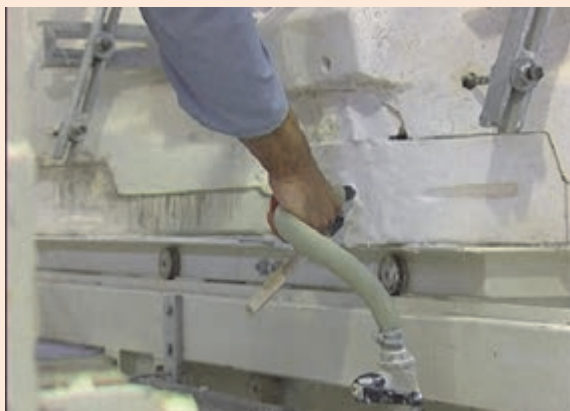
شکل ۲۵- مجرای زیر قالب جهت تخلیه دوغاب
