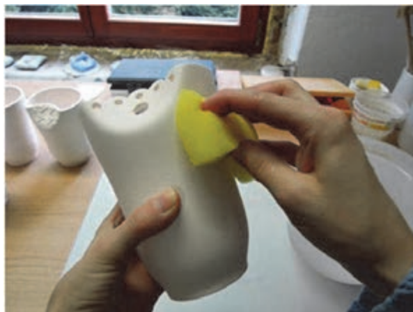
شکل ۳۱- پرداخت بدنه‌های ریخته‌گری دوغابی
