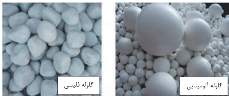
شکل ۱۸- گلوله‌های آلومینایی و فلینتی بال‌میل
