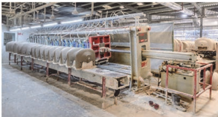
شکل ۶- ریخته‌گری دوغابی با فشار پایین
