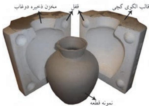
شکل ۱۵- قطعه ریخته گری شده در قالب الگو
