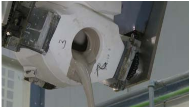
شکل ۲۲- دوغاب هنگام ریخته‌گری
