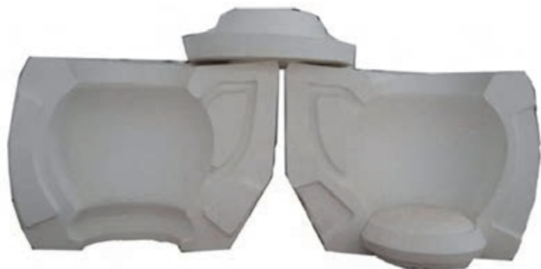
شکل ۲۶- قالب بدنه ی یک قوری
