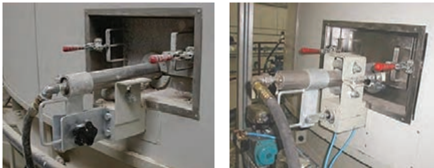
شکل ۳۴- لنس‌های متصل به لوله‌های اسپری درایر (خشک کن پاششی)
