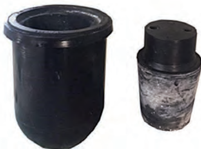
شکل ۱۴- قالب و پانچ پلی‌یورتانی جهت تولید گلوله
