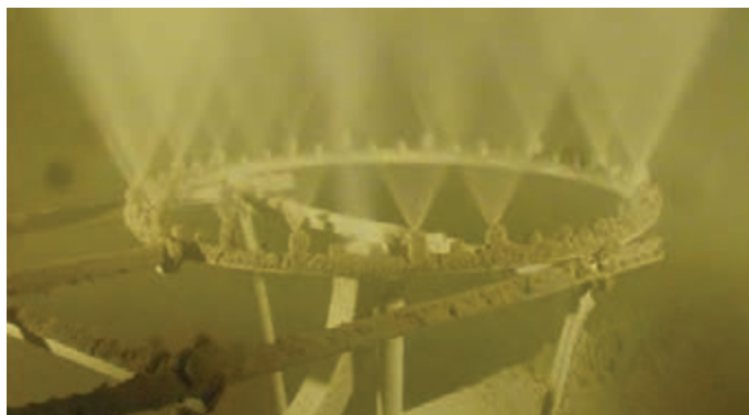
شکل ۲۷- چیدمان چندین افشانک نازلی در یک اسپری درایر (خشک کن پاششی)
