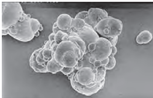
شکل ۵- آگلومره متخلخل با شکل نامنظم و ابعاد حدود ۳۰۰ میکرومتر
