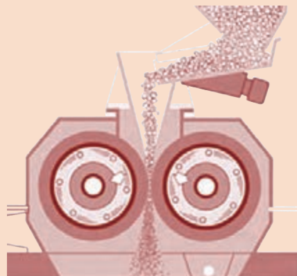
شکل ۳۰- جهت چرخش استوانه‌ها در سنگ‌شکن غلتکی
