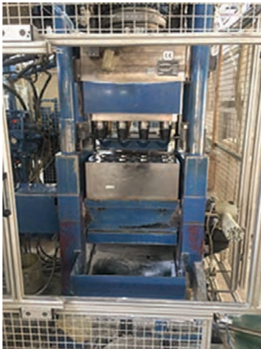
شکل ۱۳- پرس ایزواستاتیک گلوله آلومینایی
