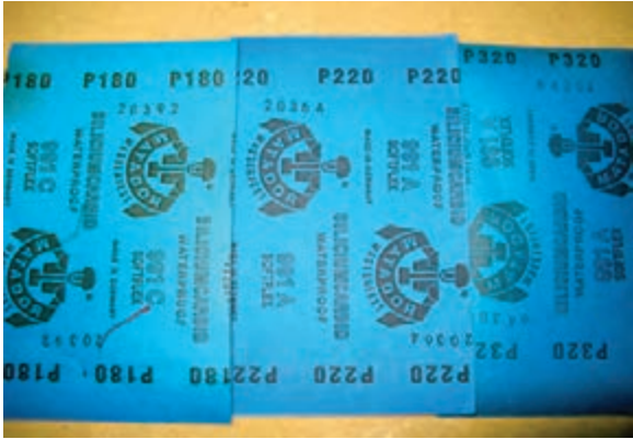
شکل ۱۱-۱۲- پند نمونه سنباده پوست آب با شماره‌های مختلف.
