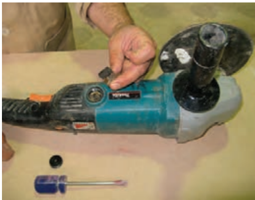
شکل ۳۵-۵- بازدید ذغال دستگاه سنباده دیسکی.
