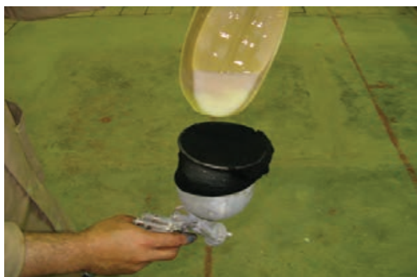
شکل ۵-۹- استفاده از جوراب نازک به عنوان صافی.
