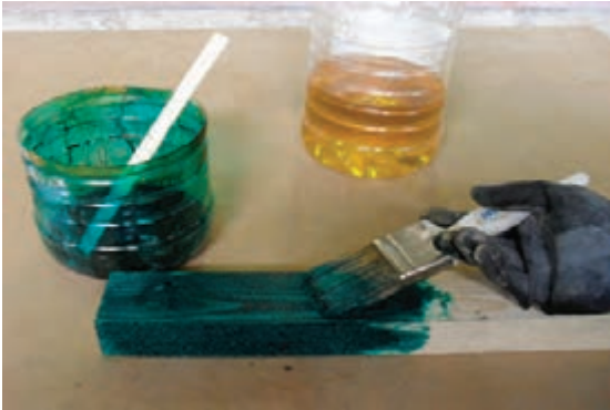
شکل ۵۱-۱۲- زدن استری (وغنی سبز) به سطح کار با قلم‌مو.
