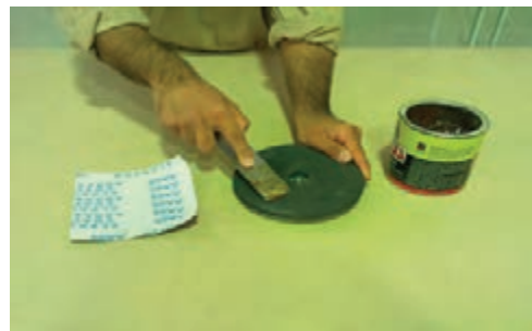
شکل ۵-۲۹- نمونه‌ی زدن چسب فوری به سنباده و صفحه دستگاه.
