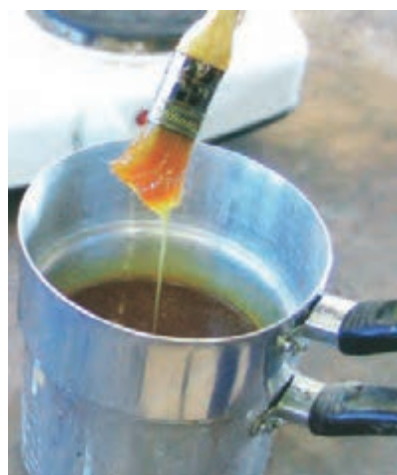
شکل ۷۱-۱۲- ظرف مخصوص برای ذوب کردن لاک که دو طبقه بوده و در اثر حرارت بخار آب لاک ذوب می‌شود.
