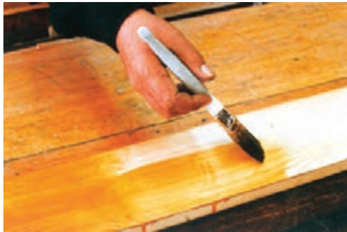
شکل ۳۴-۸- سیلرکاری در جهت الیاف.
