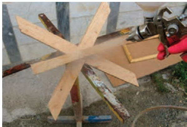
شکل ۲۱-۱۱- زدن روغن جلا (روی سطح نیم پلی استر).
