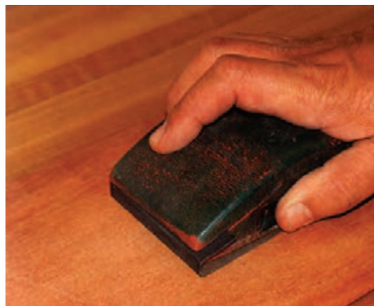
شکل ۲۰-۴- پوست آب کاری به کمک تخته پوست.
