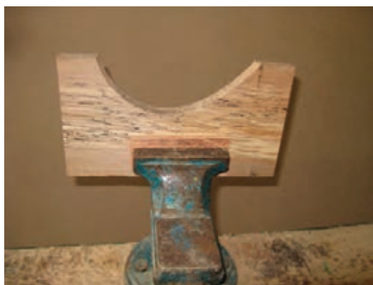
شکل ۱۴-۱۳- سنباده‌کاری یک کار قوس‌دار.
