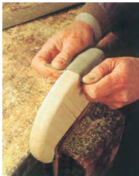
شکل ۲۶-۱۴- سنباده‌کاری (روی سطوح قوس‌دار).
