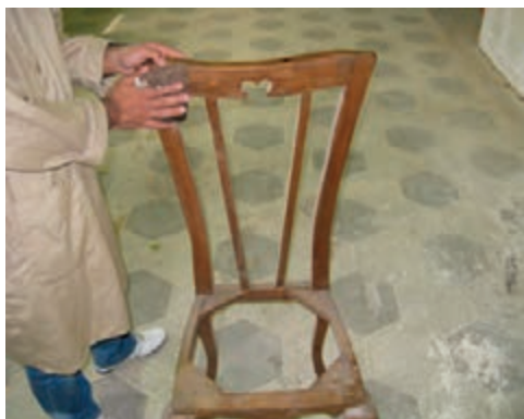
شکل ۵۷-۱۲- گرفتن گردوغبار از سطح کار با پارچه.
