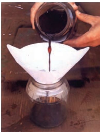
شکل ۳۰-۸- استفاده از صافی برای تهیه یک آستری فالص.
