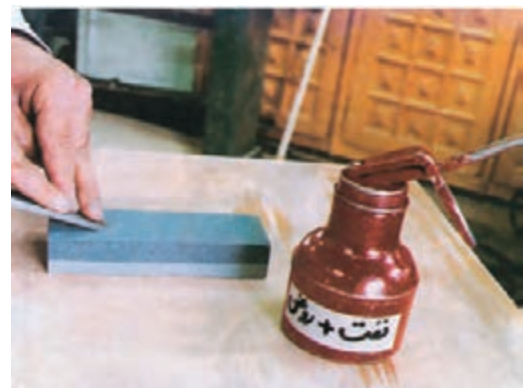
شکل ۳۱-۳- (روغن زدن یا نفت زدن روی سنگ).
