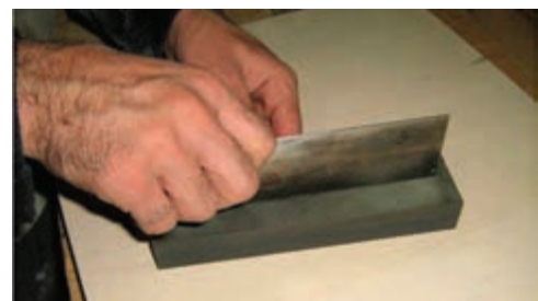
شکل ۳-۴۳- کشیدن لیس روی سنگ نفت.
