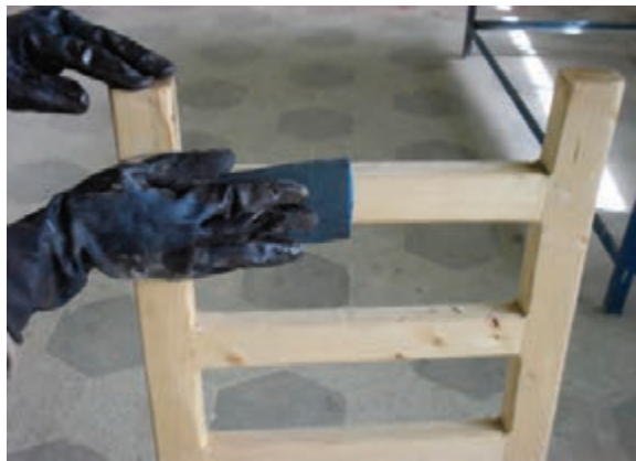
شکل ۶-۱۲- پوست آب کاری روی سطح سیلر فورده.
