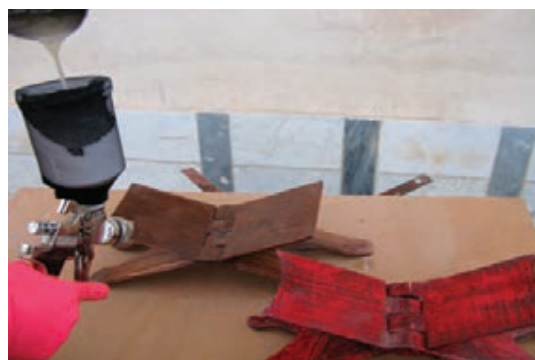
شکل ۴۱-۱۳- سیلرکاری (مل قرآن).
