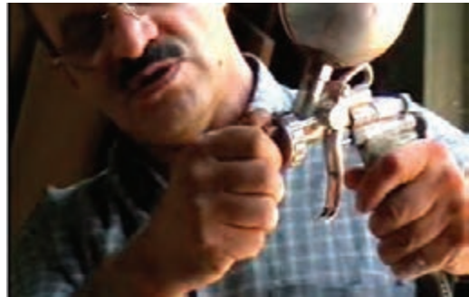
شکل ۲۵-۸- پیچ تنظیم پرده رنگ.
