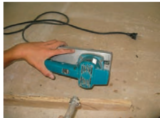
شکل ۲۸-۱۳- گرفتن گردوغبار از روی دستگاه با استفاده از سیستم هوای فشرده.
