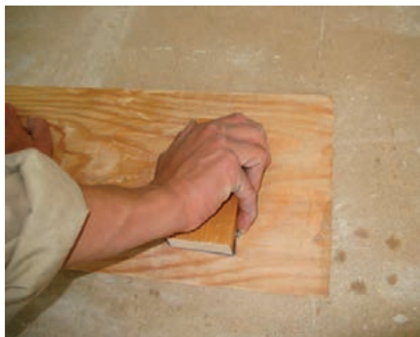
شکل ۱۵-۱۳- سنباده‌کاری در فلاف جهت الیاف.
