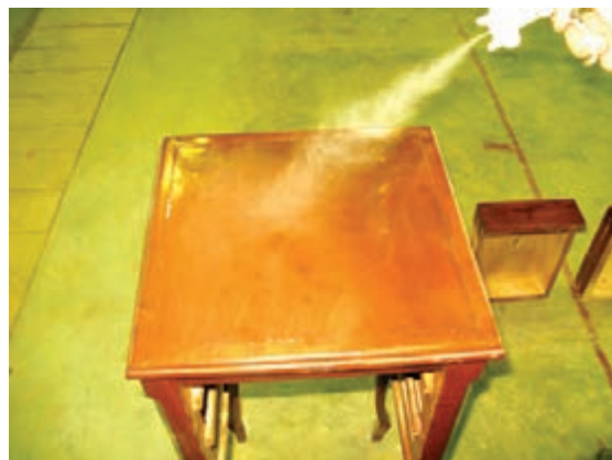
شکل ۵-۱۲- پاشیدن رنگ نیتروسولولوزی با پیستوله.
