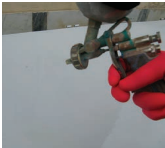
شکل ۱۵-۱۱- استفاده از دستکش هنگام کار با رنگ‌های پوششی.
