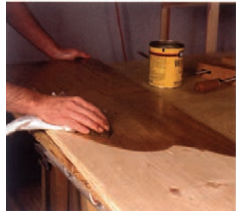
شکل ۱-۱۰- (روغن اندود کردن سطح کار).
