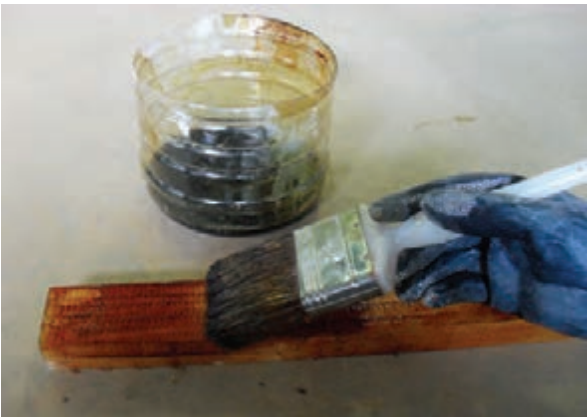
شکل ۵۲-۱۲- زدن استری فندقی (روی سطح کار) با قلم‌مو.
