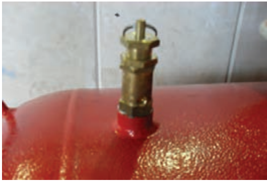
شکل ۱۰-۷- سوپاپ کمپرسور برای فروغ هوای اضافی.
