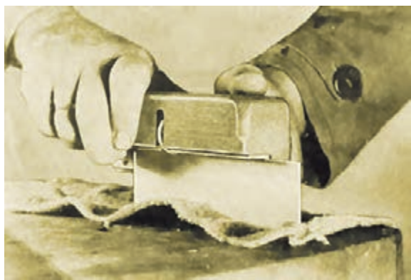
شکل ۳-۴۵- مصقل‌کشی نر لیس با رنده مصقل.
