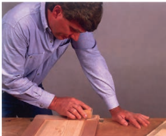
شکل ۱۲-۳۸- زدن آستری گردویی به سطح کار.
