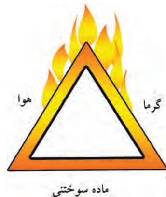
شکل ۲۸-۱- فاکتورهای مهم در شکل‌گیری آتش.
