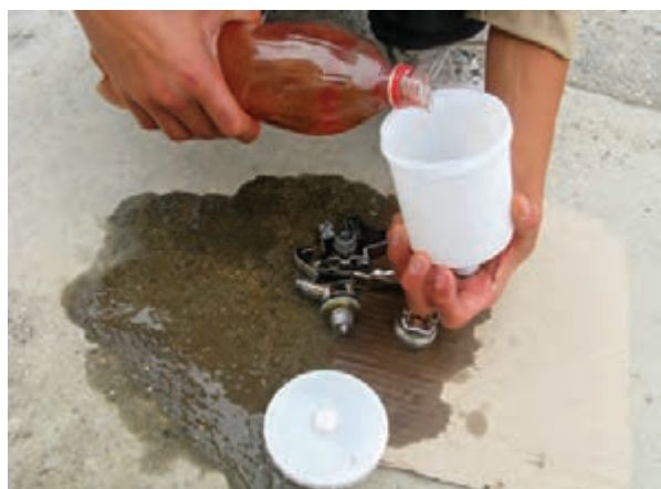
شکل ۳۰-۱۱- شستن پیستوله با تینر.
