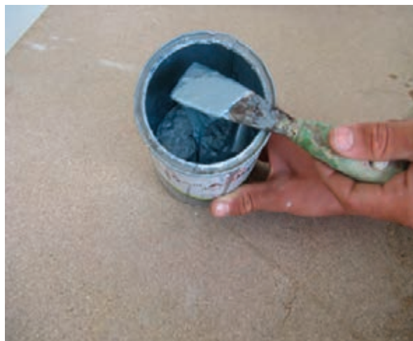
شکل ۱۳-۱۱- ترکیب اکلیل با رنگ روغنی.
