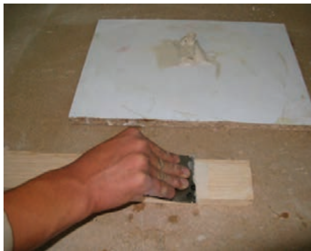
شکل ۵۹-۱۳- زدن بتونه هم‌رنگی به چوب نراد.
