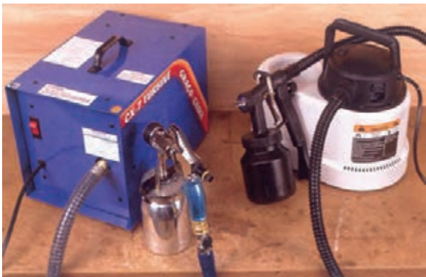
شکل ۷-۴- دو نوع کمپرسور قابل حمل و سبک.
