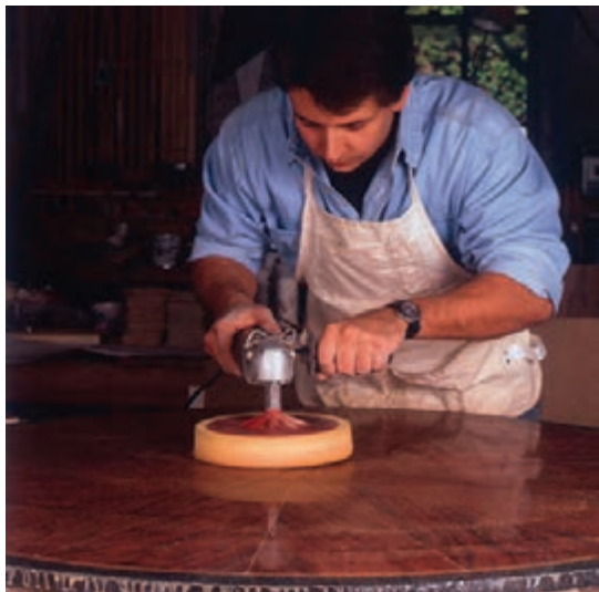
شکل ۱۲-۲۴- پودیش‌کاری سطح پلی استر فورده.
