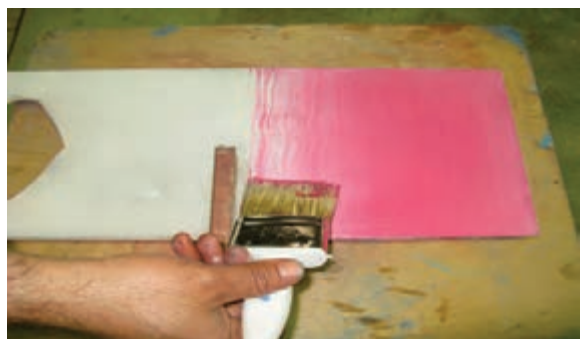
شکل ۷-۱۱- زدن رنگ روغنی به کار با قلم‌مو.
