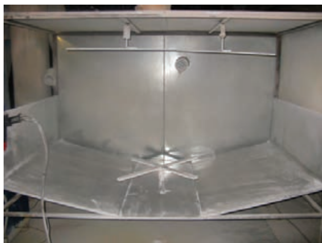
شکل ۳-۹- یک آبشار رنگ با اسکلت فلزی.
