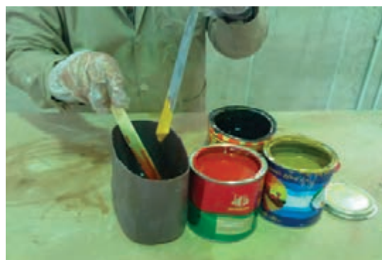
شکل ۶۲-۱۲- هم‌رنگی فوری ساخته شده از رنگ‌های فوری و کیلر فوری.
