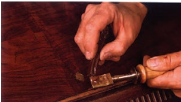
شکل ۶-۳۱- بتونه مومی را به کمک مغار به فلل و فرج چوب وارد می‌کنند.
