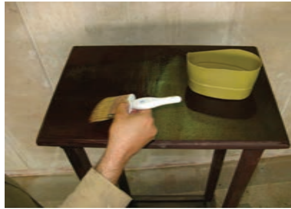
شکل ۹-۱۲- زدن سیلر با قلم‌مو روی سطح آسترفورده.
