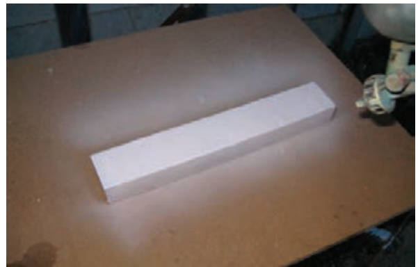
شکل ۲۴-۱۱- پاشیدن رنگ فوری با پیستوله.
