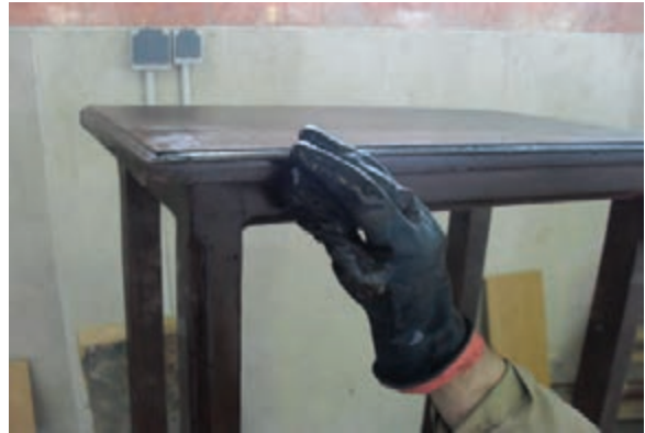
شکل ۴۹-۱۲- آسترکاری یک کار قبل از سیلرکاری.
