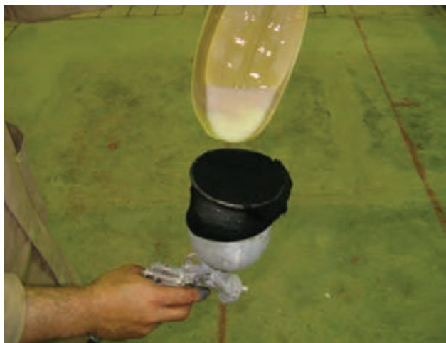
شکل ۳۹-۸- استفاده از جوراب نازک به عنوان صافی.
