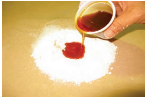
شکل ۶-۵۲- استفاده از روغن الیف به جای روغن اسکاتیف.
