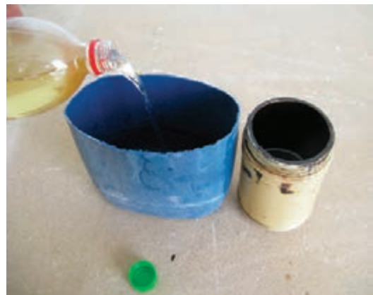
شکل ۶۳-۱۳- مل کردن آستری شاپان با نفت.
