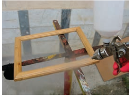
شکل ۱۸-۱۲- (زدن نیم پلی استر با پیستوله).
