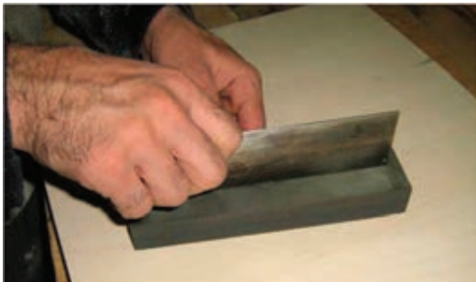
شکل ۱۱-۳- کشیدن لیسه روی سنگ نفت.
