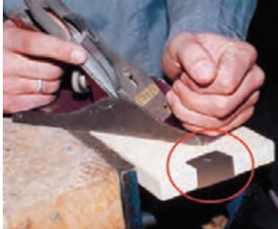
شکل ۳-۳- اتمام برافورده رنده با میخ و یا اشیا فلزی.
