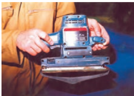
شکل ۵-۴۴- گیره نگهدارنده بایستی سالم باشد، در غیر اینصورت سنباده شل می‌شود.
