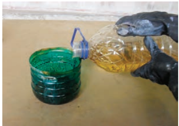
شکل ۵۰-۱۲- (رقیق‌کردن استری روغنی سبز با تینر روغنی).
