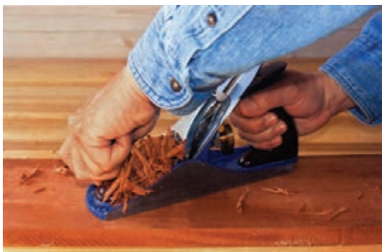
شکل ۷-۱۳- پرداخت‌کاری با رنده دستی.
