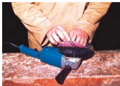
شکل ۵-۳۰- نمونه چسباندن سنباده به صفحه ی دستگاه.
