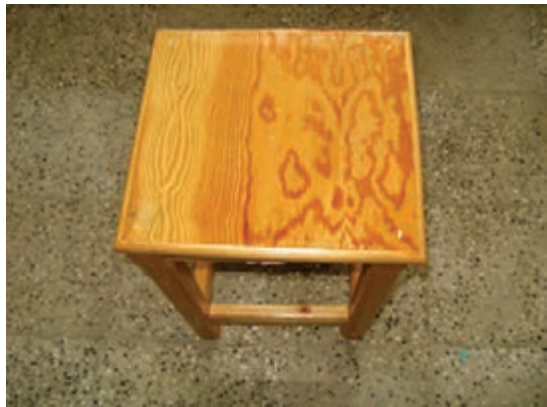
شکل ۳-۱۲- اثر بتونه روی صفحه چهارپایه کاملا نمایان است.
