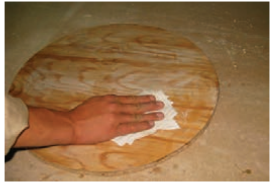
شکل ۶۲-۱۳- گرفتن گرد و غبار از سطح کار.
