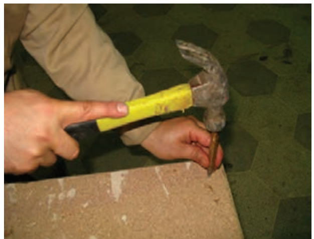
شکل ۱۷-۱۱- سنبه‌کردن میخ در یک کار پوششی.
