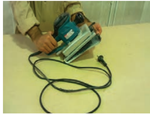
شکل ۱۸-۵- نمونه تعویض ورق سنباده لرزان.
