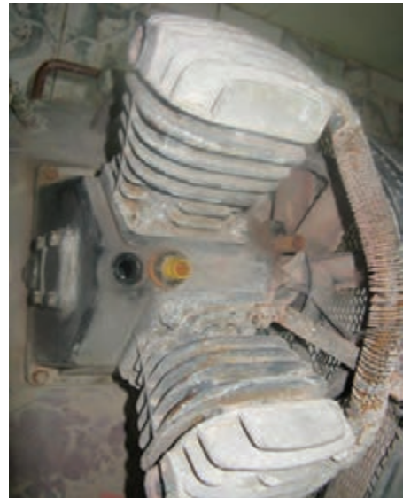
شکل ۸-۷- مخزن روغن یک کمپرسور دو سیلندر.
