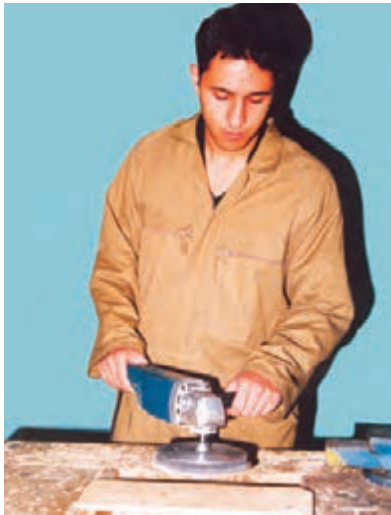
شکل ۵-۳۱- فشار یکنواخت به سطح کار.
