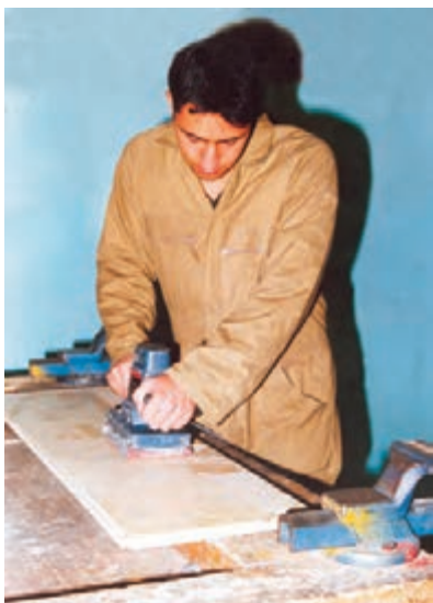
شکل ۵-۴۳- سنباده‌کاری در جهت الیاف.
