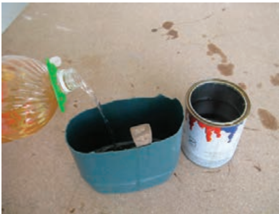
شکل ۶۶-۱۳- اضافه نمودن تینر روغنی به روغن جلا.
