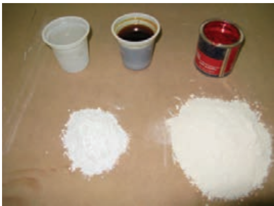
شکل ۲۲-۶- مواد تشکیل دهنده بتونه روغنی.
