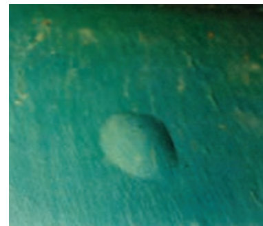
شکل ۸-۴۴- تاول زدگی سطح کار بعد از رنگ.
