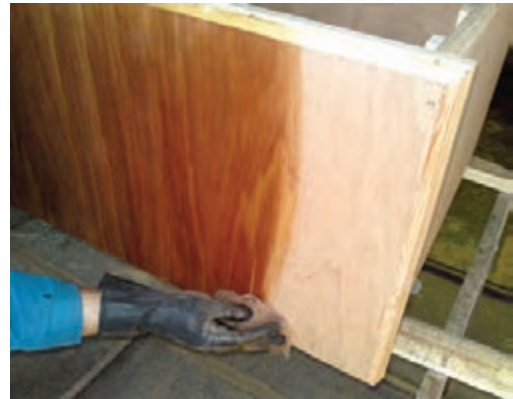
شکل ۳۱-۸- زدن آستری هم‌رنگی از پای به بالا.
