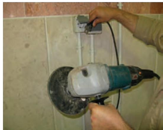
شکل ۲۰-۱۳- کشیدن دوشافه ماشین پوست گرد از پریش.
