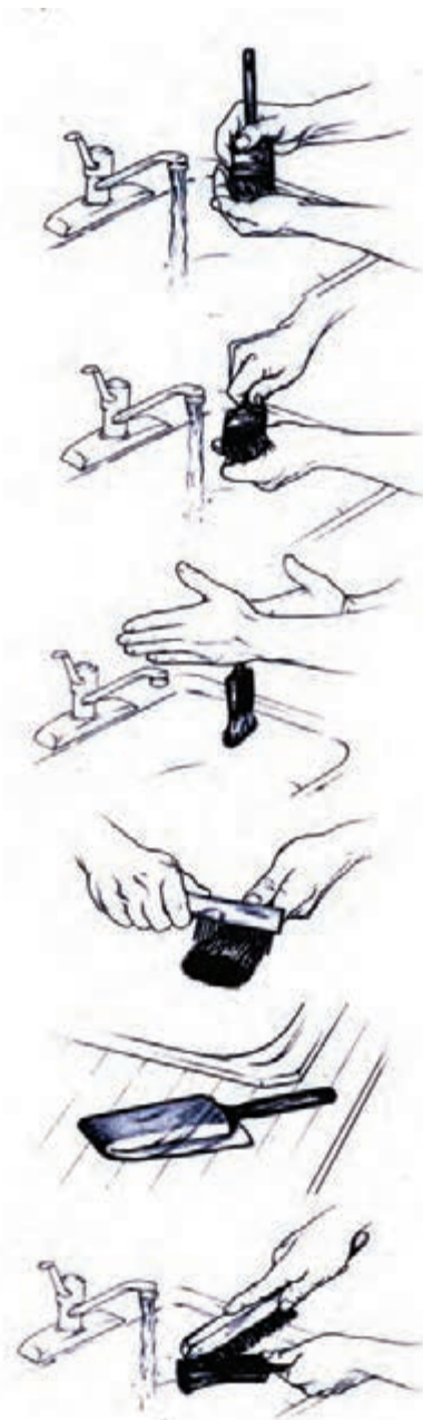
شکل ۱۴-۸- روش شستن و خشک کردن قلم موها.
