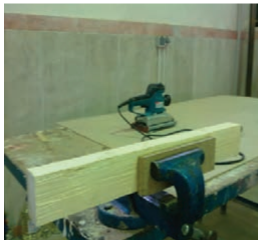
شکل ۵-۴۱- بستن قطعه کار به گیره میزکار با استفاده از چوب کمکی.
