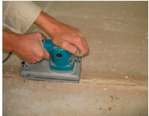
شکل ۲۷-۱۳- سنباده‌کاری یک قطعه چوب راش با ماشین سنباده لِرزان.
