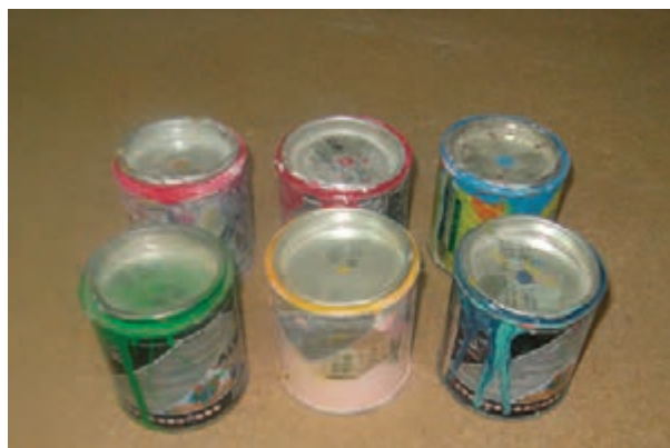
شکل ۵۰-۶- چند نوع رنگ روغنی برای تغییر رنگ دادن بتونه روغنی.
