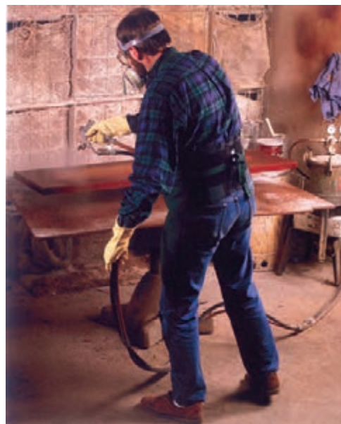
شکل ۱۲-۲۲- پاشیدن پلی استر ایستاده به سطح کار.
